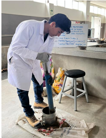
Ilustración 50. Compactación del ensayo Proctor con la adición del SBR
