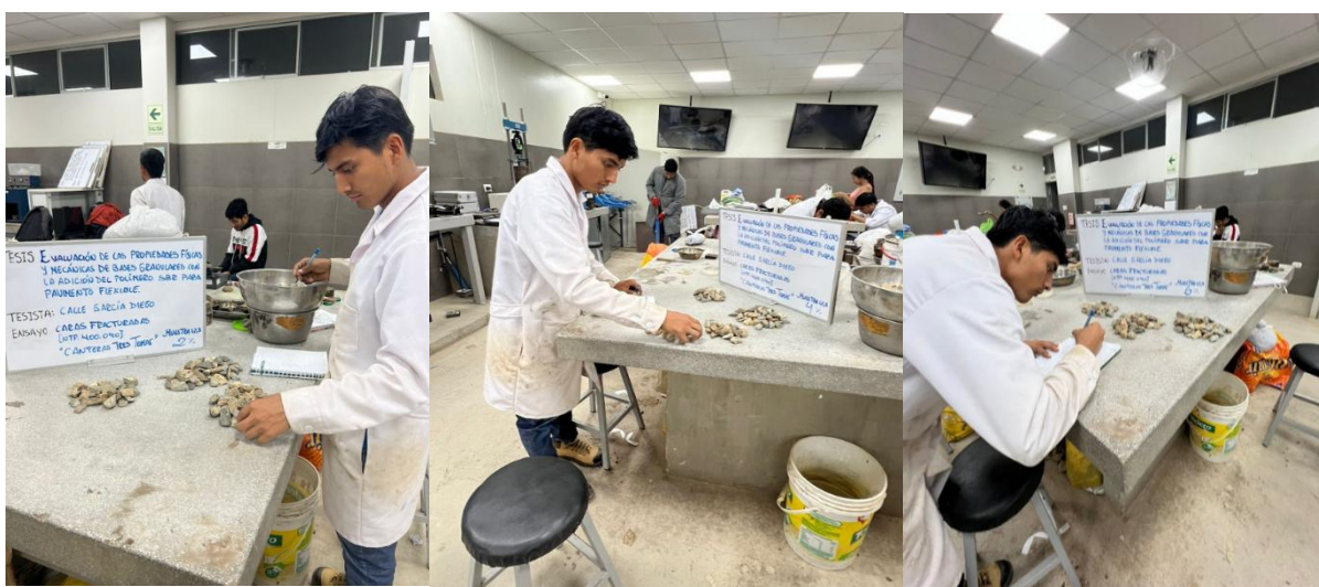
Ilustración 38. Ensayo de Caras fracturadas en cantera 3 tomas con 2%, 4% y 6% de SBR
