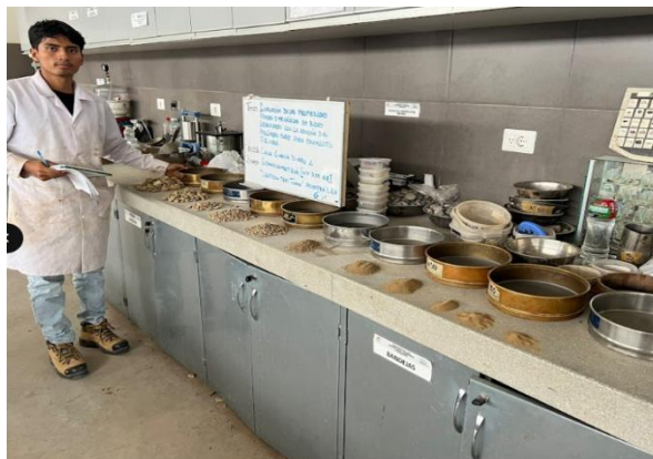
Ilustración 25. Ensayo de granulometría de la cantera 3 tomas con el 6% de SBR
