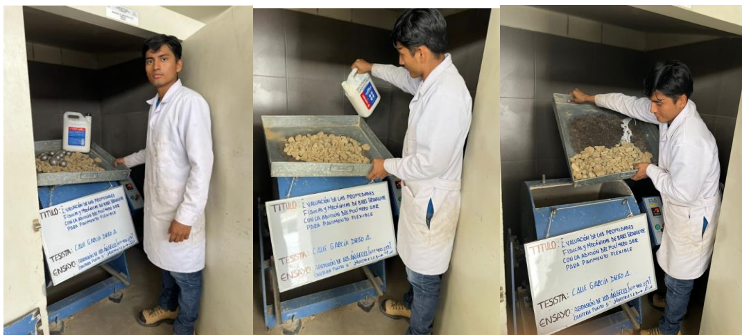
Ilustración 43: Ensayo de Abrasión de los Ángeles, cantera Punto 5 con 2%,4% y 6% de SBR. Equivalente de arena
