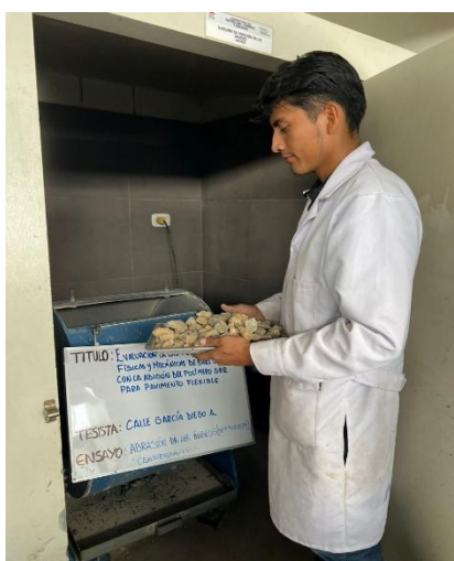
Ilustración 14: Máquina de Abrasión de los Ángeles, cantera Punto 5
