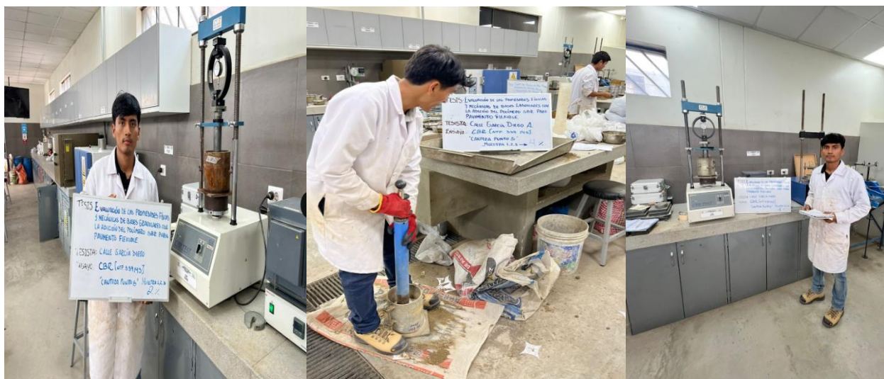
Ilustración 57. Ensayo de CBR en cantera Punto 5 con 2%, 4% y 6% de SBR
