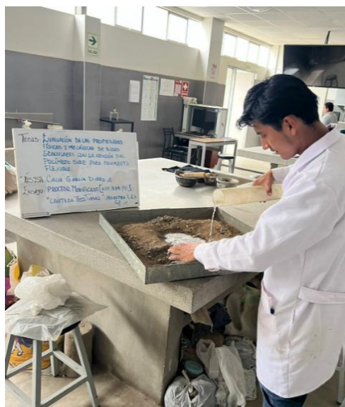
Ilustración 48. Incorporación del aditivo en 2%, 4% y 6% de SBR a la muestra natural
