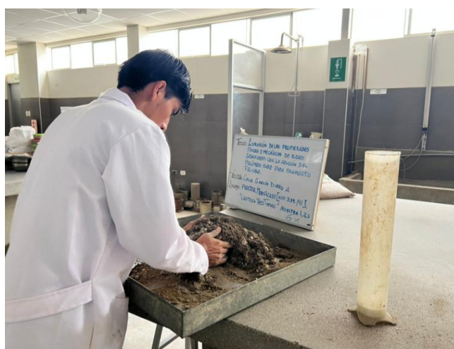
Ilustración 49. Mezclado del aditivo SBR con la muestra natural
