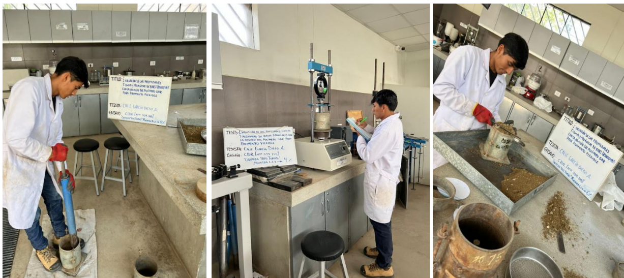
Ilustración 56. Ensayo de CBR en cantera 3 tomas con 2%, 4% y 6% de SBR
