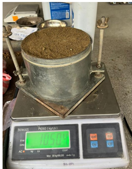
Ilustración 51. Peso después de la compactación con la adición del SBR
