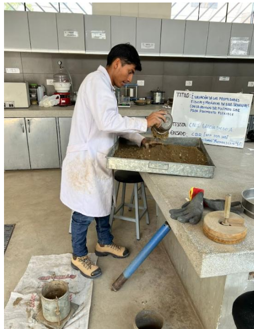
Ilustración 54. Material con la incorporación del SBR del ensayo de CBR
