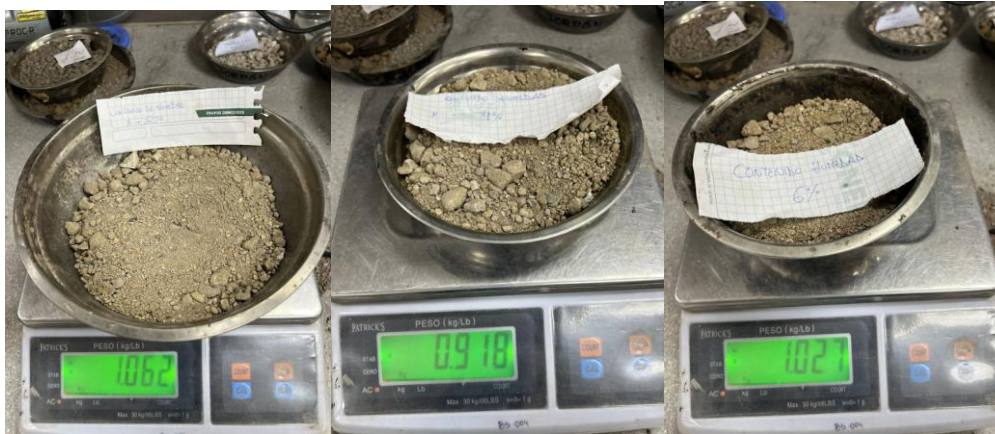
Ilustración 30: Peso de material tres tomas seco con adición 2%,4% y 6% del SBR
