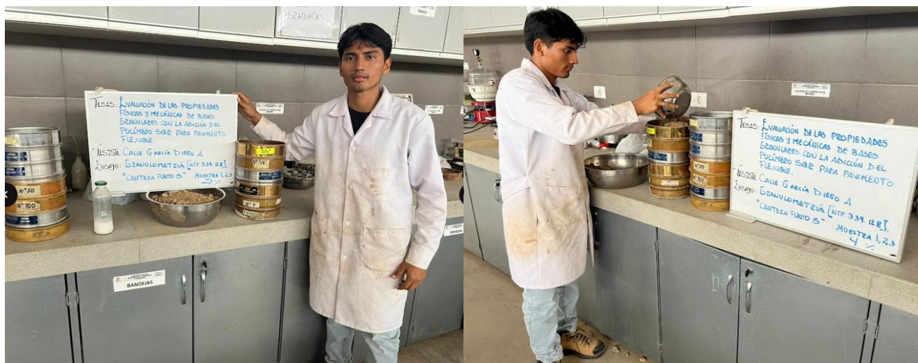
Ilustración 26. Ensayo de granulometría de la cantera Punto 5 con el 2% y 4% de SBR
