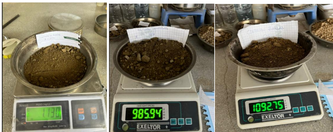
Ilustración 29. Peso del material de la cantera tres tomas con la adición del 2%,4% y 6% del SBR
