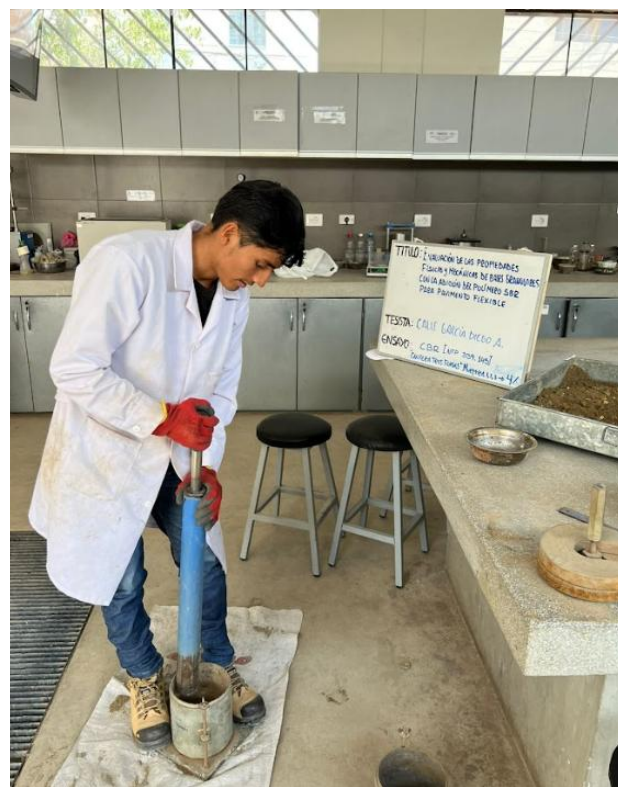
Ilustración 54. Material con la incorporación del SBR del ensayo de CBR
