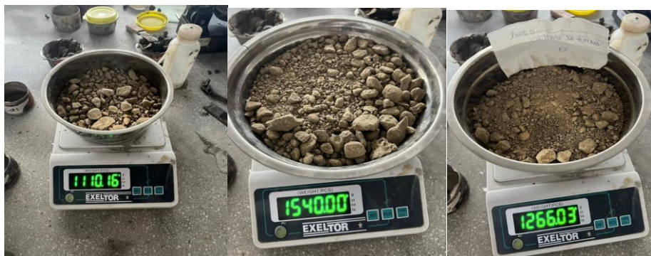
Ilustración 33: Peso de material cantera de PUNTO 5 seco con adición 2%,4% y 6% del SBR
