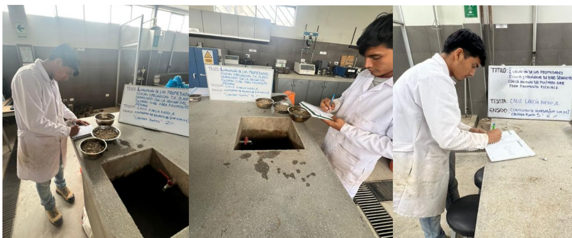
Ilustración 34. Ensayo de contenido de humedad de la cantera Punto 5 con el 2%, 4% y 6% de SBR.
