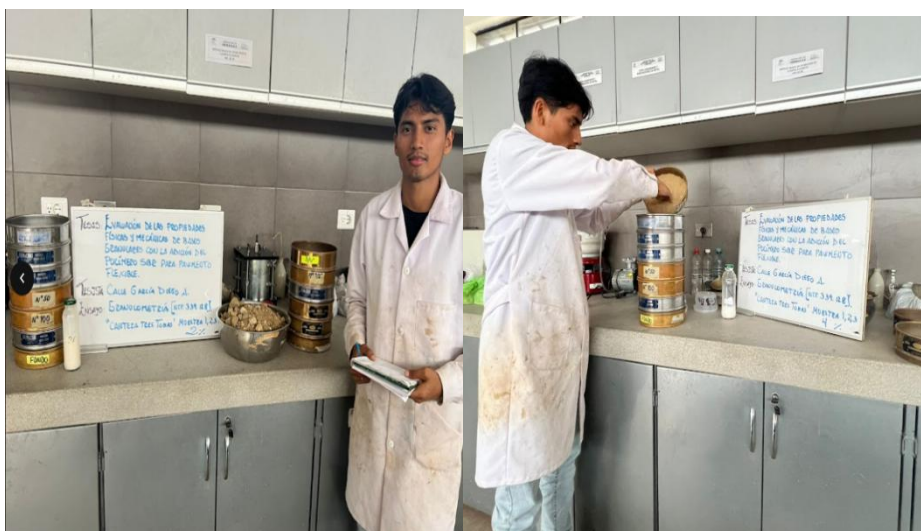
Ilustración 24. Ensayo de granulometría de la cantera 3 tomas con el 2% y 4% de SBR
