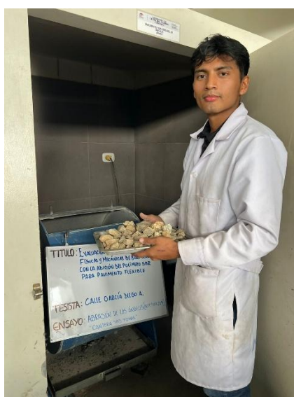
Ilustración 15: Máquina de Abrasión de los Ángeles, cantera Tres Tomas
