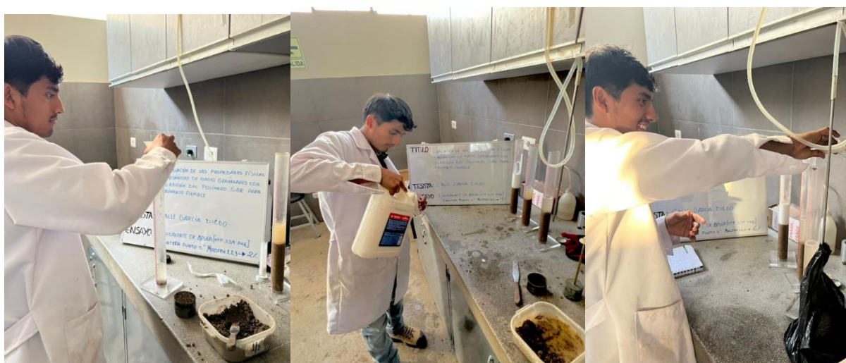
Ilustración 45. Ensayo de Equivalente de arena en cantera Punto 5 con 2%, 4% y 6% de SBR.
