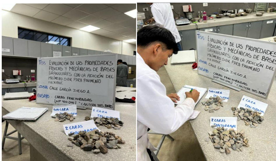
Ilustración 11. Caras fracturadas de cantera tres tomas
