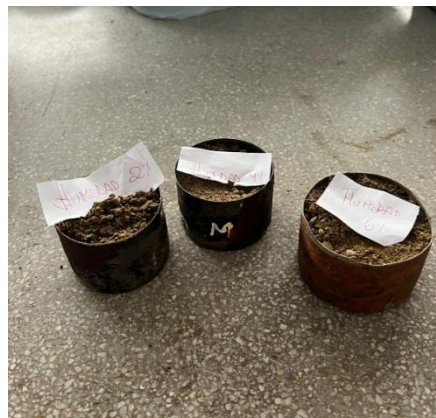
Ilustración 52. Material para determinar la humedad con la adición del SBR
