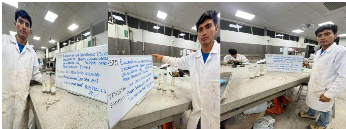
Ilustración 46. Ensayo de Sales solubles en cantera 3 tomas con 2%, 4% y 6% de SBR.
