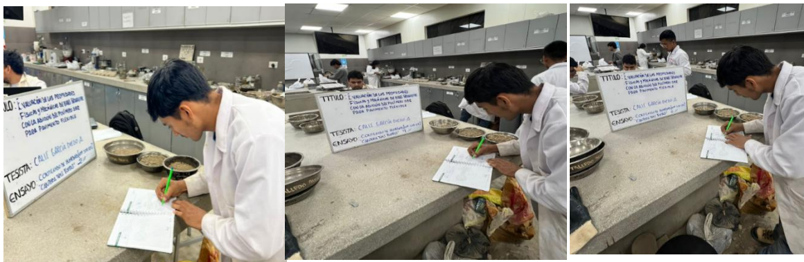
Ilustración 31. Ensayo de contenido de humedad de la cantera 3 tomas con el 2%, 4% y 6% de SBR
