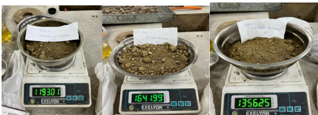
Ilustración 32. Peso del material cantera 5 de la cantera de PUNTO 5 con adición 2%, 4 y 6% del SBR
