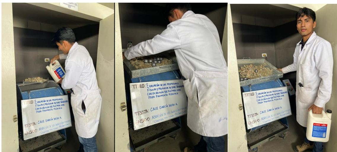
Ilustración 42: Ensayo de Abrasión de los Ángeles, cantera Tres Tomas con 2%,4% y 6% de SBR.
