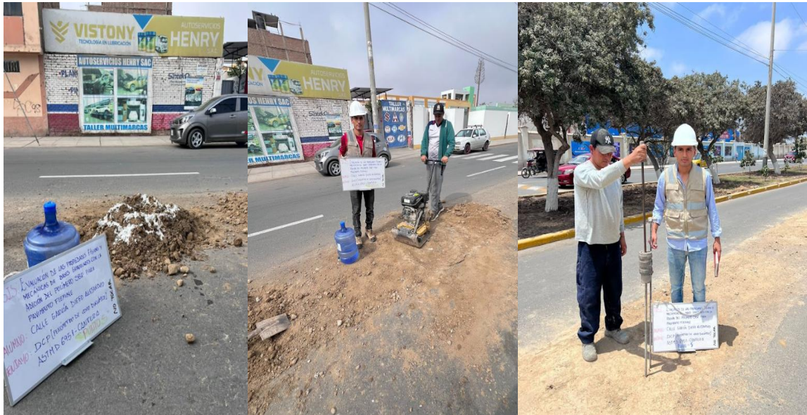
Ilustración 58. Ensayo DCP con el 4% de SBR + Material de Cantera Punto 5
