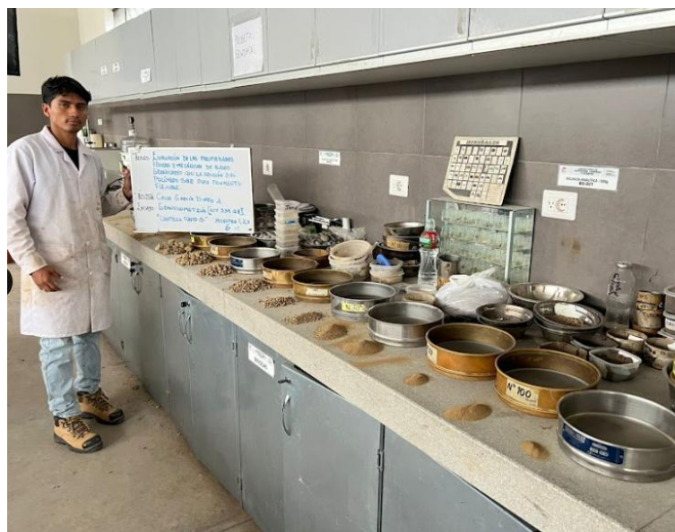
Ilustración 27. Ensayo de granulometría de la cantera Punto 5 con el 6% de SBR
