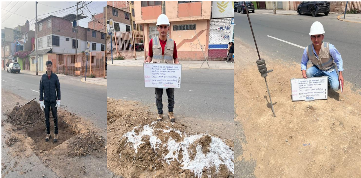
Ilustración 59. Ensayo DCP con el 4% de SBR + Material de Cantera Tres Tomas
