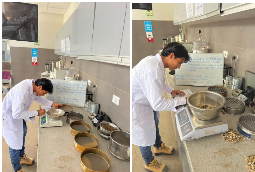
Ilustración 7. Granulometría de cantera del PUNTO 5
