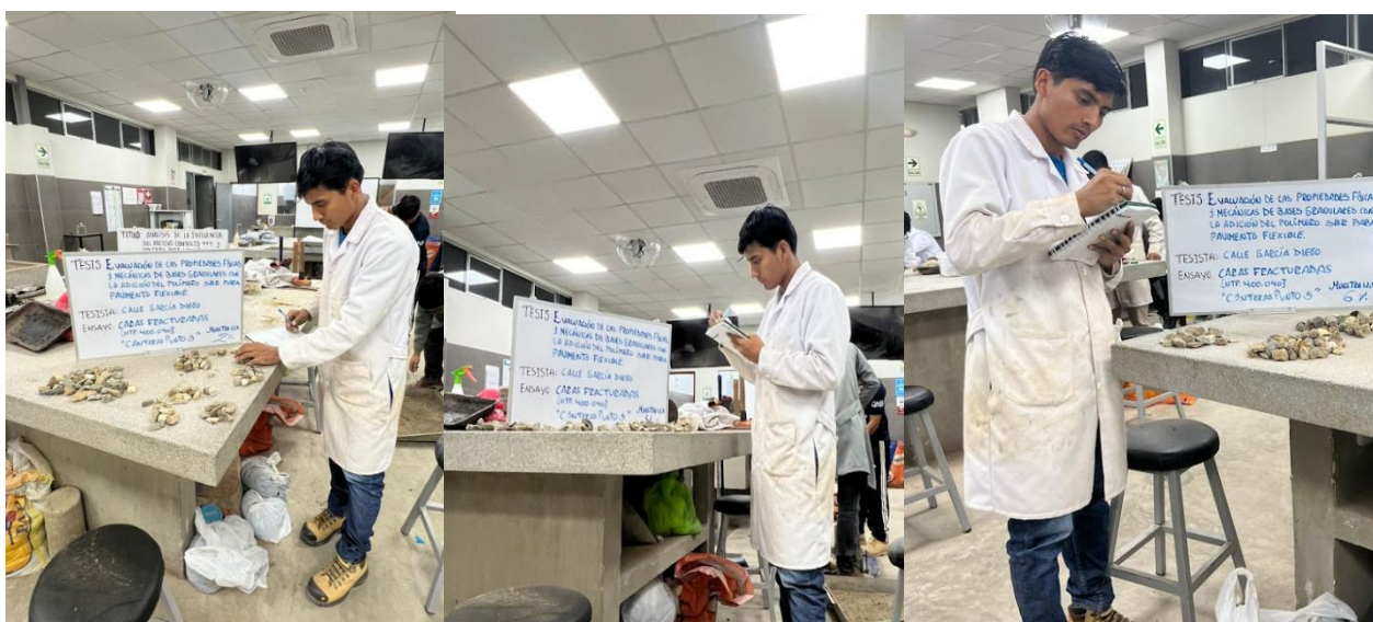
Ilustración 39. Ensayo de Caras fracturadas en cantera Punto 5 con 2%, 4% y 6% de SBR.
