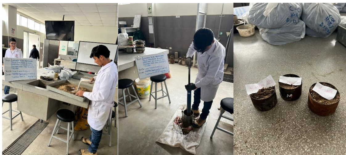
Ilustración 53: Ensayo de Proctor Modificado en cantera Punto 5 con 2%, 4% y 6% de SBR
