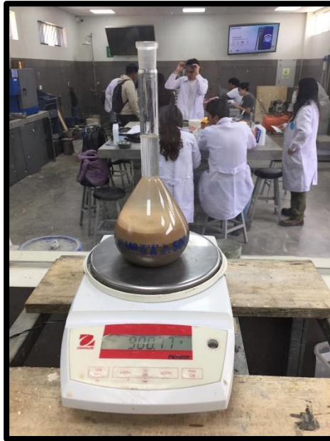
Fig. 14: Peso muestra del agregado fino + Agua + fiola
