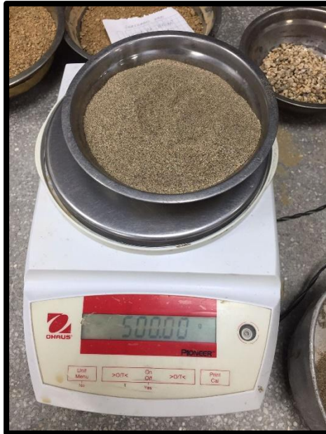
Fig. 12: Peso de la muestra del agregado fino saturada seca Fuente: Propia
