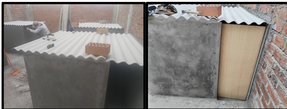
Fig. 30: Módulos tarrajeados con mortero patrón y con mortero con lana de vidrio al 5%, 10% y 15%
