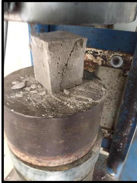
Fig. 21: Cubo de mortero fallado tras carga Fuente: Propia
