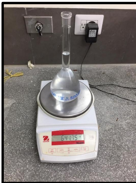
Fig. 13: Peso fiola + Agua destilada Fuente: Propia
