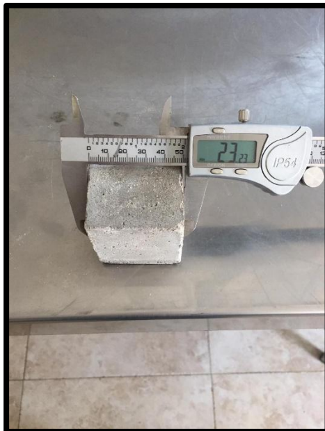
Fig. 19: Medición promedio de cubos de mortero
