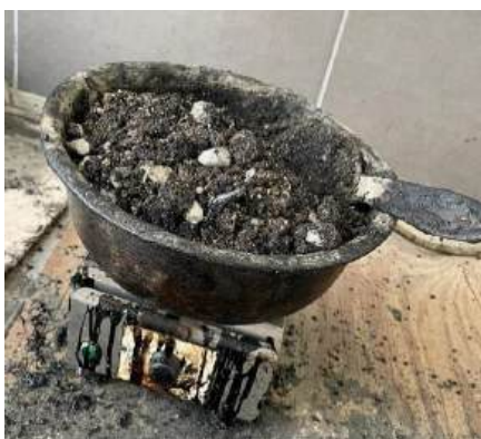
FIGURA 47 Muestra sometida a alta temperatura – 5% de vidrio y 30% ACR – Trafico Ligero
