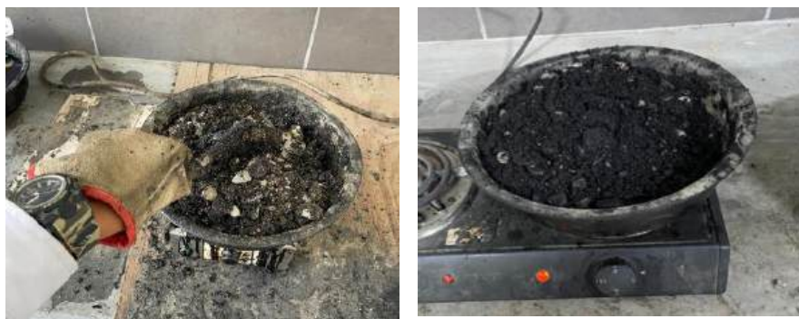
FIGURA 55 Mezcla en Caliente – 5% de vidrio y 30% ACR – Tráfico Pesado
