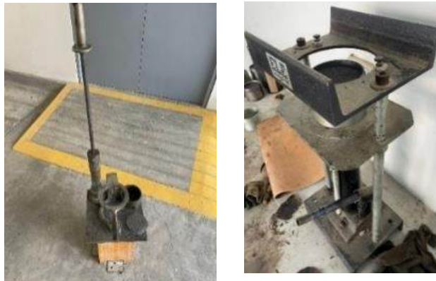
FIGURA 50 Desencofrado de Briqueta – 5% de vidrio y 30% ACR – Trafico Ligero
