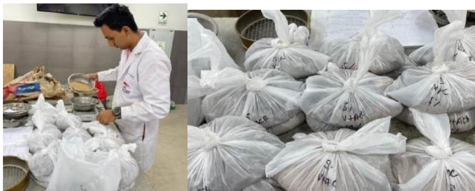
FIGURA 53 Pesado del agregado fino y grueso más 5% de vidrio y 30% de ACR para la mezcla – Tráfico Pesado
