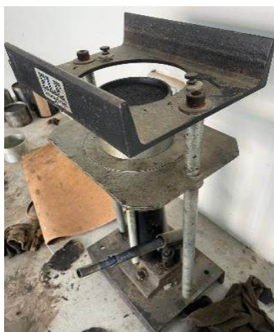
FIGURA 43 Desencofrado de Briqueta – Tráfico Pesado
