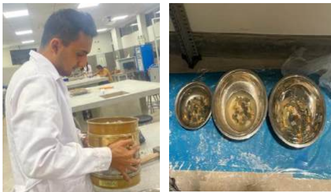
FIGURA 22 Ensayo de Durabilidad (sulfato de magnesio) del A. Grueso y ACR Fuente: Elaboración Propia.
