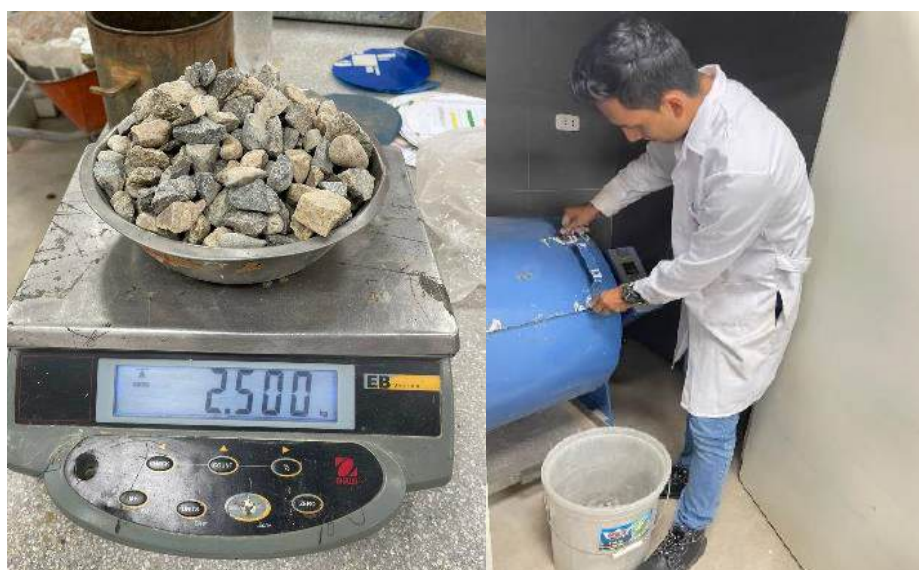
FIGURA 19 Ensayo Abrasión máquina de los ángeles del A. Grueso y ACR.
