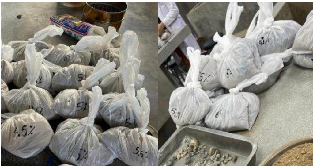
FIGURA 37 Pesado del agregado fino y grueso para la mezcla – Tráfico Pesado
