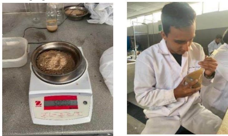
FIGURA 23 Ensayo peso específico y absorción de A. Fino y Vidrio Triturado Fuente: Elaboración Propia.
