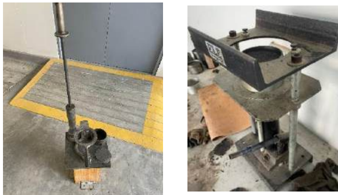
FIGURA 57 Desencofrado de Briqueta – 5% de vidrio y 30% ACR – Tráfico Pesado
