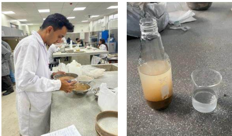
FIGURA 26 Ensayo de Contenido de Sales del A. Fino y Vidrio Triturado.
