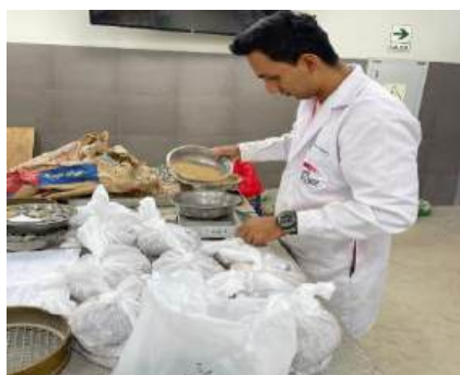
FIGURA 45 Pesado del agregado fino y grueso más 5% de vidrio y 30% de ACR para la mezcla – Tráfico Ligero
