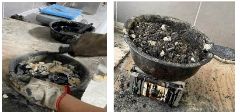
FIGURA 54 Muestra sometida a alta temperatura – 5% de vidrio y 30% ACR – Tráfico Pesado
