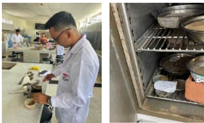
FIGURA 25 Ensayo de Índice de Plasticidad. A. Fino y Vidrio Triturado.
