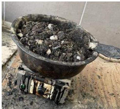
FIGURA 31 Muestra sometida a alta temperatura – Tráfico Ligero
