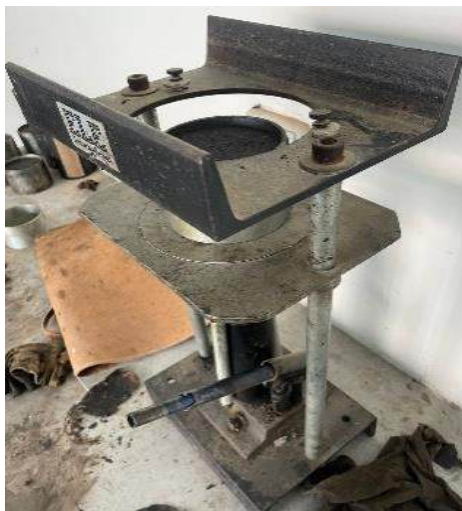
FIGURA 35 Desencofrado de Briqueta – Tráfico Ligero
