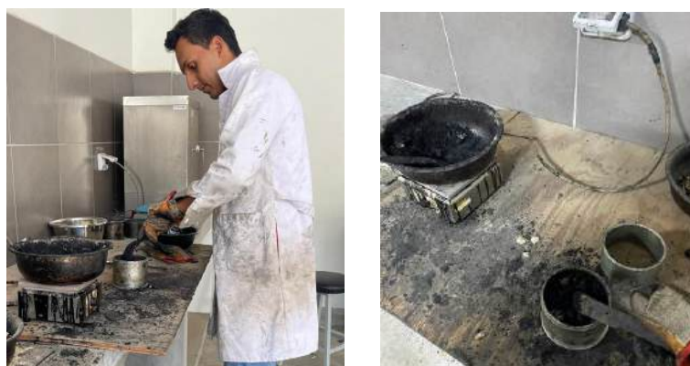
FIGURA 56 Mezcla en el molde – 5% de vidrio y 30% ACR – Tráfico Pesado
