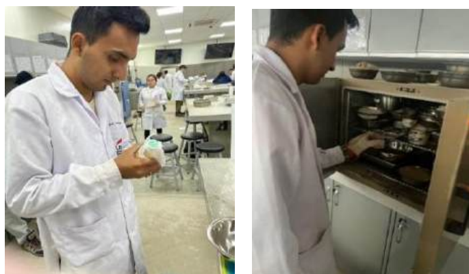
FIGURA 21 Ensayo de Contenido de Sales del A. Grueso y ACR.
