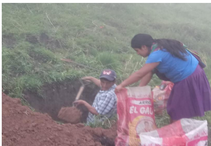
Figura N° 10: Excavación para extraer muestras de suelos
