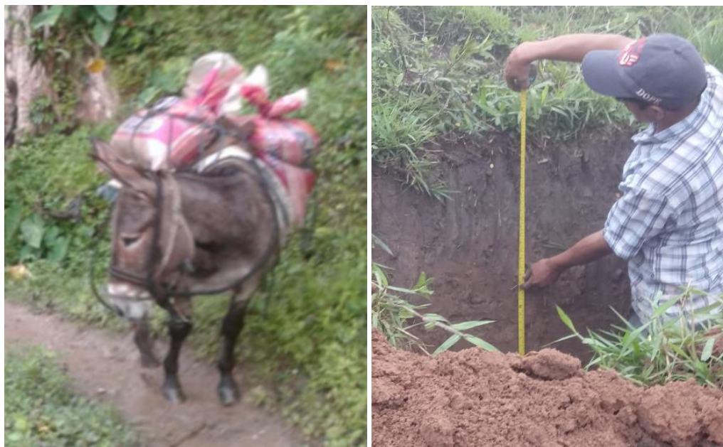
Figura N° 11: Acarreo de muestra de suelos extraídas de cada calicata
