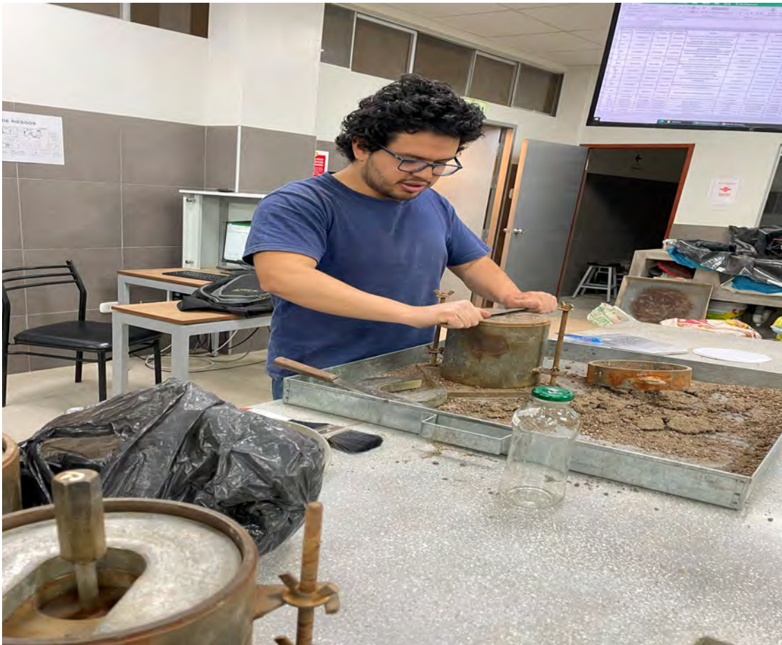
Proceso de enrasado de las muestras en el ensayo de CBR para el suelo patrón
