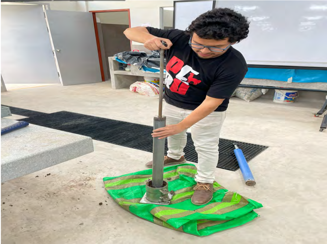
Compactado del suelo arcilloso con el contenido de agua haciendo uso de energía modificada para la realización del ensayo de Proctor modificado por el método A
