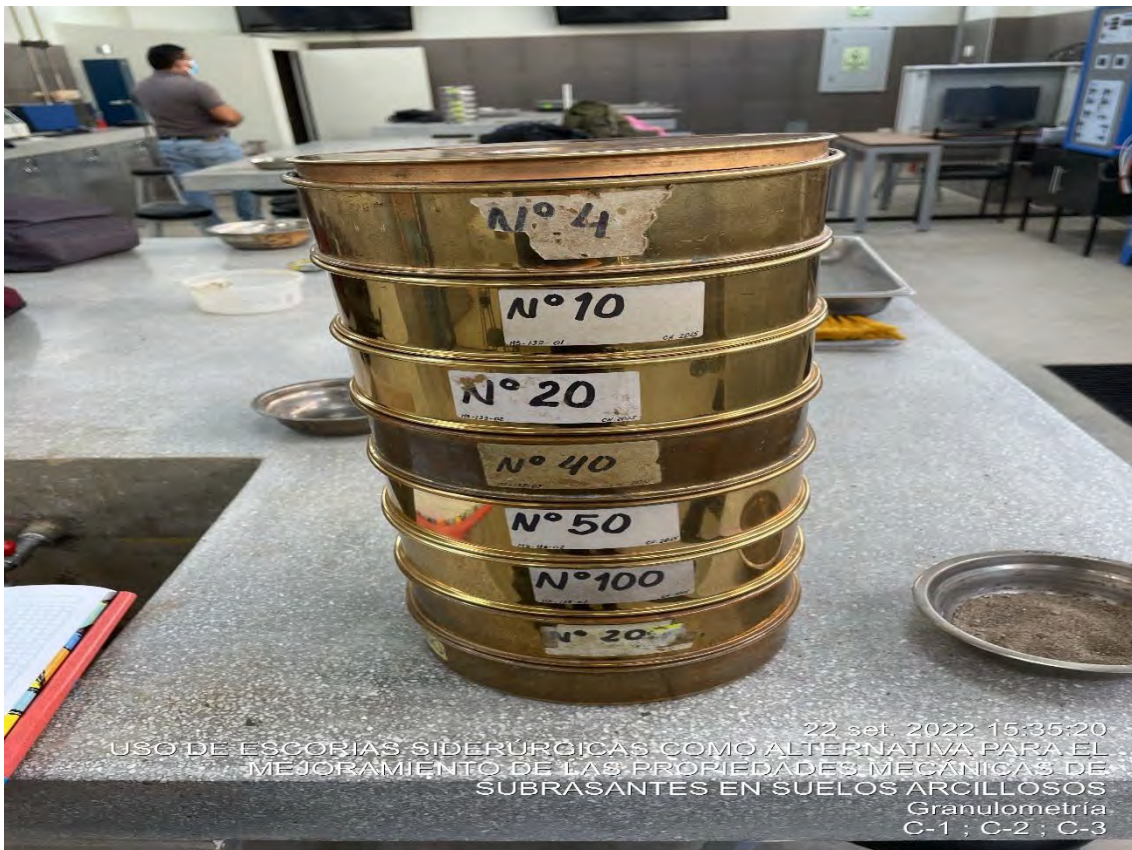
Tamices empleados para realizar el análisis granulométrico de la muestra de suelos arcillosos de las 3 calicatas
