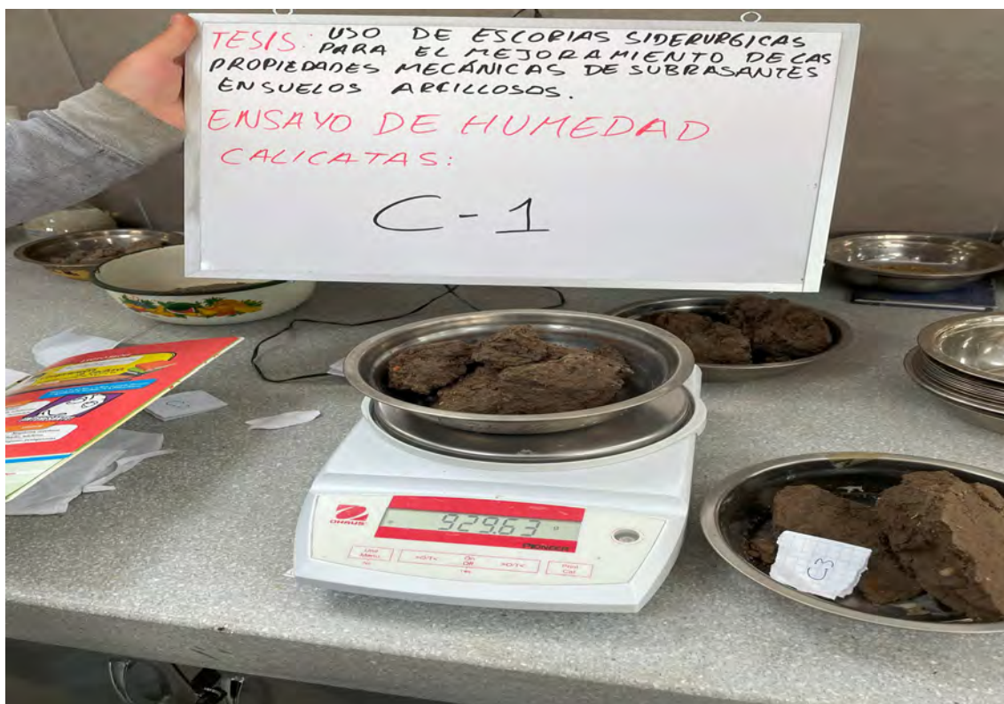
Peso de la muestra de la calicata C-1 para determinar el contenido de humedad
