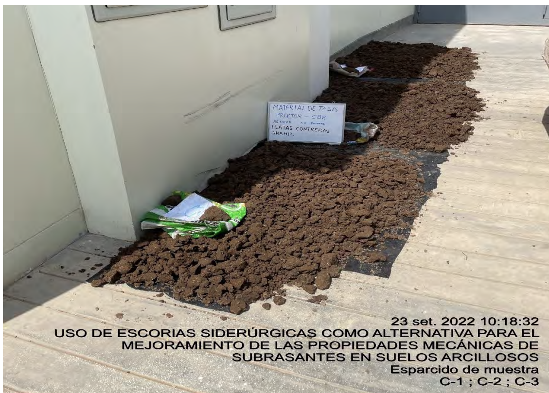
Extendido de las muestras de suelo de las Calicatas C-1, C-2 y C-3 para el secado correspondiente
