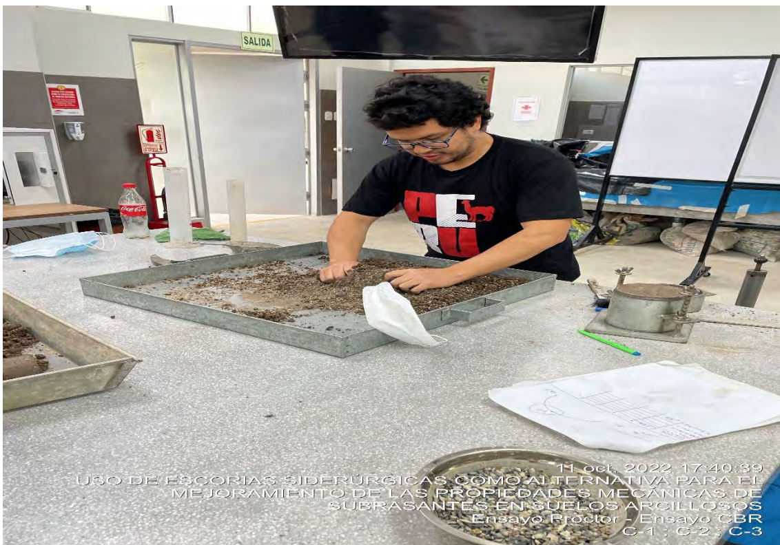
Homogeneización del suelo arcilloso con el contenido de agua para la realización del ensayo de Proctor Modificado por el método A
