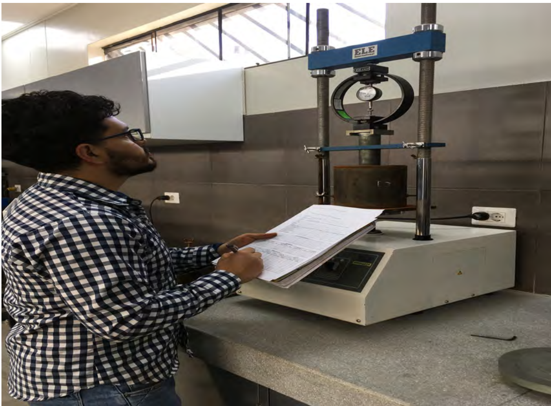
Proceso de penetración a las muestras de la C-1, C-2 y C-3 como fase final para determinar el valor de CBR de las muestras con adición de Escorias EAF en sus diferentes porcentajes
