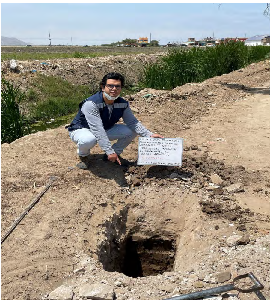
Fotografía 1. Toma de muestras del suelo arcilloso
