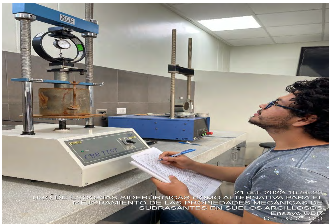
Proceso de penetración a las muestras de la C-1, C-2 y C-3 como fase final para determinar el valor de CBR
