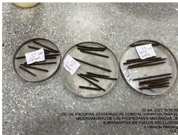
Fotografía 6. Barras de 3.2 mm de espesor para determinar el límite plástico de las muestras de suelo arcilloso
