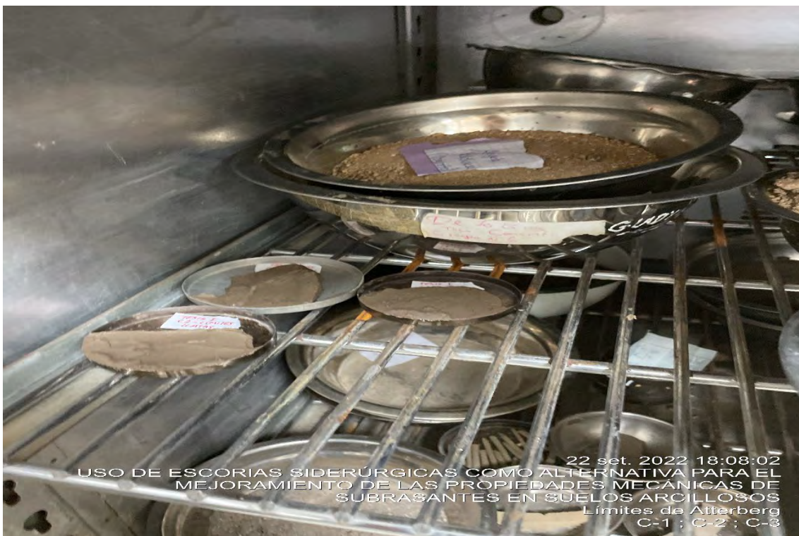
Secado al horno de los especímenes correspondientes a la C-1, C-2 y C-3 para determinar el límite líquido mediante el ensayo de copa de Casagrande
