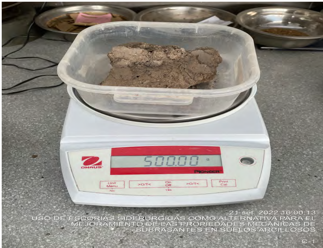
Peso de la muestra de suelo arcilloso de la C-1 que será empleada en los ensayos de límite líquido y límite plástico
