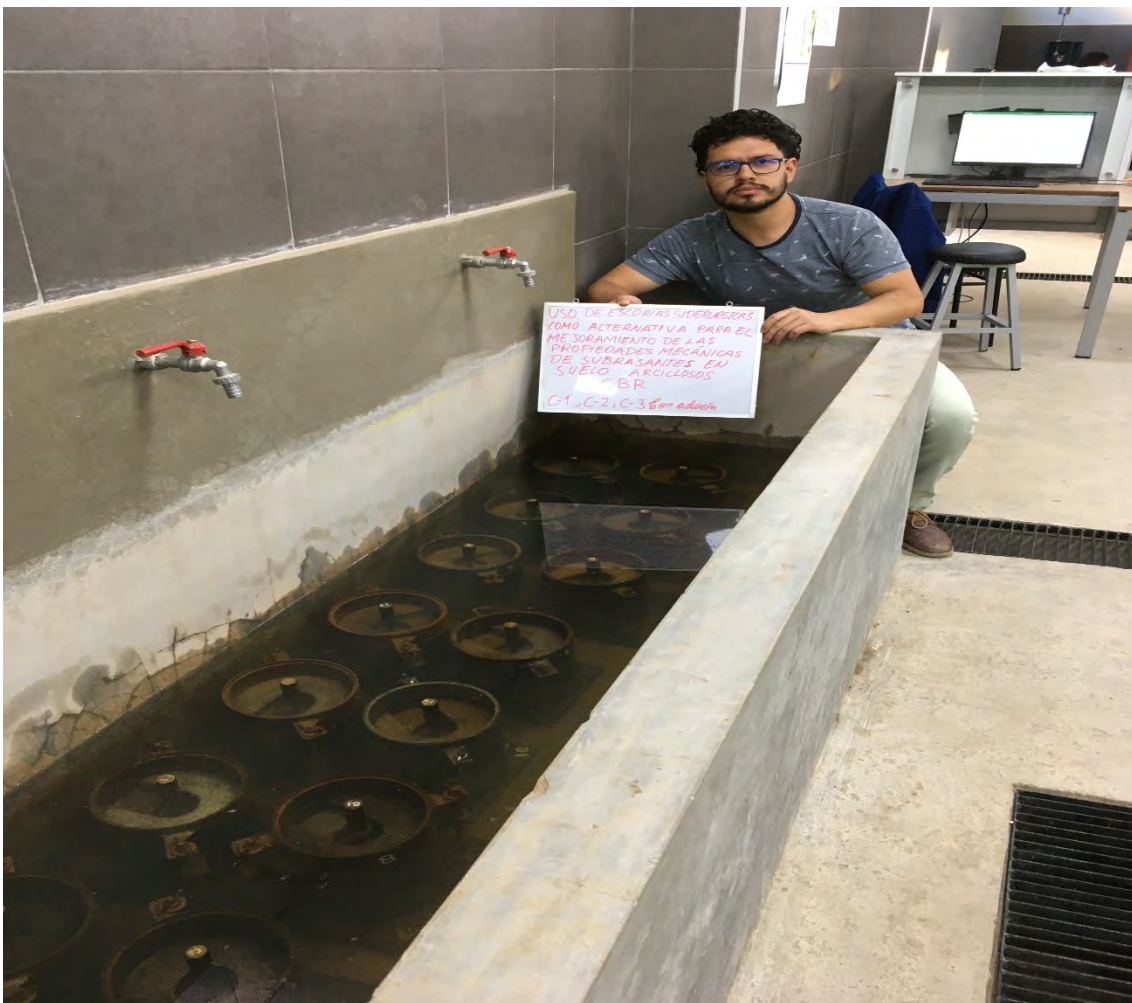
Muestra sumergida en agua por un periodo de 4 días para determinar el valor de CBR de las muestras con adición de Escorias EAF en sus diferentes porcentajes
