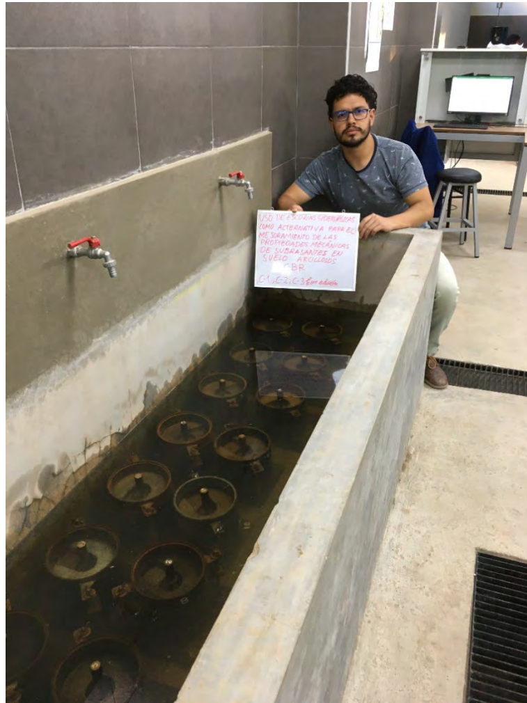
Fotografía 12. Moldes con las muestras de suelos arcillosos sumergidos en su totalidad a un nivel constante por un periodo de 4 días.
