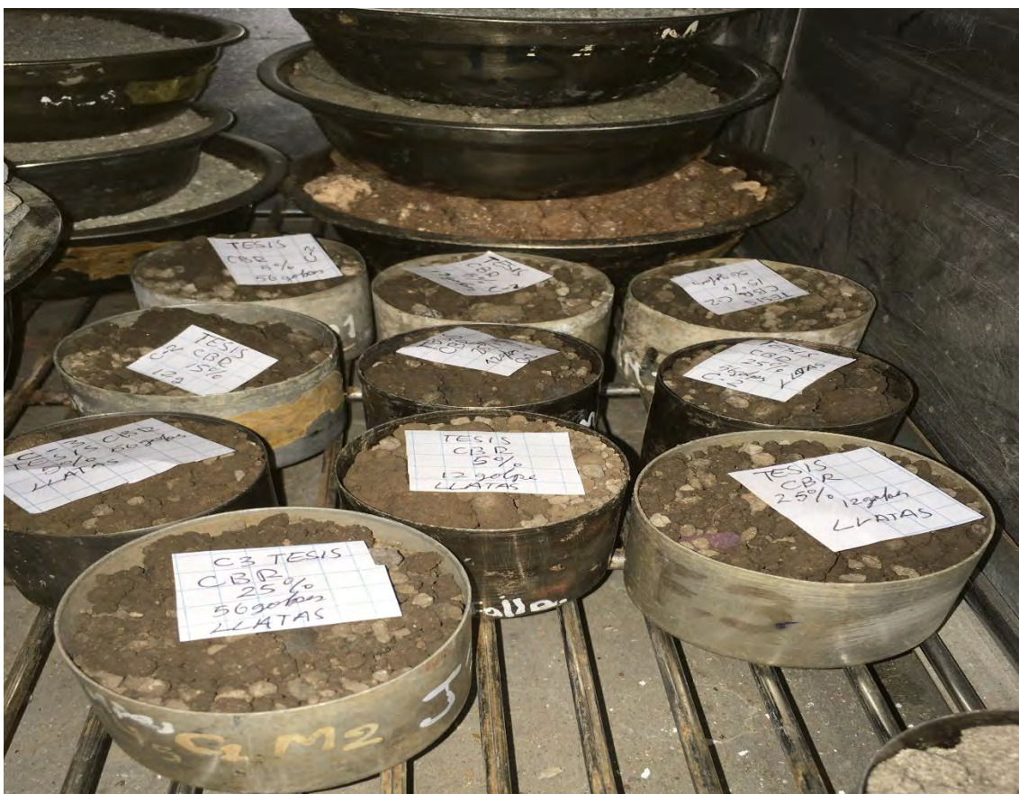
Toma de especímenes para determinar la humedad correspondiente al ensayo de CBR
