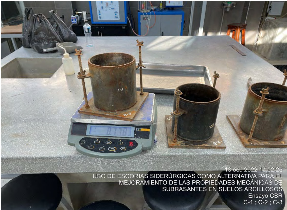
Pesado de los moldes a utilizar en el ensayo de CBR de Suelos
