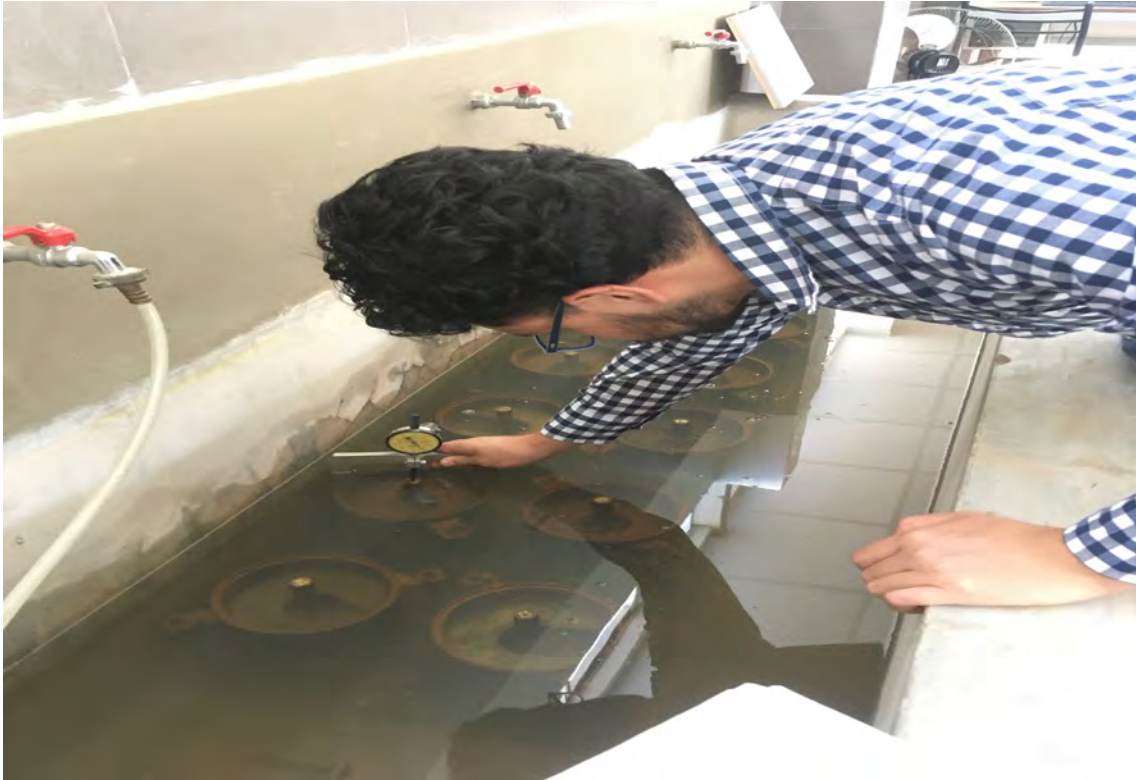
Medición de la expansión por 96 h para determinar el valor de CBR de las muestras con adición de Escorias EAF en sus diferentes porcentajes
