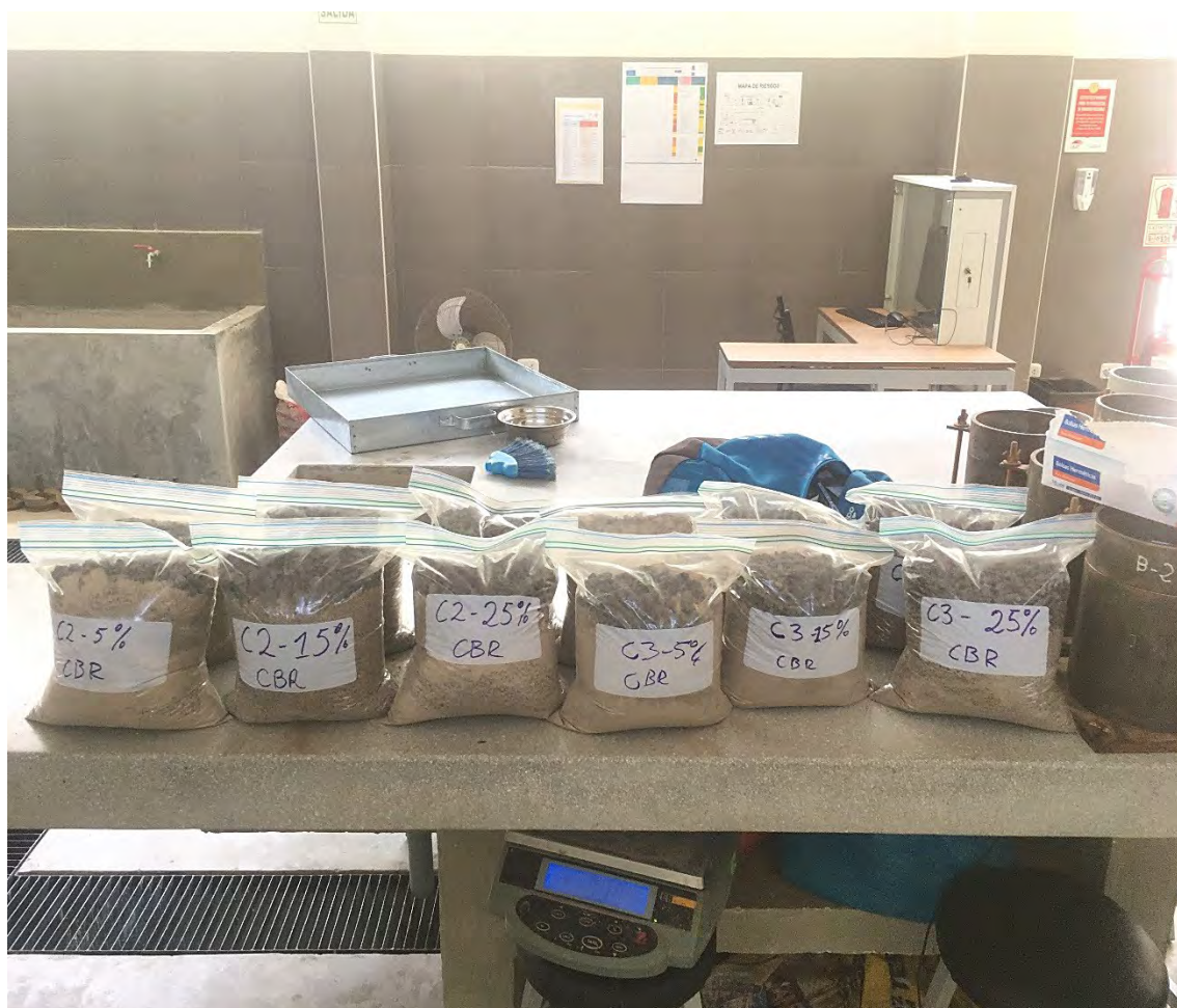
Fotografía 10. Colocación y almacenamiento del suelo arcilloso más las escorias EAF en bolsas herméticas.
