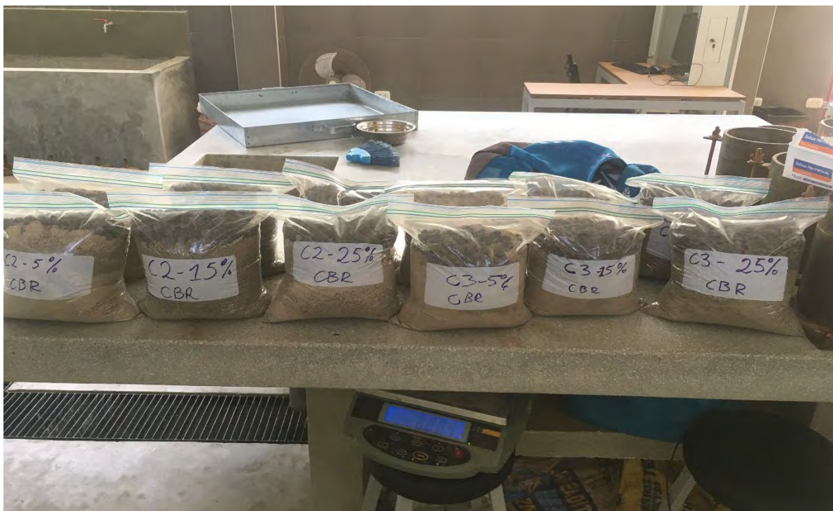
Almacenado con las muestras de suelos arcillosos de las Calicatas C-1, C2 y C-3 con las Escorias EAF en sus diferentes dosificaciones, hasta el momento de utilizar
