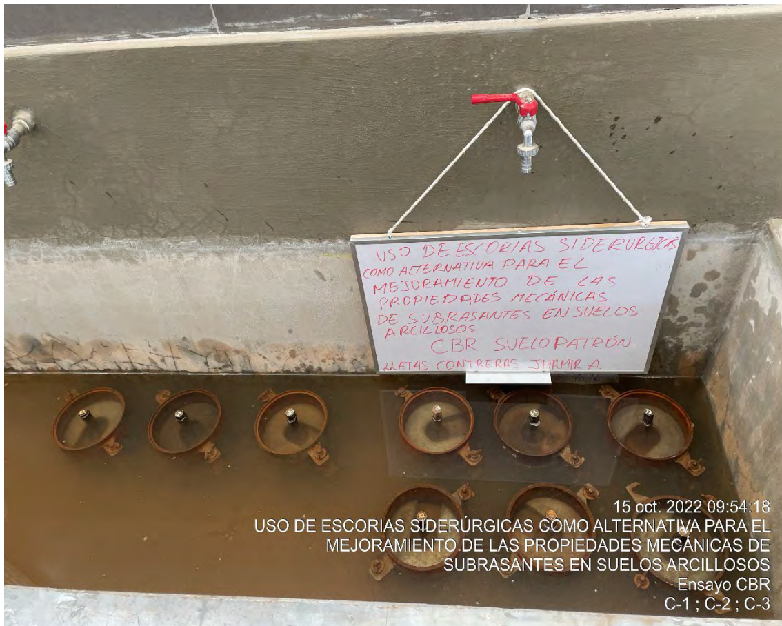
Muestra sumergida en agua por un periodo de 4 a 5 días de la C-1, C-2 y C-3, para posteriormente determinar el valor de CBR
