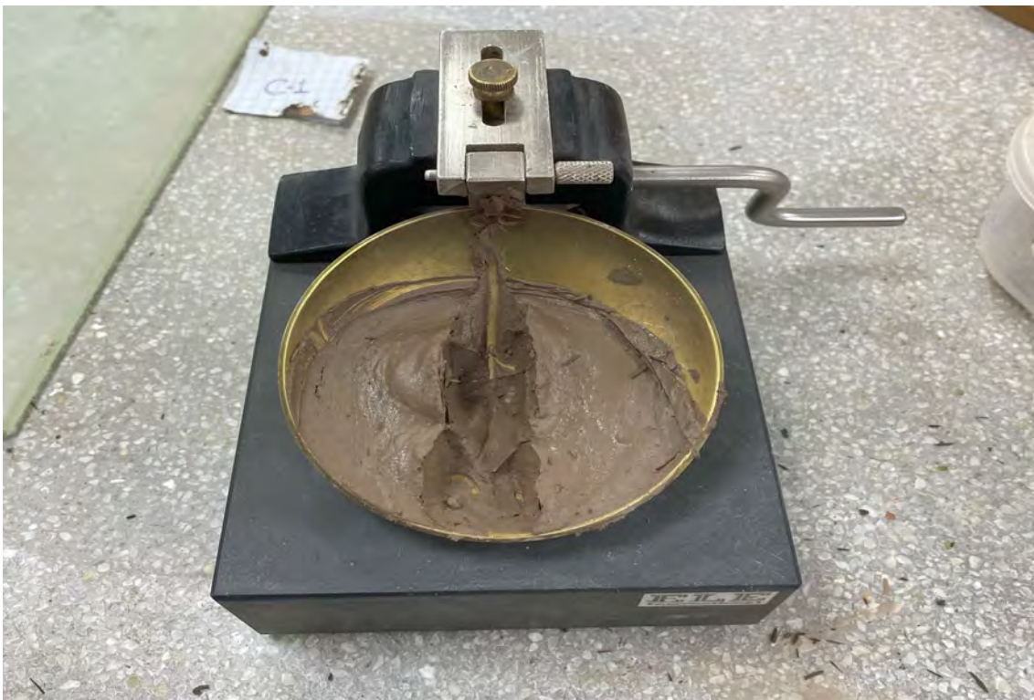
Muestra colocada en la copa de Casagrande y dividida por el acanalador para determinar el límite líquido
