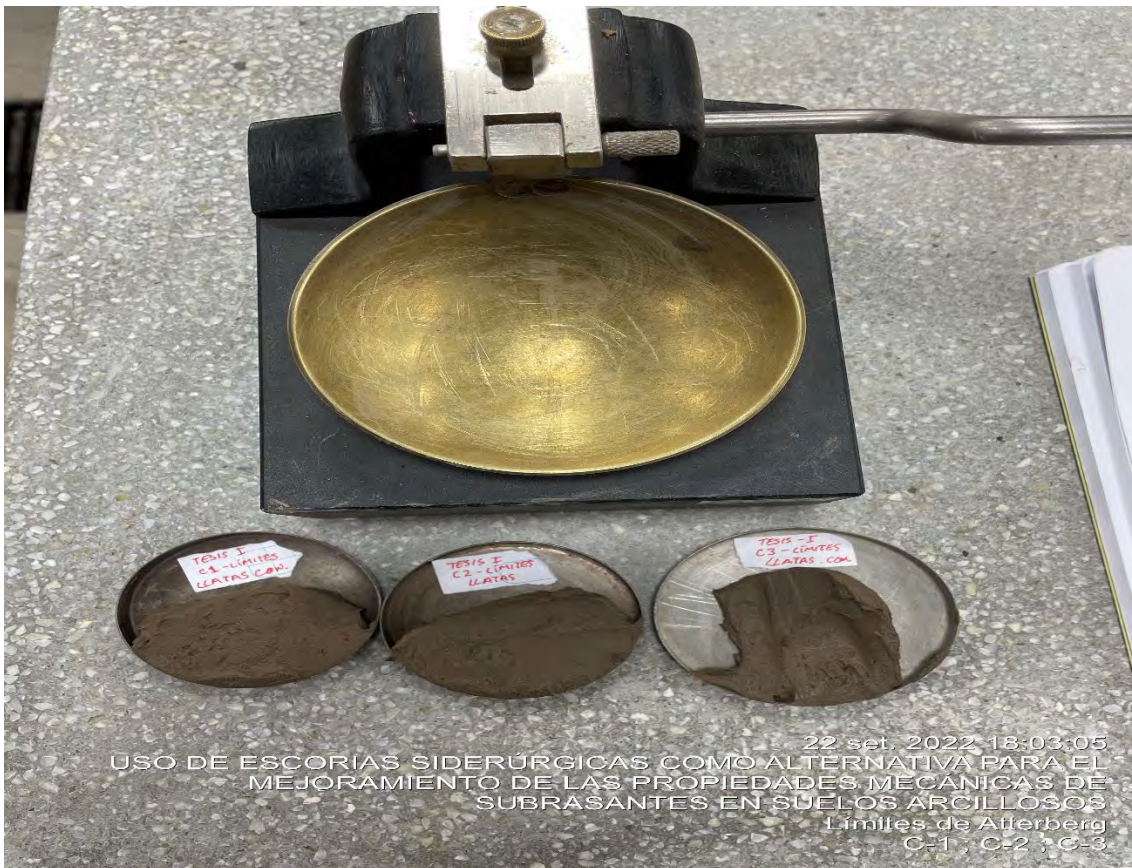
Toma de los especímenes correspondientes a la C-1, C-2 y C-3 para determinar el límite líquido mediante el ensayo de copa de Casagrande
