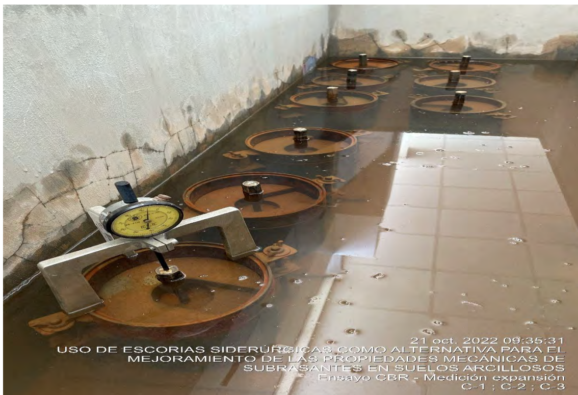
Medición de la expansión por 96 h correspondiente al ensayo de CBR de Suelos
