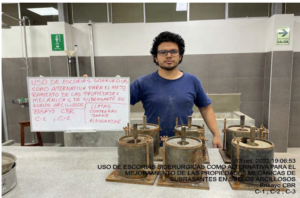
Muestras listas para ser sumergidas en agua por un periodo de 4 a 5 días de la C-1, C-2 y C-3 continuando con el ensayo de CBR en el suelo patrón
