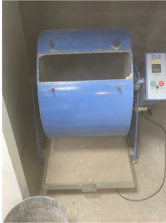
Fotografía 8. Máquina de Abrasión de los Ángeles utilizada para triturar el material empleado en los ensayos de Proctor Modificado y CBR
