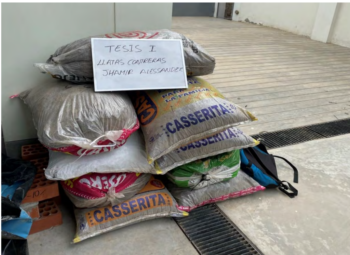
Traslado y acopio de los 9 sacos de muestras de suelo arcilloso pertenecientes a la calicata C-1, C-2 y C-3, en las instalaciones del laboratorio de Geotecnia, Caminos y Ensayos de la Universidad Católica Santo Toribio de Mogrovejo
