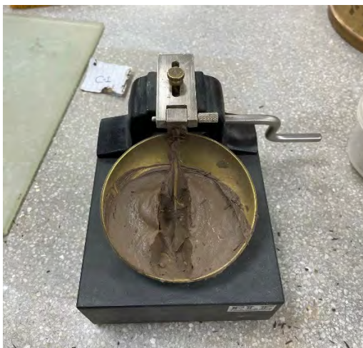
Fotografía 5. Ensayo para determinar el límite líquido utilizando la Copa de Casa Grande
