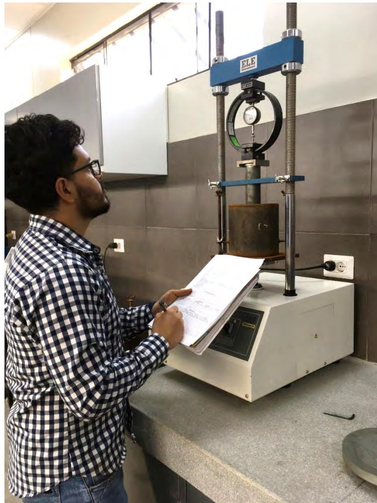
Fotografía 13. Toma de las lecturas del Ensayo de Penetración para determinar el valor de CBR
