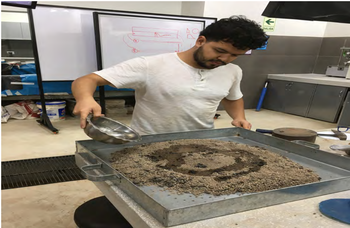
Proceso de homogenización para el posterior compactado de las muestras de Suelo con Escorias EAF para realizar el ensayo de CBR de Suelos
