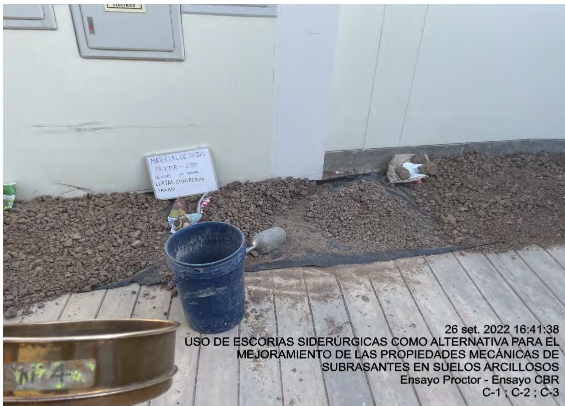
Muestra seca de suelo de las Calicatas C-1, C-2 y C-3 para el inicio de los ensayos de Proctor Modificado y CBR de Suelos
