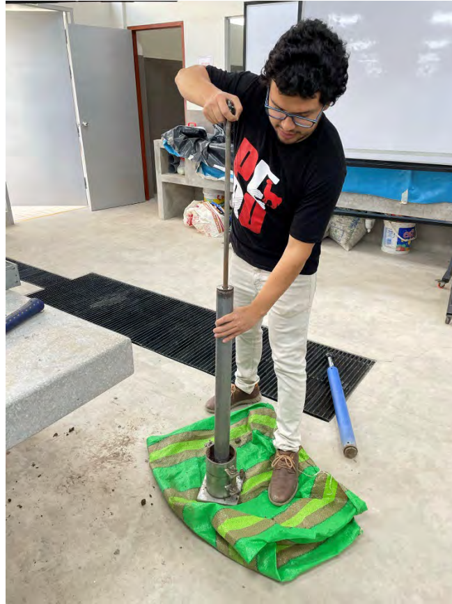
Fotografía 11. Compactación de las muestras del suelo utilizando energía modificada mediante el método A
