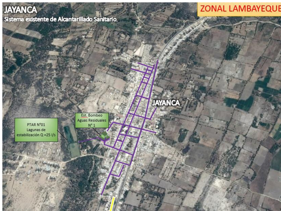
Imagen 19: Esquema General del Sistema de Alcantarillado
