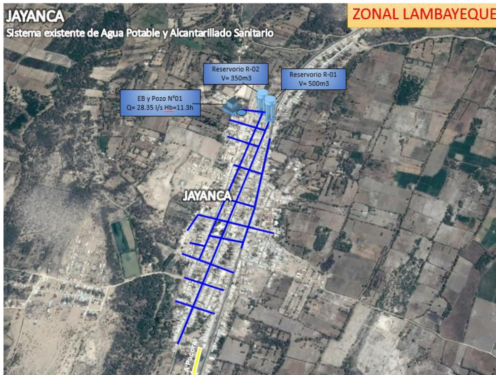
Imagen 16: Esquema General del Sistema de Agua Potable
