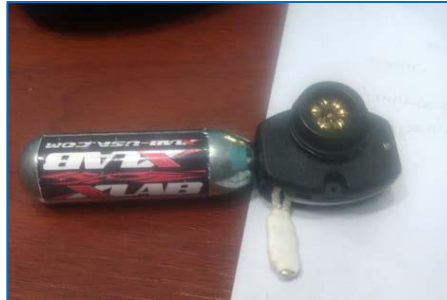
Figura 17. Mecanismo de llenado del airbag.
