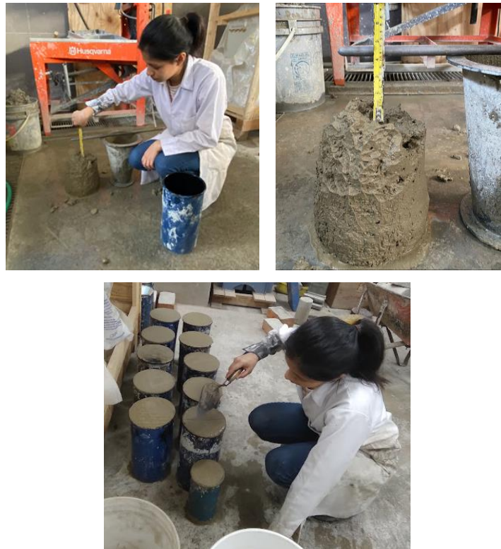
Fig. 13 Vaciado de probetas de concreto
