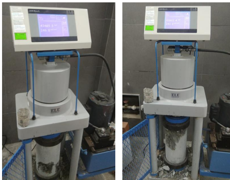
Fig. 15 Ensayo para la determinación de resistencia del concreto
