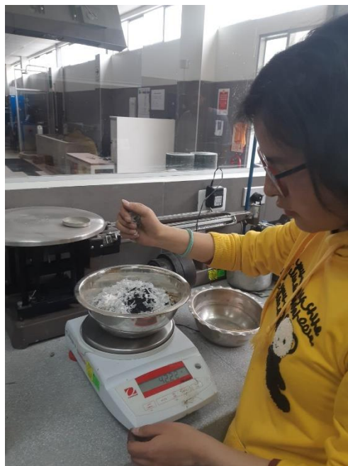
Figura 34: Incorporación del polvo de caucho y PET a la mezcla.
