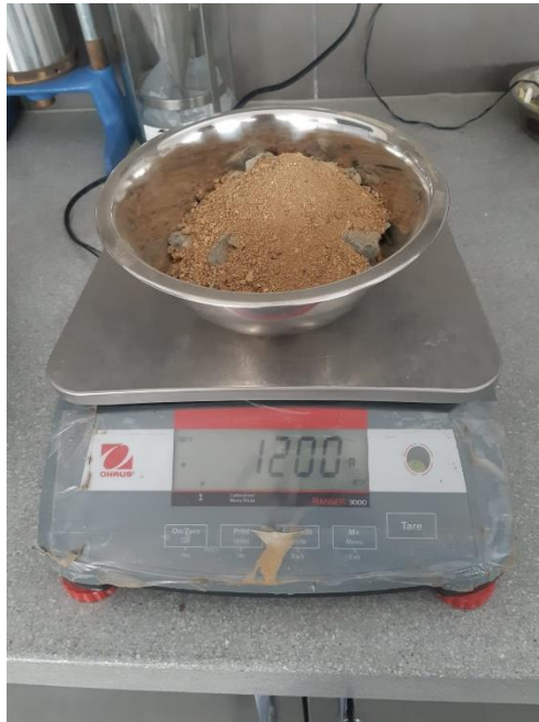
Figura 12: Peso del agregado grueso y del agregado fino.
