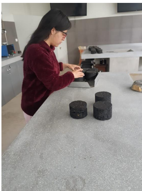
Figura 30: Especímenes en un baño de aire a 25°C.
