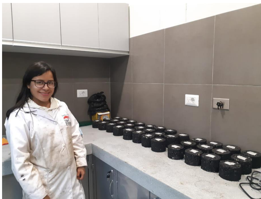
Figura 36: 36 briquetas moldeadas con la adición de PC y PET para tráfico pesado.
