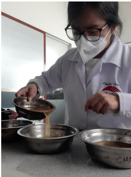
Figura 03: Ensayo de durabilidad al sulfato de magnesio.
