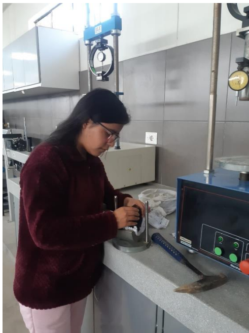
Figura 31: Colocación de la briqueta en el segmento inferior del cabezal.
