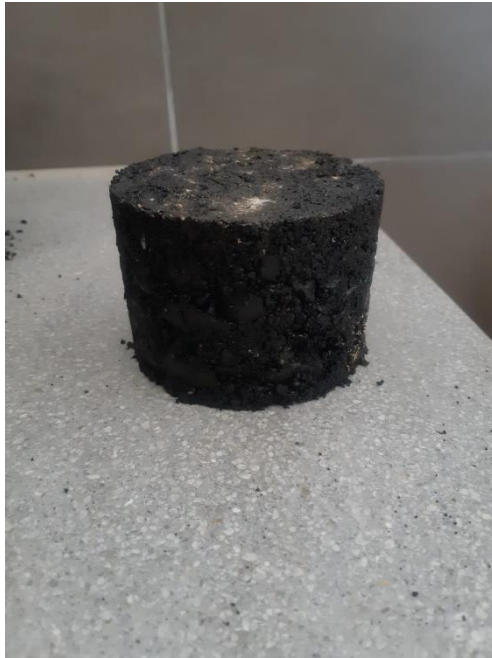
Figura 19: Briqueta moldeada y extraída.
