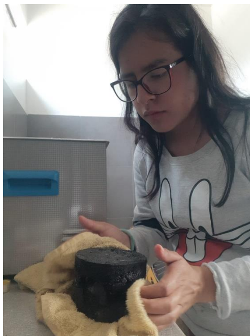
Figura 27: Secado superficial de la briqueta.
