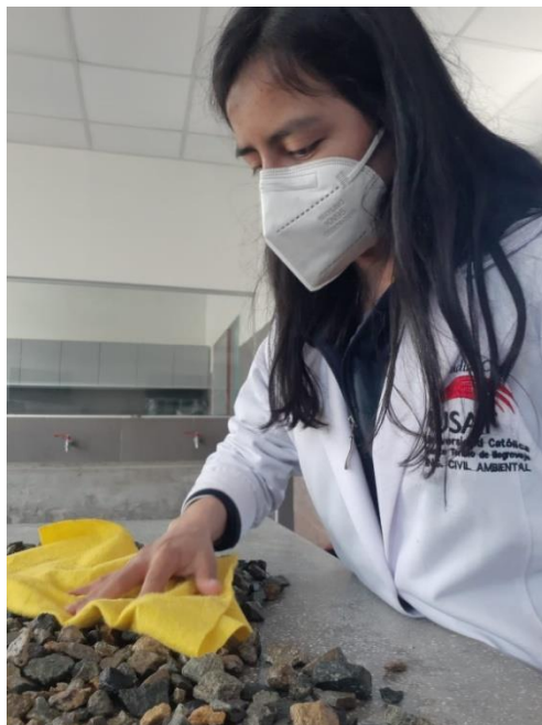
Figura 05: Secado superficial al agregado.
