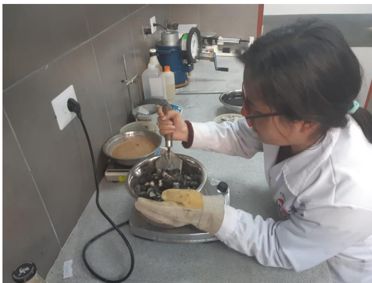
Figura 15: Mezcla convencional con agregados y cemento asfáltico.
