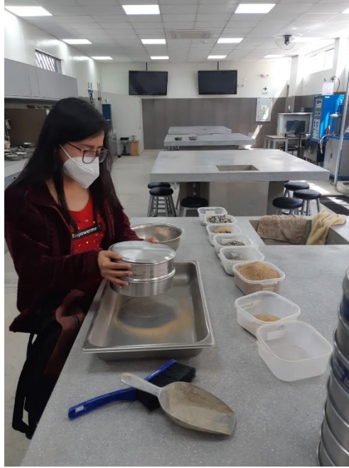
Figura 11: Tamizado del agregado.
