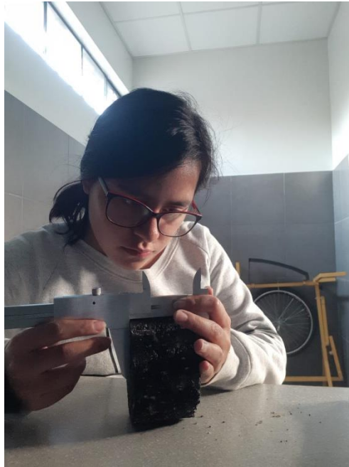
Figura 23: Toma de medida de altura de la briqueta.
