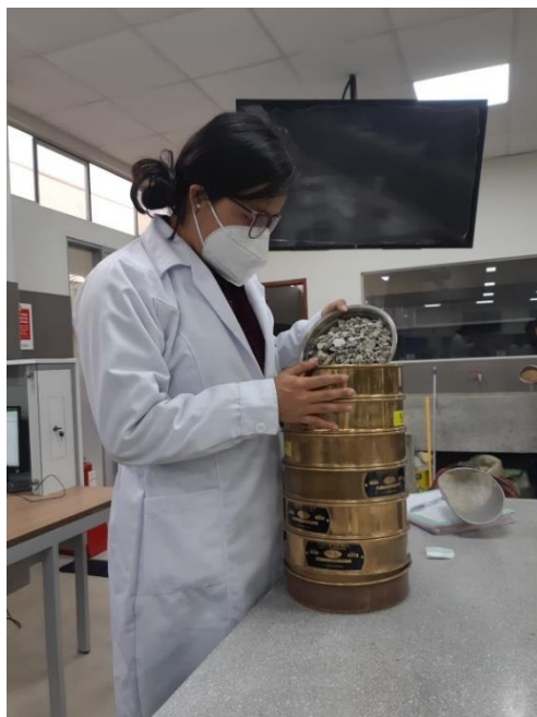
Figura 06: Tamizado del agregado.
