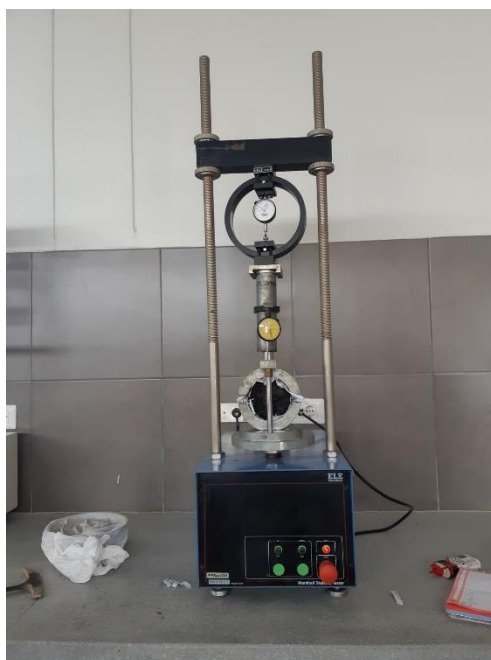
Figura 32: Máquina de carga para la rotura de la briqueta.
