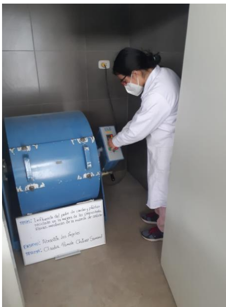
Figura 04: Ensayo de abrasión Los Ángeles.
