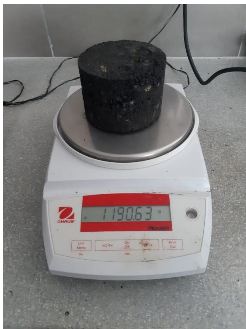
Figura 28: Peso saturado con superficie seca de la briqueta.
