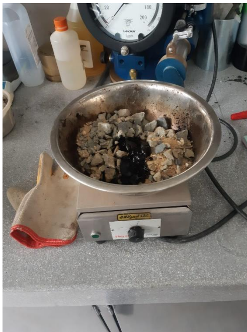
Figura 14: Colocación de la mezcla a calentar.
