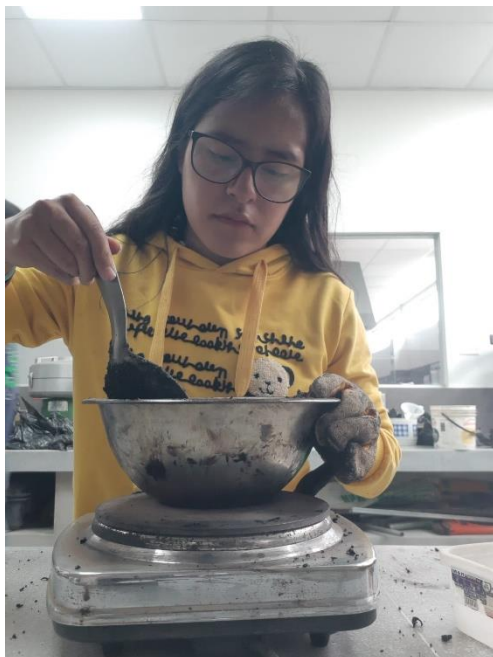
Figura 35: Preparación de la mezcla modificada con polvo de caucho y PET.
