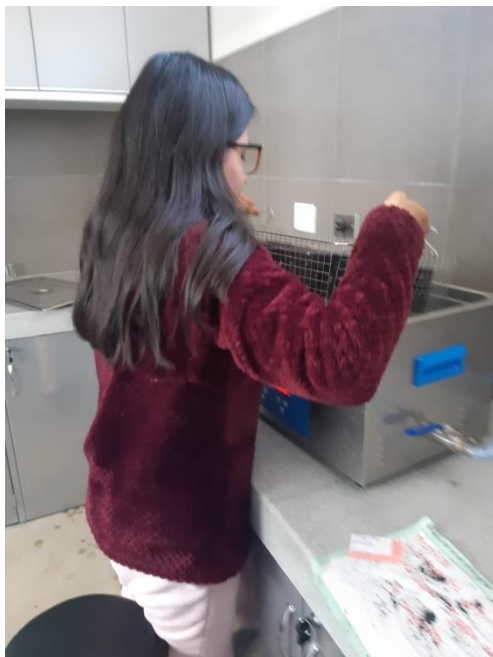
Figura 29: Colocación de los especímenes en baño de agua a 60°C.
