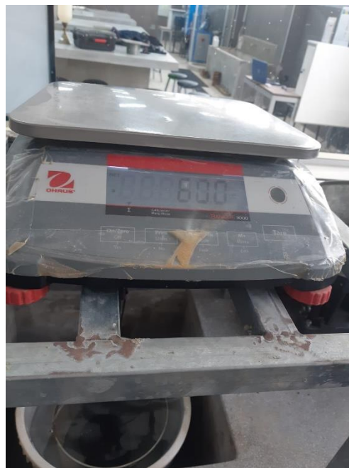
Figura 26: Peso en el agua de la briqueta.
