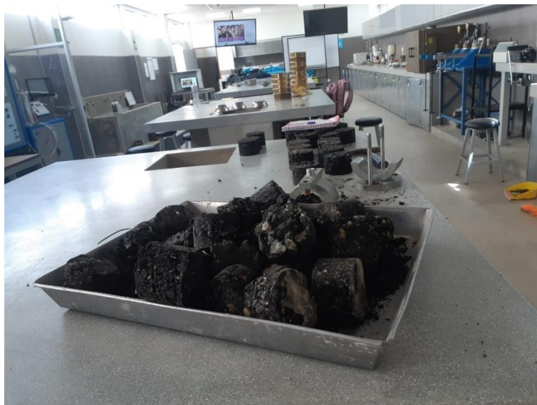
Figura 33: Rotura de briquetas.
