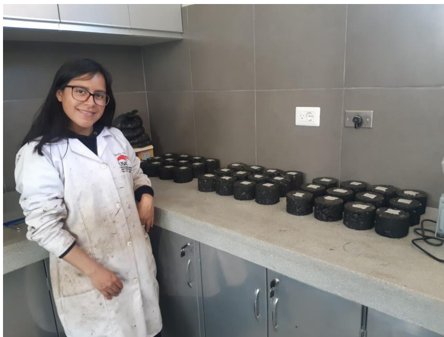
Figura 37: 36 briquetas moldeadas con la adición de PC y PET para tráfico mediano.
