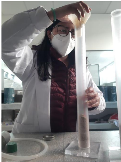
Figura 07: Colocación del agregado en la probeta.
