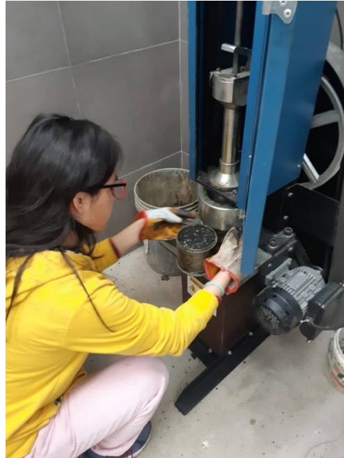
Figura 21: Colocación de la briqueta en el pedestal de compactación.
