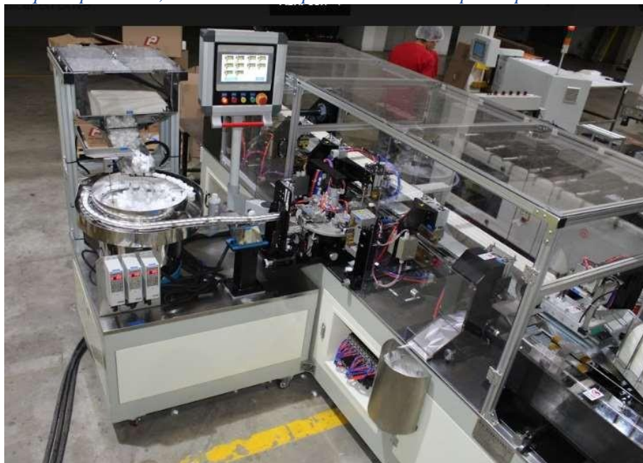
Imagen 19: Insertadora de válvulas para las bolsas pouch con valvulos
