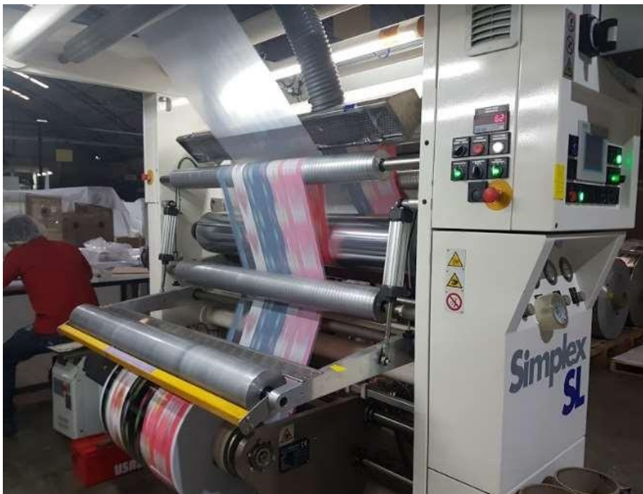
Imagen 13: Proceso de laminado, se puede ver la unión de las láminas con los adhesivos a fin de tener una sola bobina que seguirá al siguiente proceso de corte.
