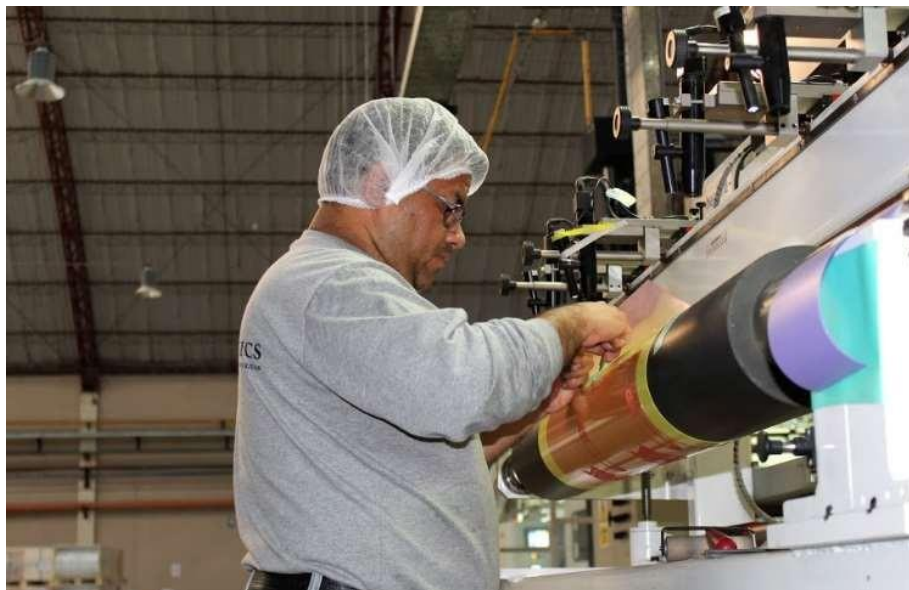
Imagen 10: Aplicación de clisset en los rodillos para iniciar la impresión
