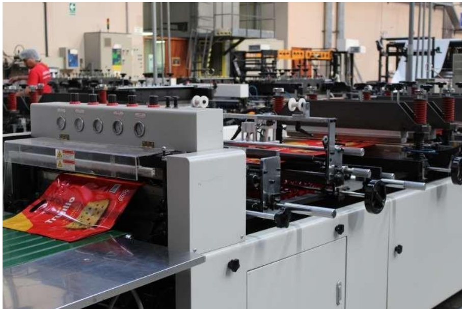
Imagen 18: Máquina pouchera, ha terminado el proceso de sellado pouch para una bolsa de panetones.
