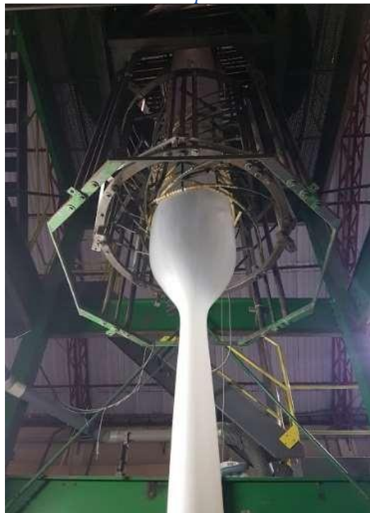
Imagen9: Inicio del Proceso de Extrusión
