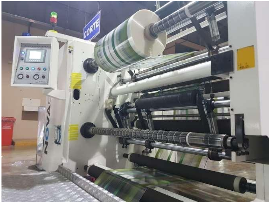
Imagen 14: Proceso de Corte, se puede ver la lámina que inicia para el refile de los extremos.
