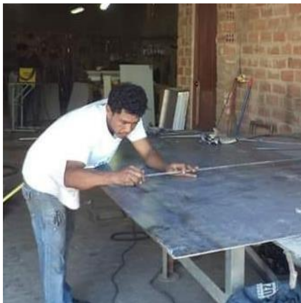
Figura 4. Trazado de plancha de acero inoxidable C304 de 1,2 mm
