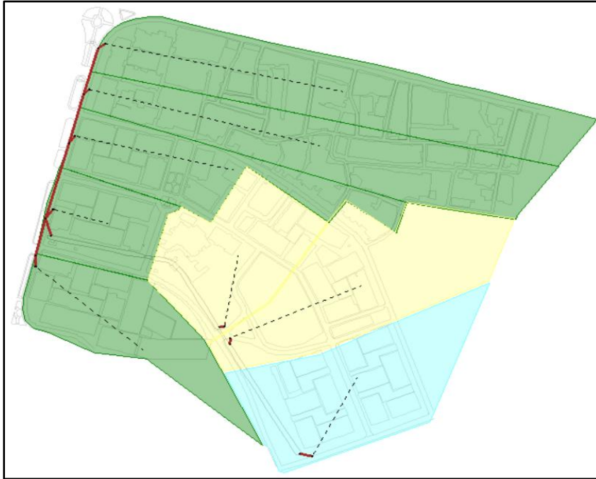
Ilustración 25: Redes de tubería del sistema de drenaje.
