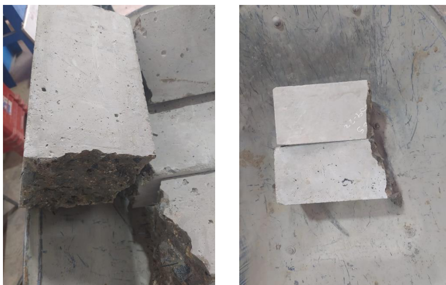
Anexo 49 Vigas luego de ser ensayadas
