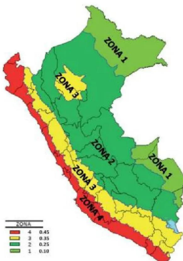
Ilustración 19 Zonificación sísmica Perú – E.030-2019
