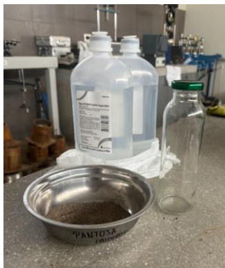
Fig. 38. Materiales para utilizar para Hidrometría
