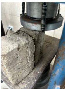
Fig. 120. Fisura en la Muestra Mortero a Tracción N°2
