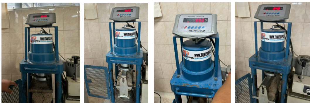
Fig. 109. Cargas que soportan los cilindros antes de su rotura a la resistencia a la tracción
