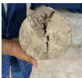
Fig. 114. Fisura en la Muestra Cilindro N°4
