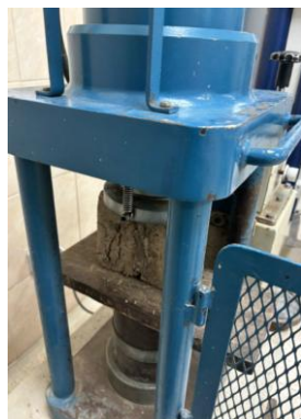
Fig. 122. Fisura en la Muestra Mortero a Tracción N°4
