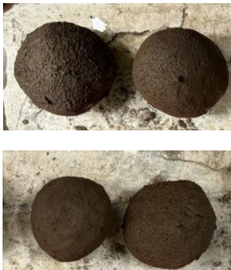
Fig. 14. Bolitas para resistencia de presencia de arcilla
