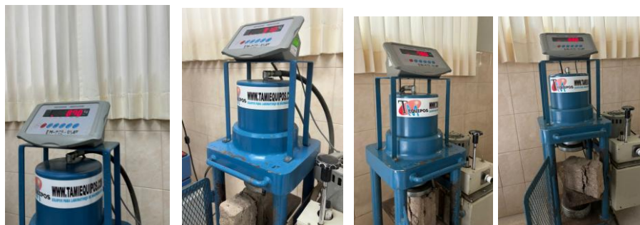
Fig. 118. Cargas que soporta el mortero a tracción en muestras
