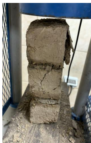
Fig. 98. Pila después del ensayo
