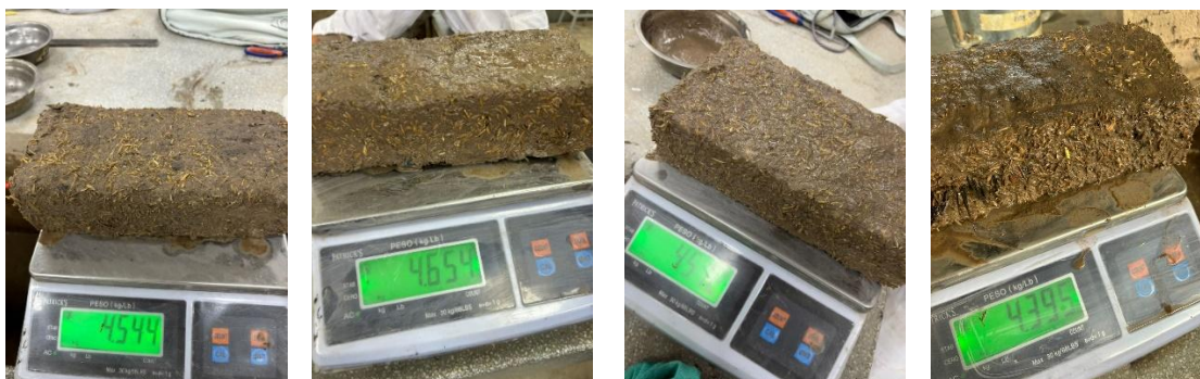
Fig. 70. Peso de las muestras patrón, 1%,2%, y 2.5% después del tiempo de sumersión para el ensayo de absorción
