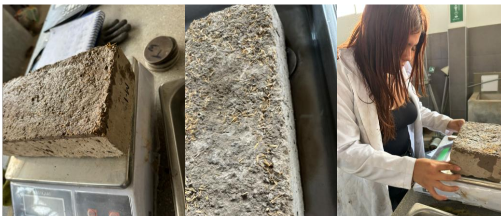
Fig. 104. Pesaje y desarrollo del ensayo de succión
