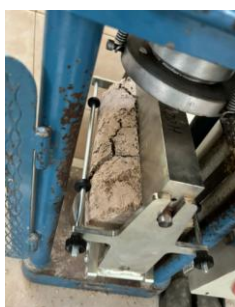
Fig. 111. Fisura en la Muestra Cilindro N°1
