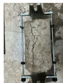
Fig. 113. Fisura en la Muestra Cilindro N°3
