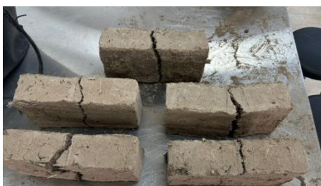
Fig. 91. Muestras rotas por flexión
