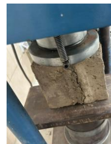
Fig. 121. Fisura en la Muestra Mortero a Tracción N°3
