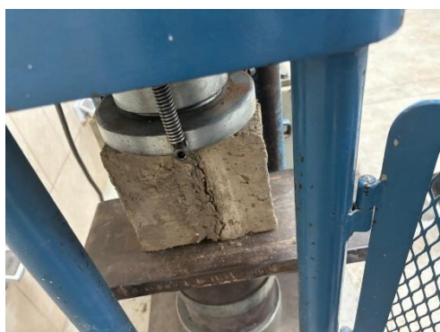
Fig. 94. Rotura del mortero
