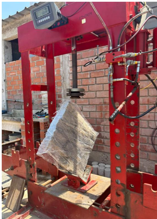
Fig. 100. Ensayo de resistencia a la compresión diagonal en muretes
