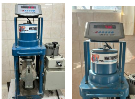
Fig. 110. Cargas que soportan los cilindros antes de su rotura a la resistencia a la tracción
