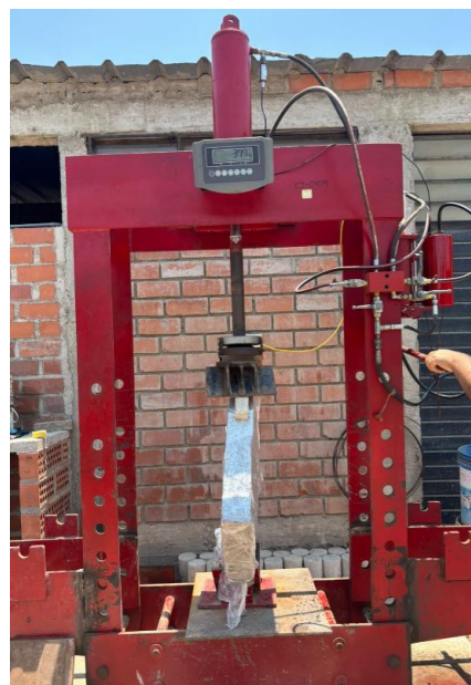
Fig. 130. Compresión diagonal en murete
