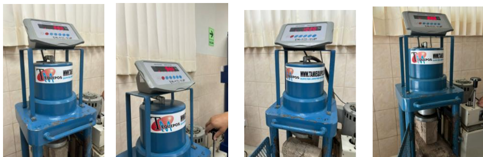
Fig. 117. Cargas que soporta el mortero a tracción en muestras
