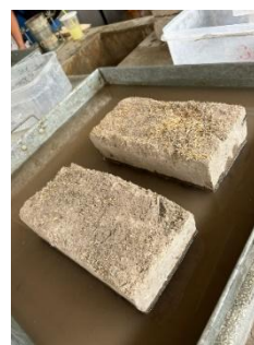
Fig. 76. Ensayo de succión en muestra con adición de 2%
