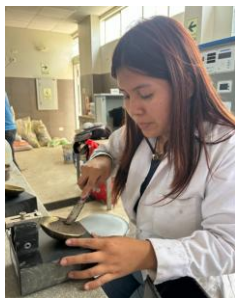
Fig. 51. Colocación de la muestra en copa de casa grande
