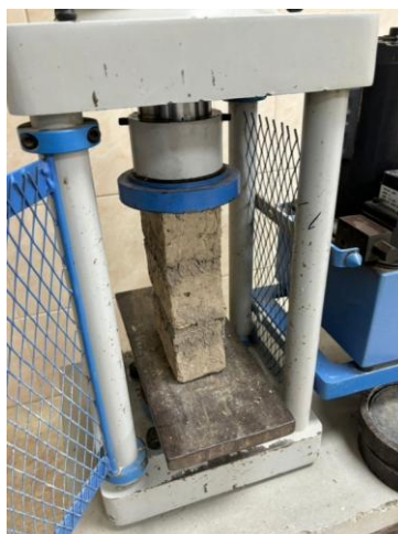
Fig. 97. Ensayo de resistencia a la compresión en pilas
