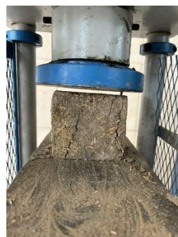
Fig. 86. Fisuración en cubos
