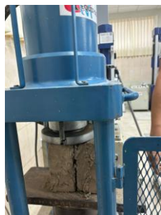
Fig. 119. Fisura en la Muestra Mortero a Tracción N°1
