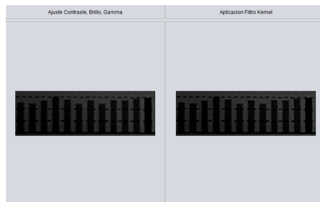
Figura 9 Aplicación de correcciones de brillo, contraste, gamma y filtro de kernel a imagen de gráfica
