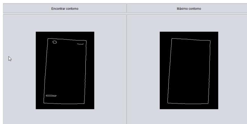
Figura 4 Aplicación del operador Canny y obtención del máximo contorno en imagen de recibo procesada
