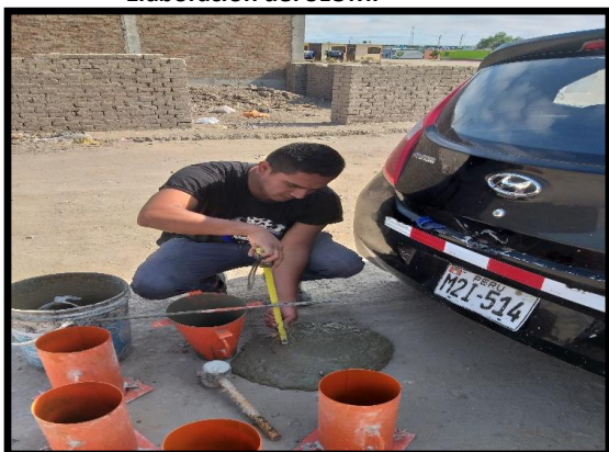
Elaboracion del SLUMP
