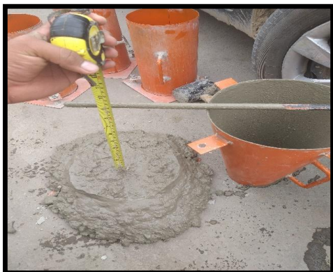
Elaboracion del SLUMP
