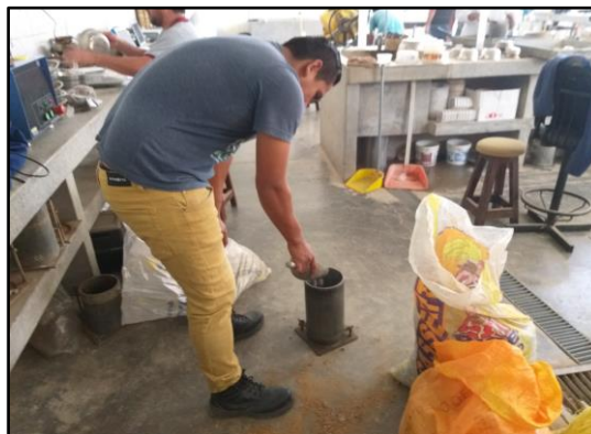
Figura 68: Obtención del peso unitario suelto del agregado
