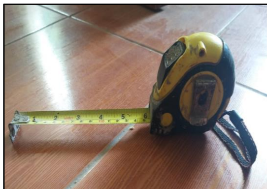
Figura 16: Cinta métrica para verificar la diferencia de alturas
