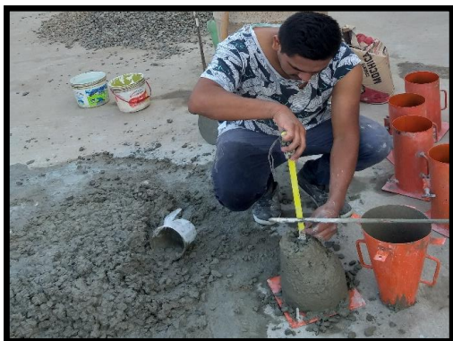
Elaboracion del SLUMP
