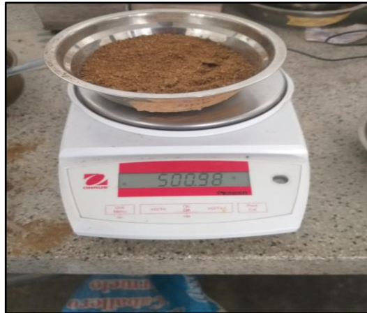
Figura 67: peso 500 kg del agregado fino
