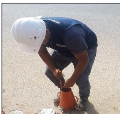
Figura 19: Compactación del concreto en el molde
