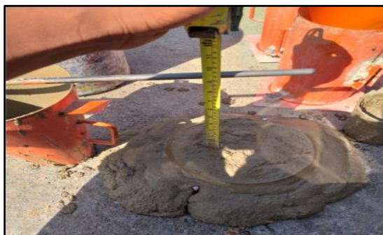
Figura 21: Medición del asentamiento
