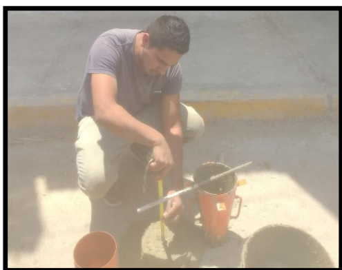
Elaboracion del SLUMP
