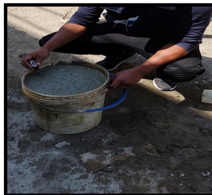
Temperatura del concreto
