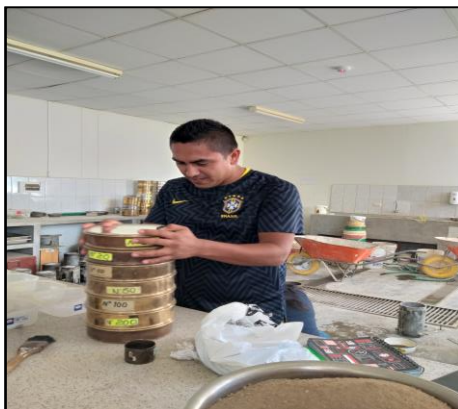
Figura 66: Zarandeo del agregado para obtener el % que pasa por cada tamiz
