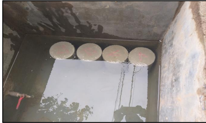
Figura 62: Probetas curadas con cal
