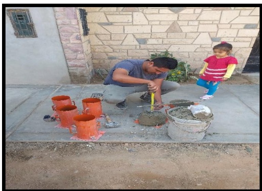
Elaboracion del SLUMP
