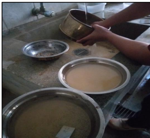
Figura 64: Lavado del agregado para obtener contenido de humedad
