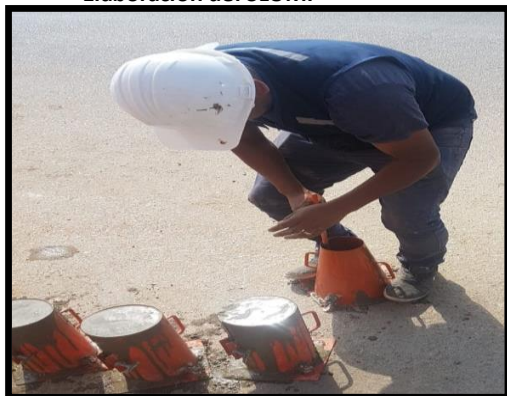
Elaboracion del SLUMP
