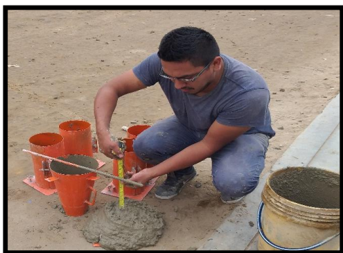
Elaboracion del SLUMP
