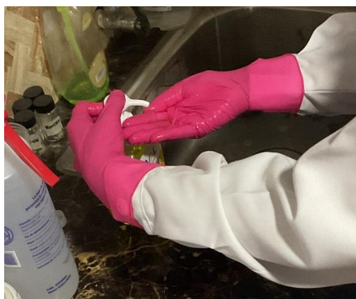
Figura. 5 Mezcla de silicona con guantes de nitrilo, expuestos a jabón
