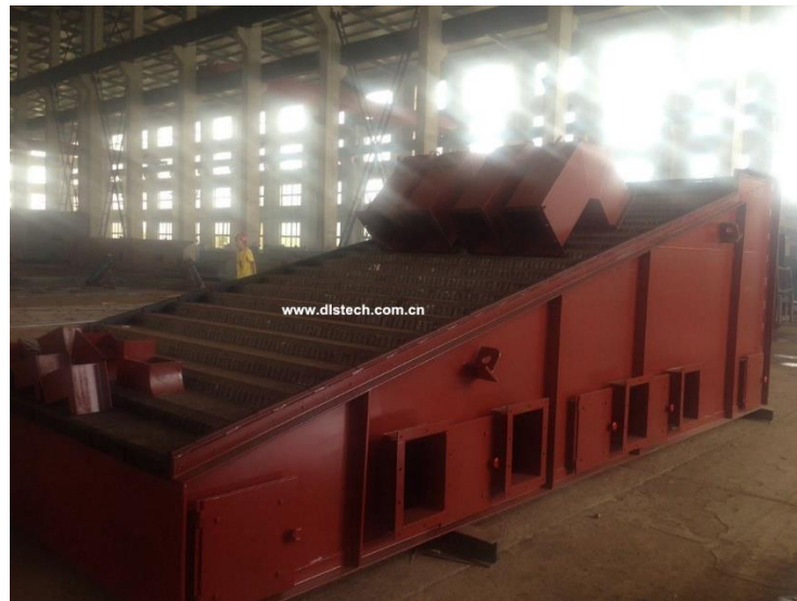
Figura 7: Rejilla tipo alternativo Stoker
