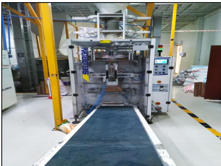
Figura N°15: Embolsadora – Selladora SP-A500-SELGRÓN.
