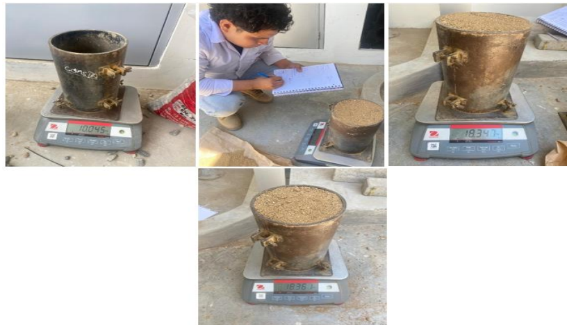
Fig. 11. Peso del molde y del AF para el ensayo de peso unitario seco suelto
