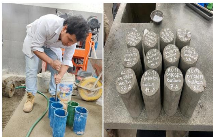
Fig. 31. Procedimiento de elaboración de probetas cilíndricas de 20 cm x 10 cm de concreto
