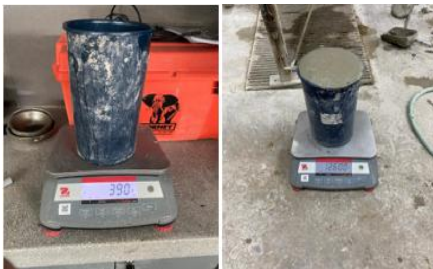
Fig. 28. Ensayo de densidad con 1% FA de adición al concreto
