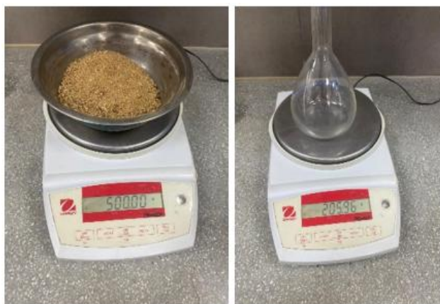
Fig. 16. Peso de la muestra de AF y peso de la fiola
