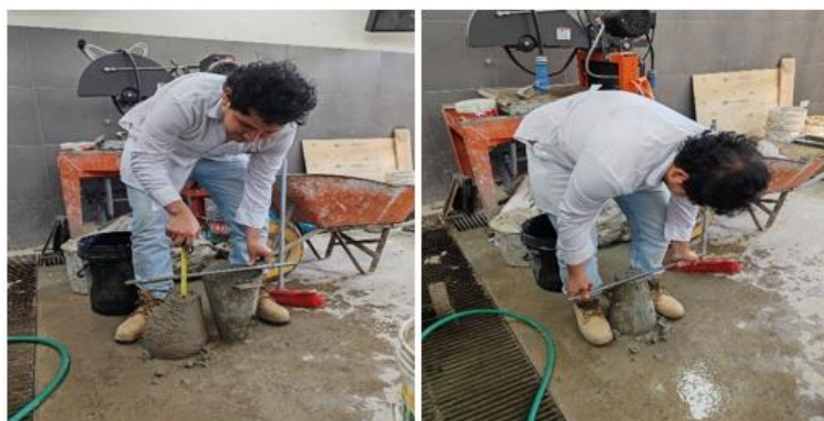
Fig. 23. Medición del asentamiento para el concreto patrón
