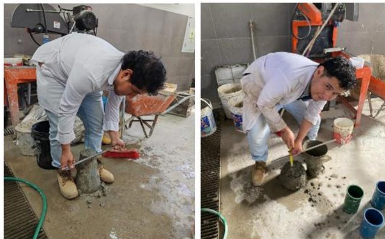
Fig. 26. Medición del asentamiento para el concreto con 3% FA
