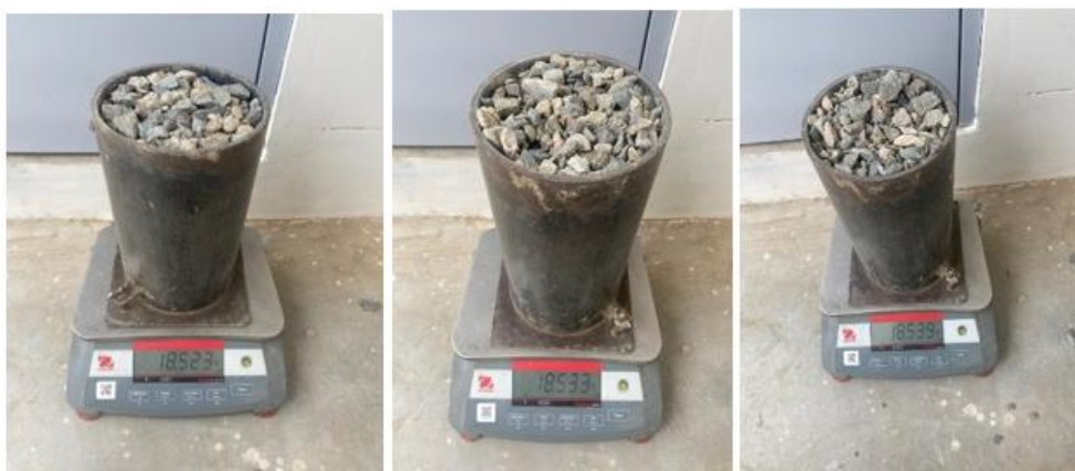
Fig. 10. Peso del molde y del AG para el ensayo de peso unitario compactado
