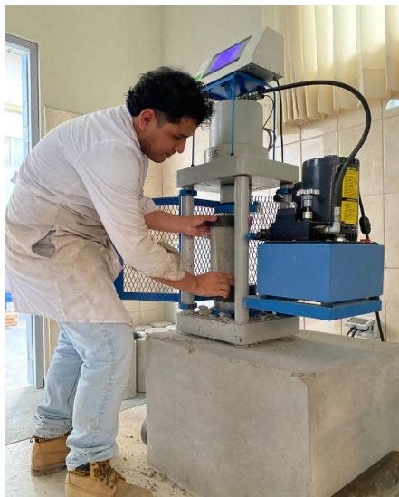
Fig. 33. Colocación de muestra de concreto en la máquina para el ensayo de RC
