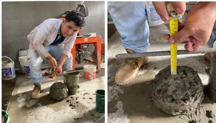
Fig. 25. Medición del asentamiento (slump) para el concreto con 2% de FA
