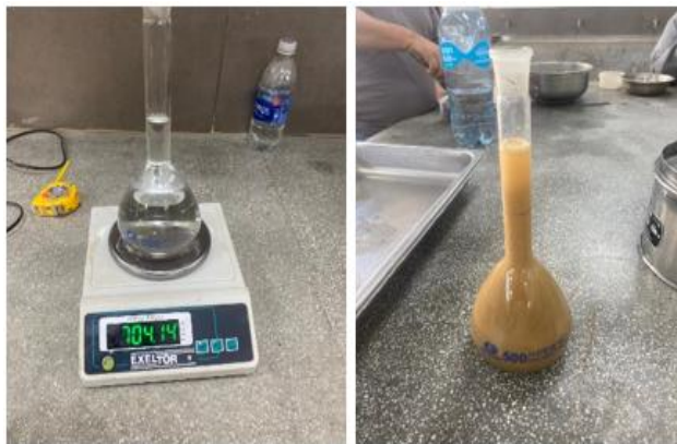
Fig. 17. Introducción del agua y arena en la fiola, material dentro de la fiola y después de 24 horas
