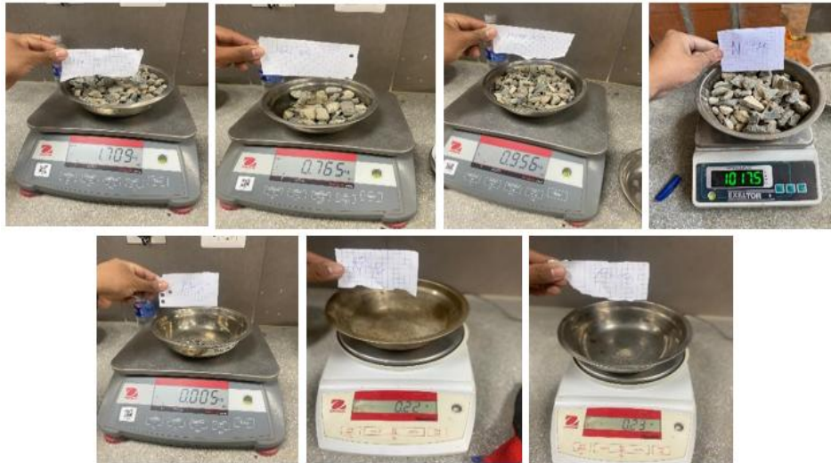
Fig. 5. Pesos de la muestra de AG retenido en los tamices
