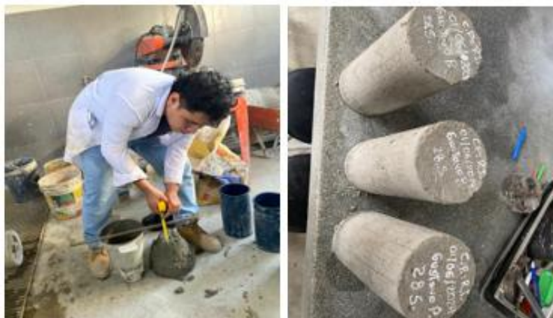
Fig. 35. Realización de probetas del ensayo de RT
