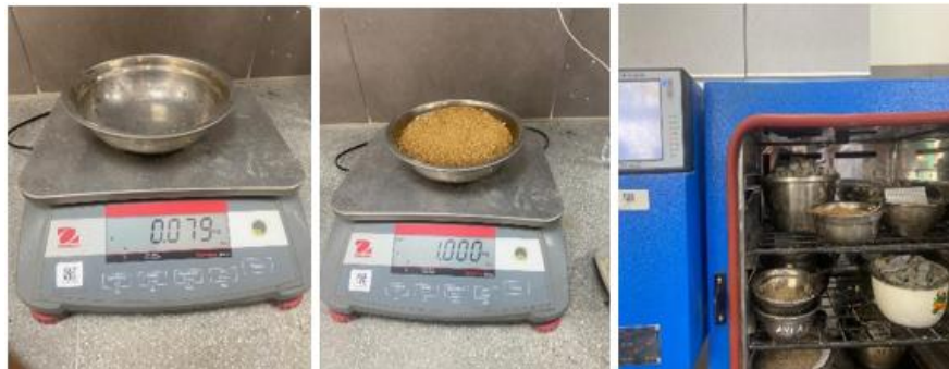
Fig. 20. Peso de la muestra de AF, antes y después de meterlo al horno
