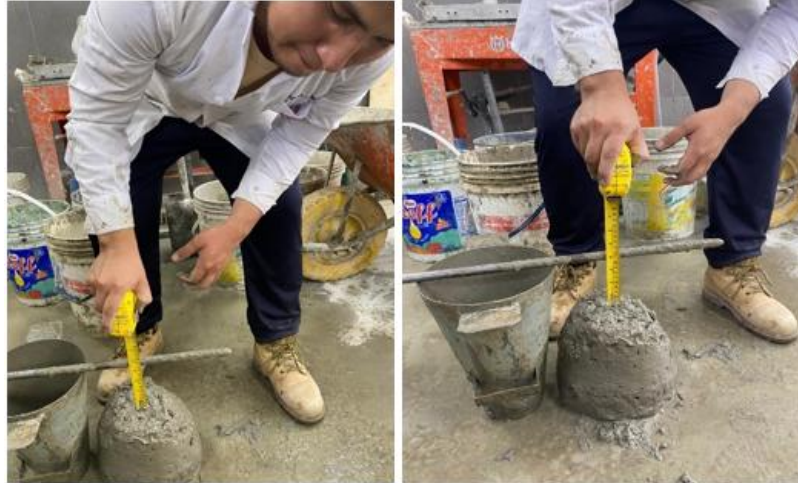
Fig. 24. Medición del asentamiento (slump) para el concreto con 1% FA
