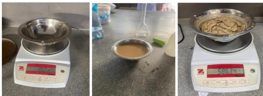
Fig. 18. Introducción del agua y arena en la fiola, material dentro de la fiola y después de 24 horas
