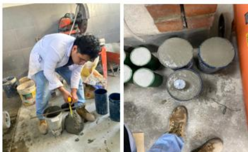
Fig. 32. Procedimiento de elaboración de probetas cilíndricas de 30 cm x 15 cm de concreto
