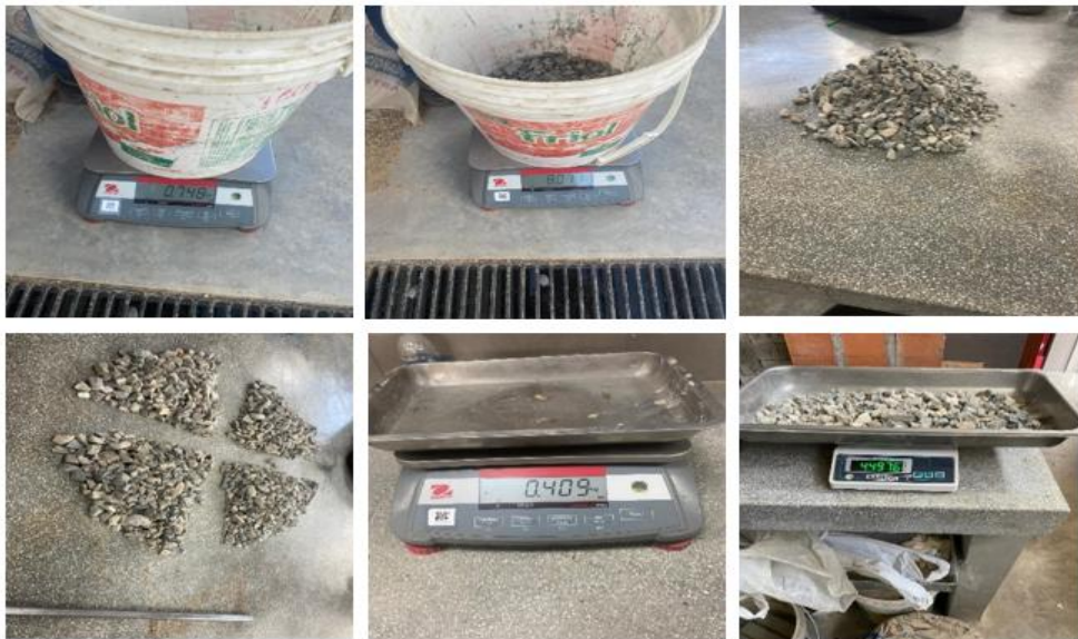
Fig. 3. Pesado y cuarteo de la muestra de AG utilizado
