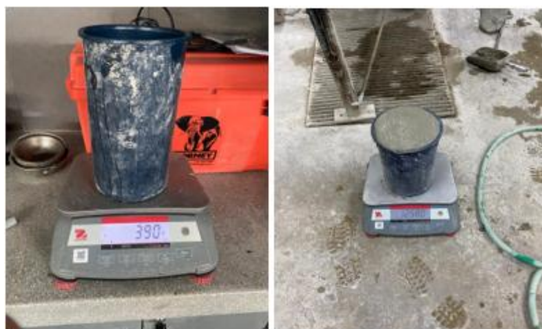
Fig. 30. Ensayo de densidad con 3% de fibra de algarrobo al concreto
