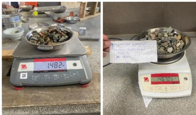
Fig. 15. Pesos de la muestra 02 de AG para ensayo de peso específico y absorción; antes de sumergir, sumergido y secado al horno
