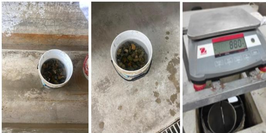
Fig. 13. Muestra de AG saturada y peso de la canastilla
