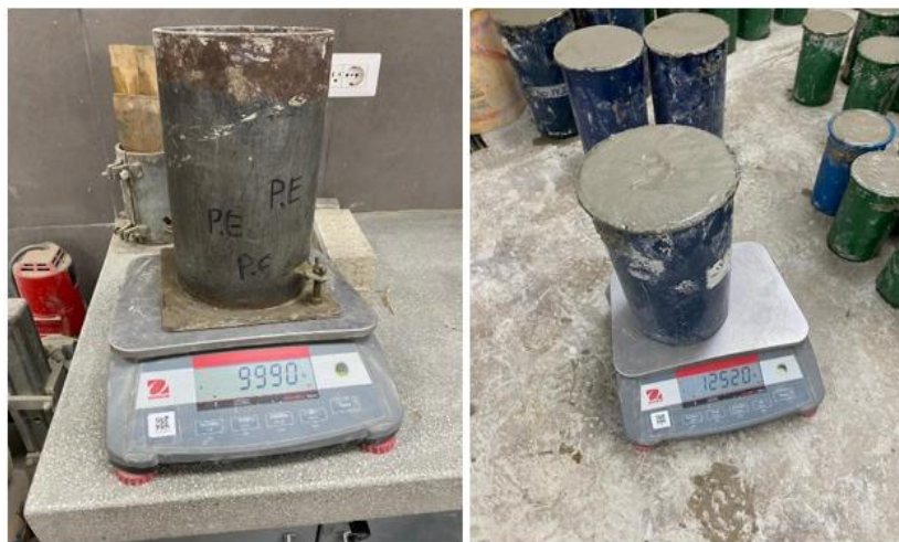
Fig. 27. Pesado de la muestra con concreto para ensayo de densidad
