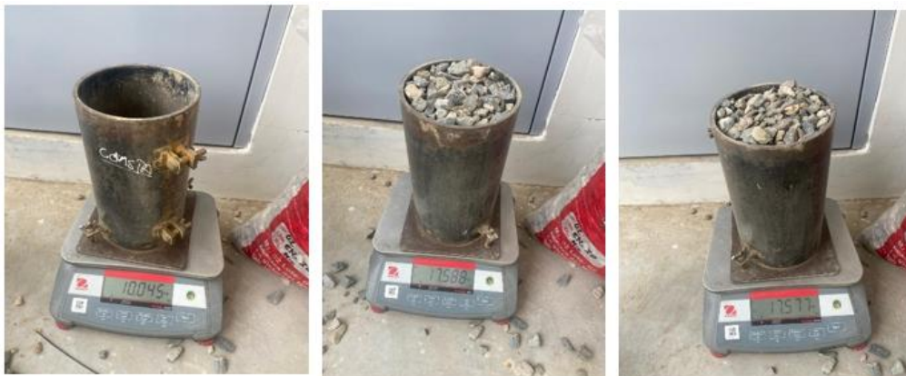
Fig. 9. Peso del molde y del AG para el ensayo de peso unitario seco suelto
