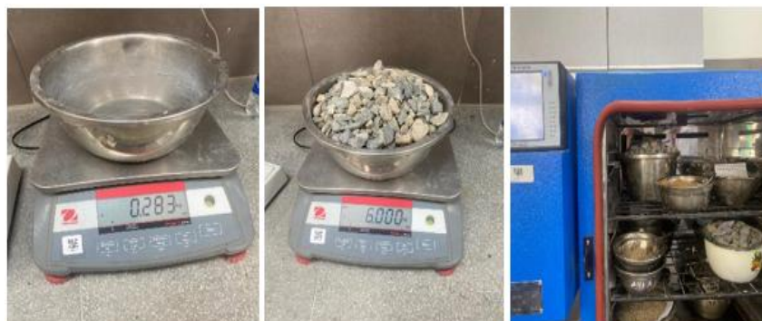
Fig. 19. Peso de la muestra de AG; antes y después de meterlo al horno
