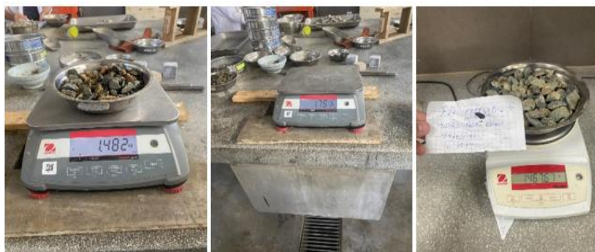
Fig. 14. Pesos de la muestra 01 de AG para ensayo de peso específico y absorción; antes de sumergir, sumergido y secado del horno
