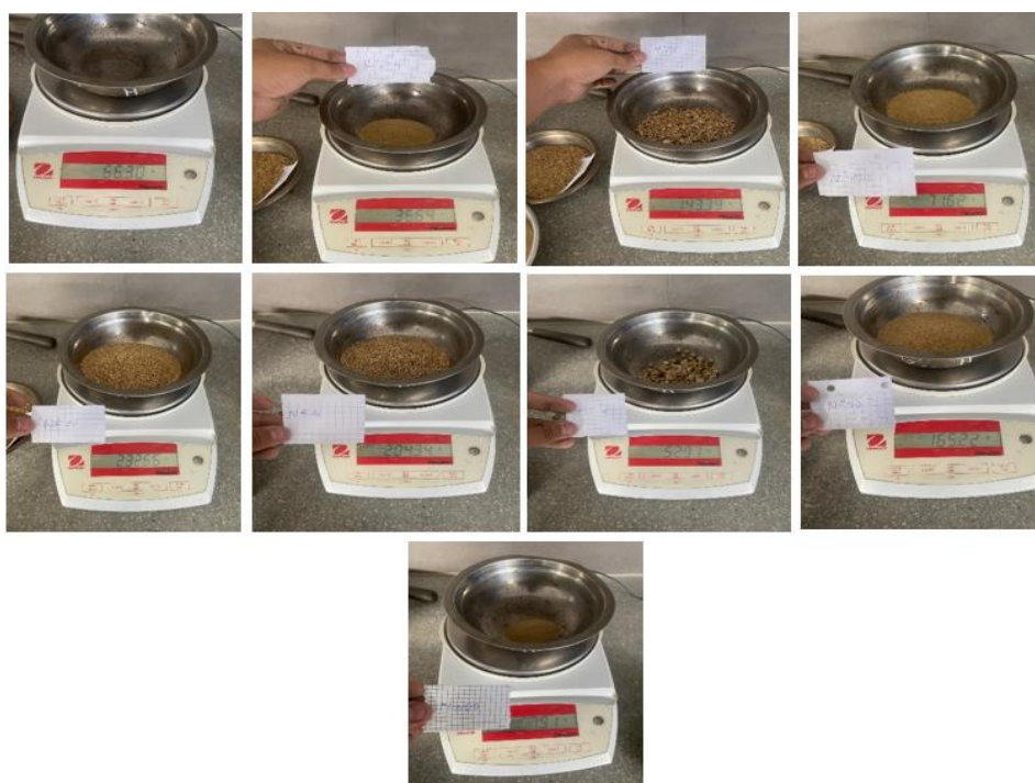
Fig. 8. Pesos de la muestra del AF retenido en los tamices
