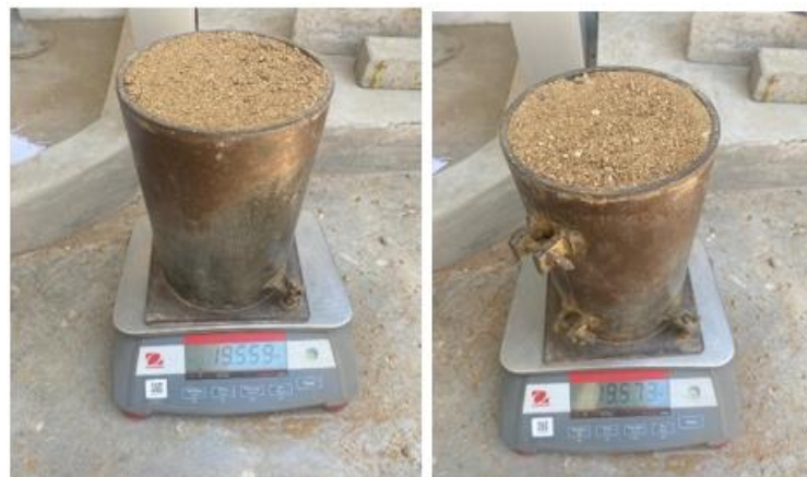
Fig. 12. Peso del molde y del AF para el ensayo de peso unitario seco compactado
