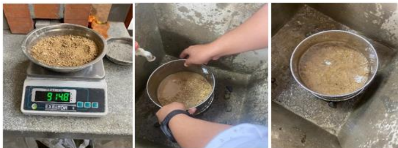
Fig. 6. Pesado y lavado del AF
