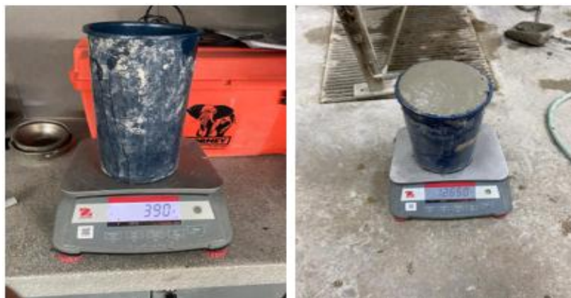
Fig. 29. Ensayo de densidad con 2% FA de adición
