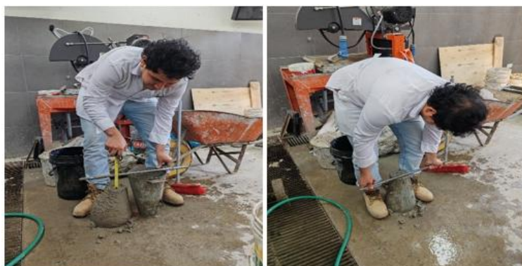
Fig. 22. Procedimiento del ensayo de trabajabilidad (slump)
