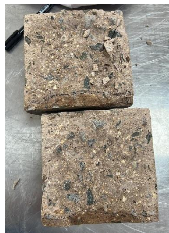
Fig. 38. Penetración del agua con cemento Yura
