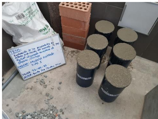
Ilustración 21: Fraguado de las muestras del diseño patrón
