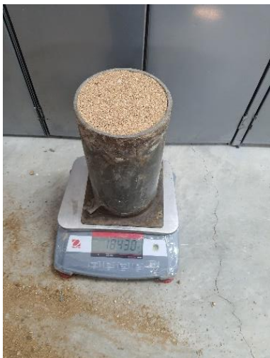
Ilustración 16: Peso unitario suelto del agregado fino - Peso "A"
