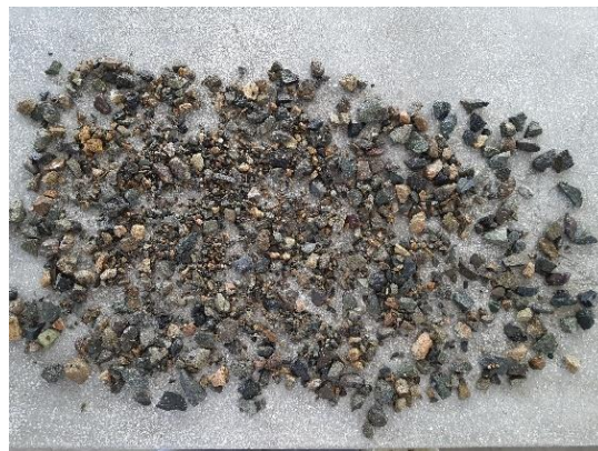
Ilustración 13: Secado superficialmente del agregado grueso
