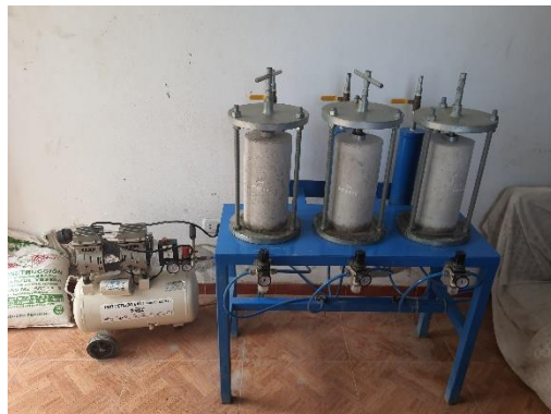
Ilustración 50: Probetas bajo presión de agua
