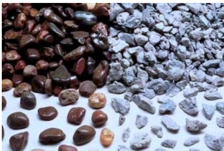
Ilustración 3: Agregado grueso (grava redondeada y piedra triturada)
