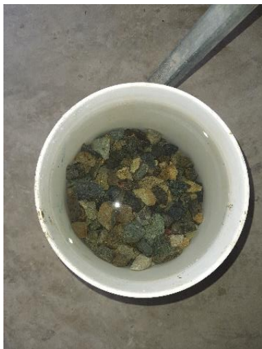
Ilustración 12: Saturación del agregado grueso durante 24 horas
