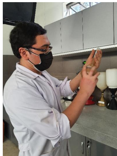
Ilustración 15: Extracción de las burbujas de aire atrapado en la fiola
