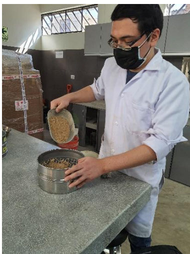
Ilustración 14: Tamizado del agregado fino por la malla N° 04
