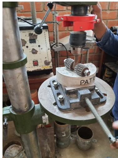
Ilustración 48: Inicio del ciclo del primer ciclo de desgaste
