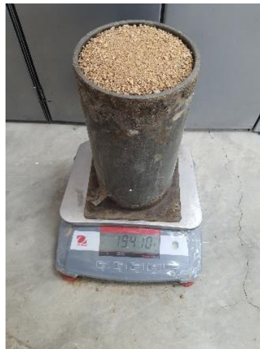
Ilustración 17: Peso unitario compactado del agregado fino - Peso "A"
