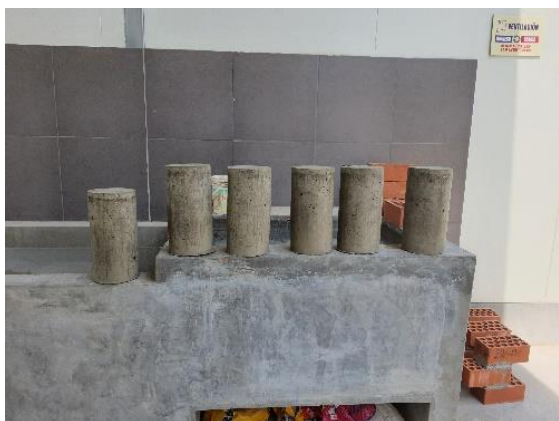
Ilustración 22: Desencofrado de probetas y traslado a poza de curado
