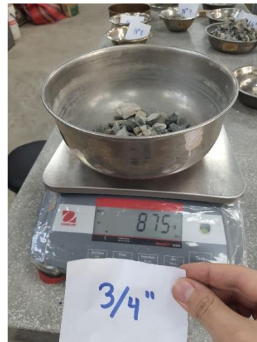
Ilustración 7: Peso del primer retenido - Agregado grueso
