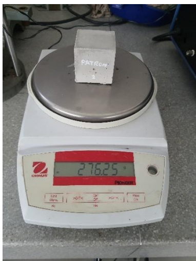
Ilustración 41: Peso seco tomado a un dado de concreto
