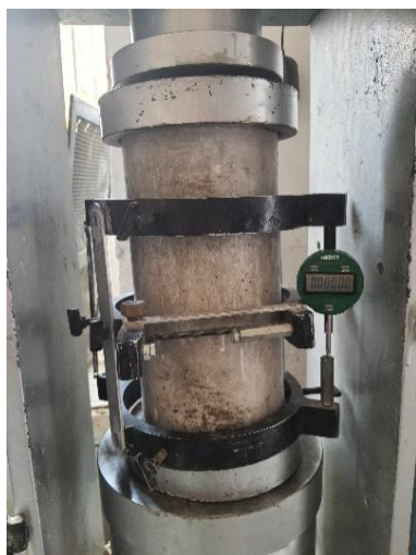
Ilustración 31: Instalación del espécimen en la máquina de compresión
