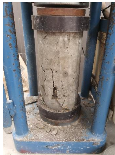
Ilustración 28: Identificación de tipo de falla
