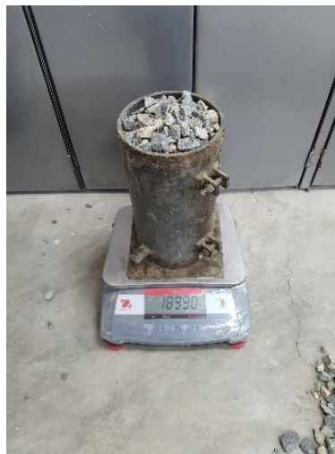
Ilustración 19: Peso unitario compactado del agregado grueso - Peso "A"
