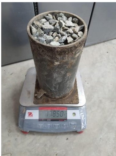
Ilustración 18: Peso unitario suelto del agregado grueso - Peso "A"
