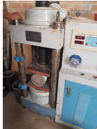
Ilustración 54: Rotura de probetas
