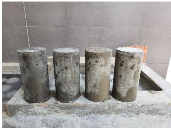
Ilustración 25: Extracción de especímenes culminado el proceso de curado
