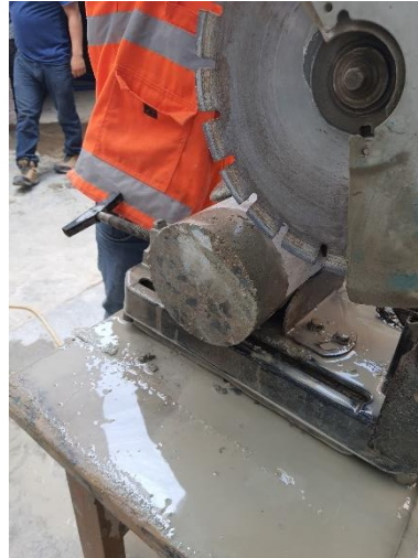
Ilustración 44: Cortadora giratoria para extraer los núcleos de concreto
