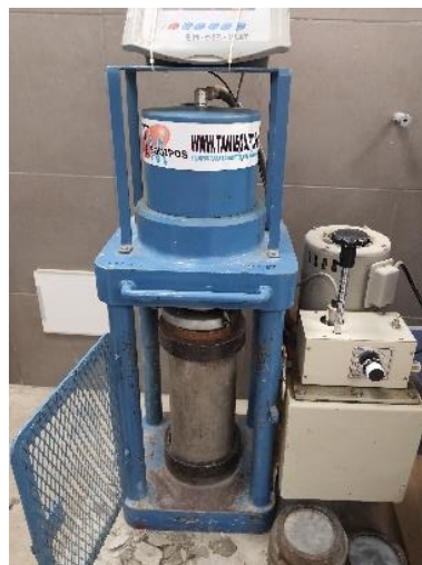
Ilustración 26: Instalación de espécimen en la máquina de compresión
