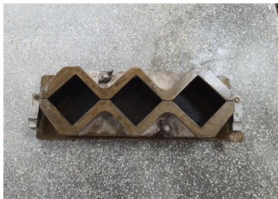
Ilustración 42: Moldes de metal para dados de 50x50x50 mm
