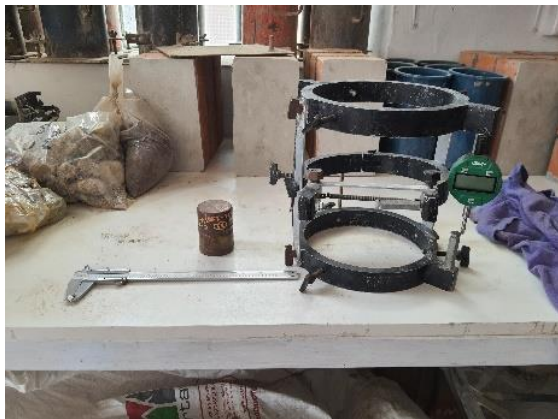
Ilustración 29: Equipos e instrumentos para medir el módulo de elasticidad
