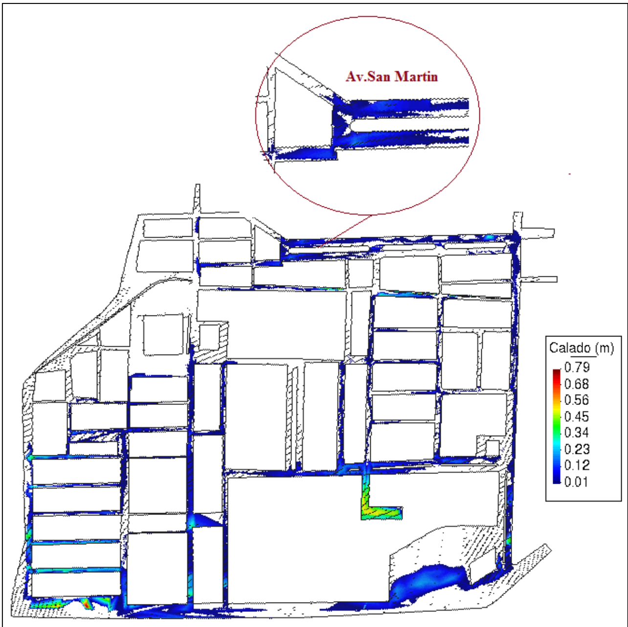
Figura N° IV.21: Zona Inundable-Avenida San Martin
