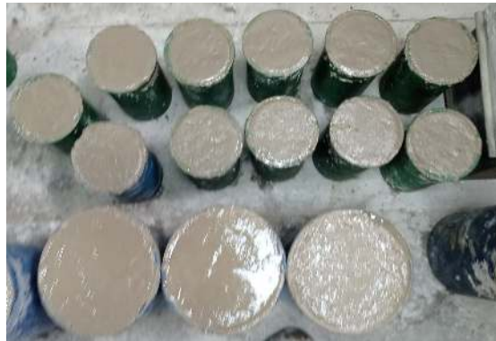
Figura N° 25: Testigos realizados para ensayo a compresión y tracción.
