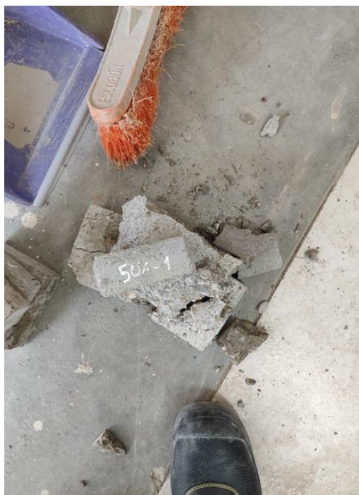
Anexo 4: Escombros de adoquines ensayados
