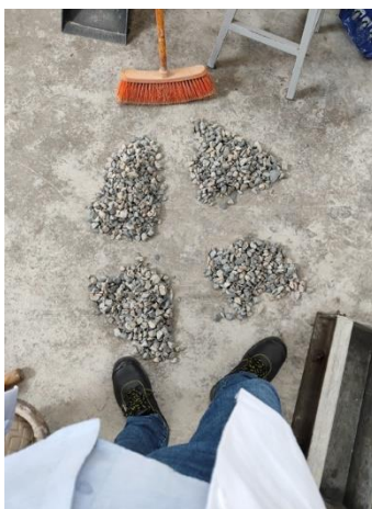
Imagen 67: Cuarteo del agregado grueso
