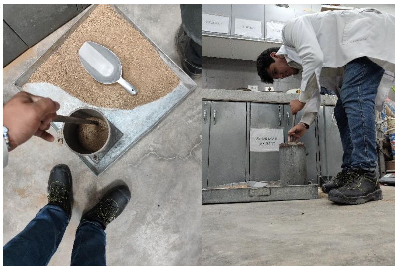
Imagen 44: Varillado de la muestra en molde
