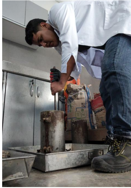
Imagen 40: Varillado de la muestra en molde
