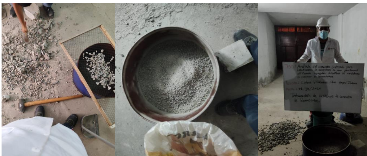
Imagen 19: Trituración y tamizado del agregado reciclado
