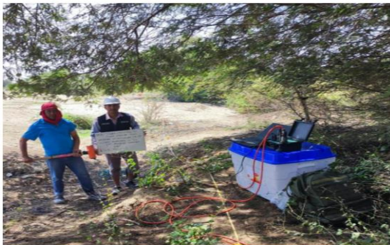
Fotografía N°10.08: Refracción sísmica en campo LS-02
