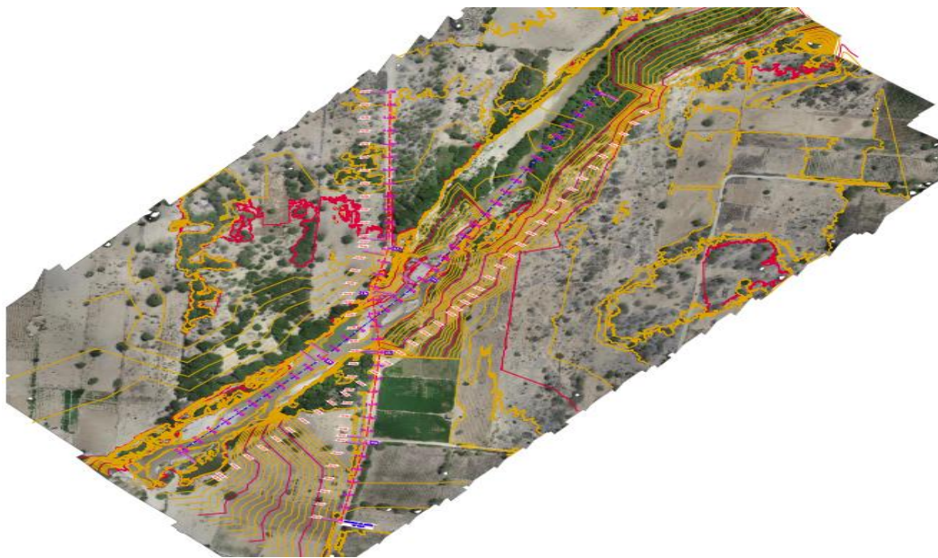
Fig. 37 Superficie del terreno y curvas de nivel.
