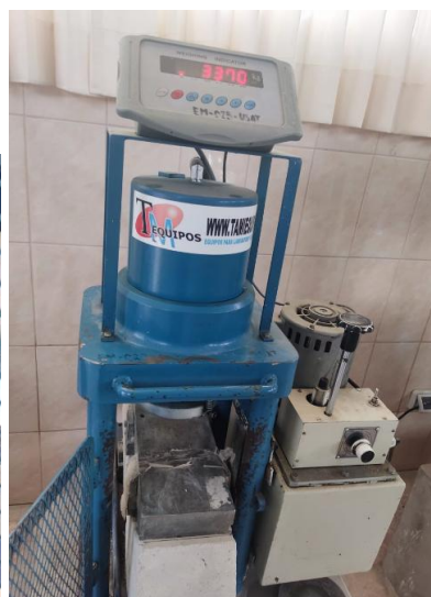
Figura 42 y 43: rotura de viga de concreto en maquina
