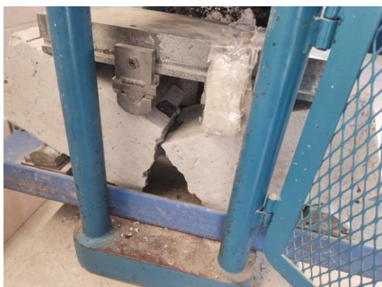
Figura 42 y 43: rotura de viga de concreto en maquina
