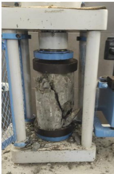
Figura 40 y 41: rotura de probeta de concreto en maquina
