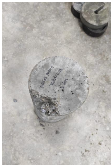
Figura 40 y 41: rotura de probeta de concreto en maquina
