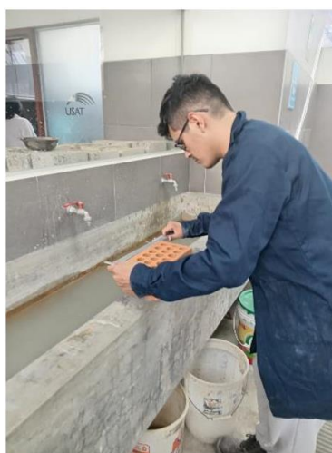
Imagen 40: Medida del largo del ladrillo
