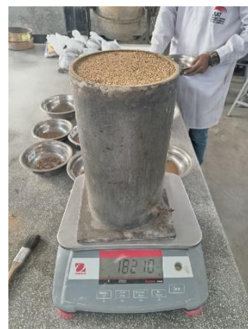
Imagen 16: Peso del molde + peso agregado suelto
