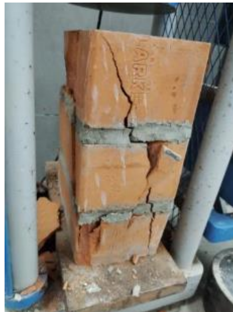
Anexo 49.8. Muestra de pila ensayada a compresión, modo de falla
