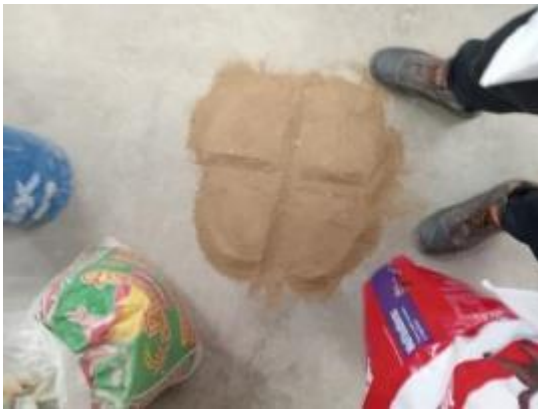
Anexo 43.1 Cuarteo de la muestra de agregado fino
