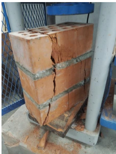
Imagen 63: Falla en la parte frontal y lateral de la pila P2- MP 1:3
