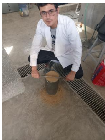
Imagen 15: Enrasado para eliminar el exceso de material en el molde
