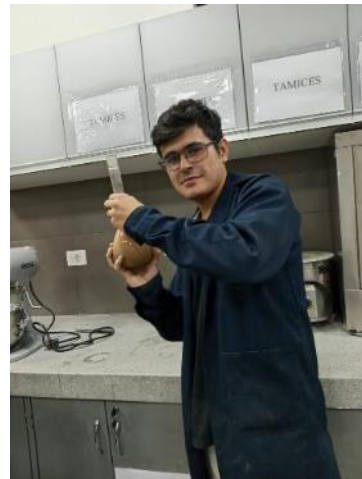
Imagen 23: Eliminación del aire atrapado
