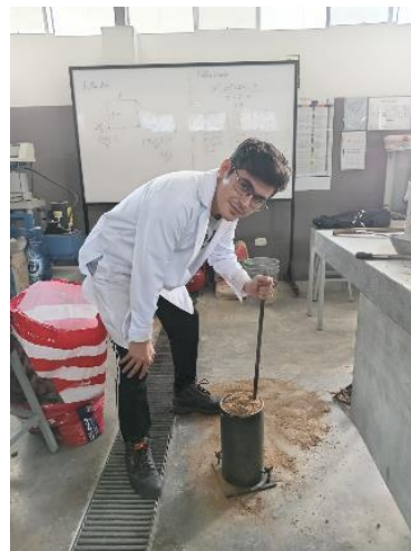
Imagen 18: Compactado mediante varillado
