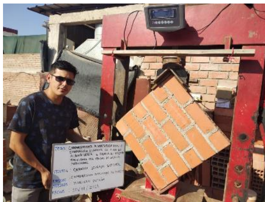
Imagen 55: Murete listo para ser sometido a compresión diagonal
