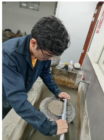
Imagen 28: Medida de los diámetros posterior a los 25 golpes en la mesa de flujo
