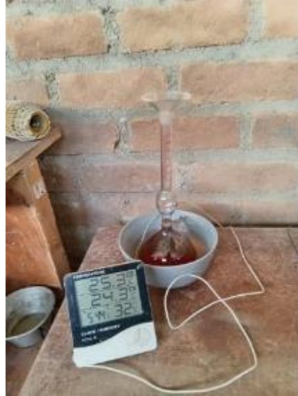
Anexo 42.2. Control de temperatura del kerosene en frasco de Chattelier
