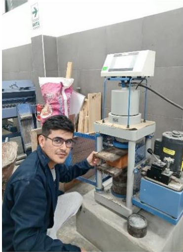
Imagen 46: Ubicación del ladrillo para ser sometido a compresión
