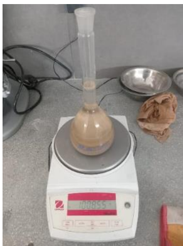
Imagen 24: Peso de la muestra sup. seca + peso frasco + peso del agua
