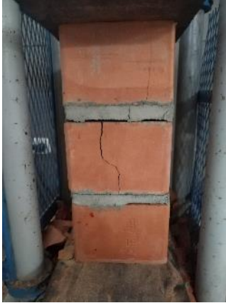
Imagen 82: Falla en la parte frontal la pila P12- MM 1:3 (15%CLA)
