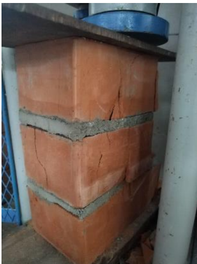
Imagen 71: Falla en la parte frontal y lateral de la pila P6- MM 1:3 (5%CLA)
