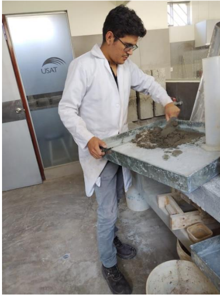
Imagen 48: Preparación de mortero para muestra de adherencia
