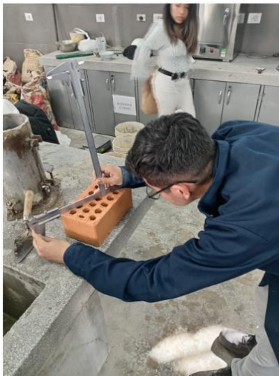
Imagen 42: Medidas tomadas a partir de la convexidad o concavidad del ladrillo
