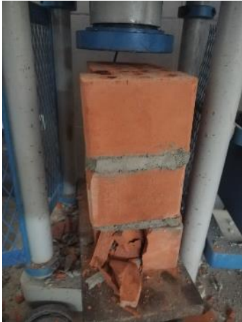
Imagen 79: Falla en la parte frontal de la pila P10- MM 1:3 (15%CLA)
