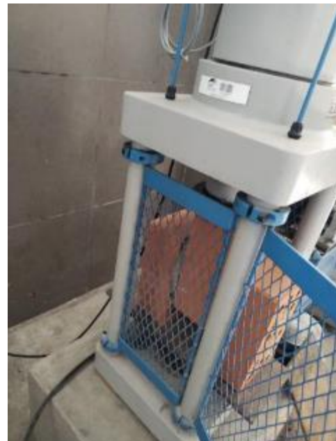
Anexo 52.2. Pilas ensayada para el calculo de adherencia al cizallamiento
