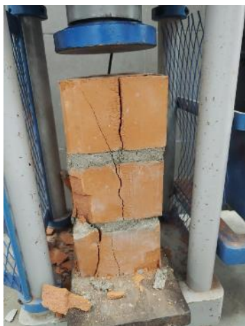
Imagen 61: Falla en la parte frontal de la pila P1- MP 1:3
