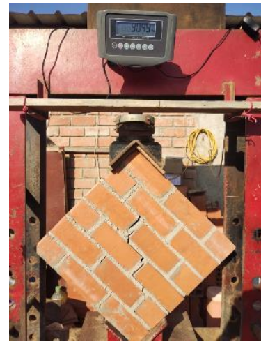
Imagen 89: Falla en murete M6-MM 1:3 (5%CLA)
