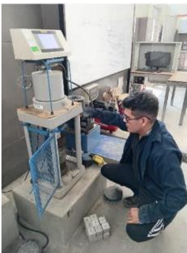
Imagen 37: Aplicación de la carga al cubo de mortero
