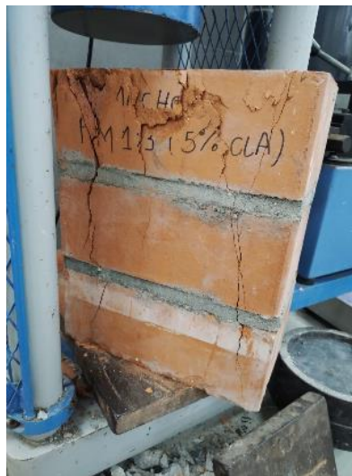
Imagen 72: Falla en la parte lateral de la pila P6- MM 1:3 (5%CLA)
