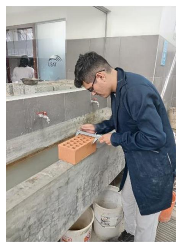
Imagen 41: Medida del ancho del ladrillo
