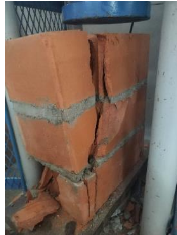
Imagen 80: Falla en la parte lateral de la pila P10- MM 1:3 (15%CLA)
