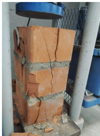
Imagen 62: Falla en la parte lateral de la pila 1- MP 1:3
