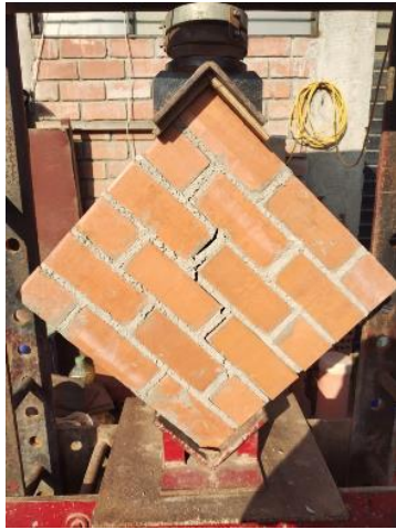
Imagen 84: Falla en murete M1-Muestra patrón 1:3
