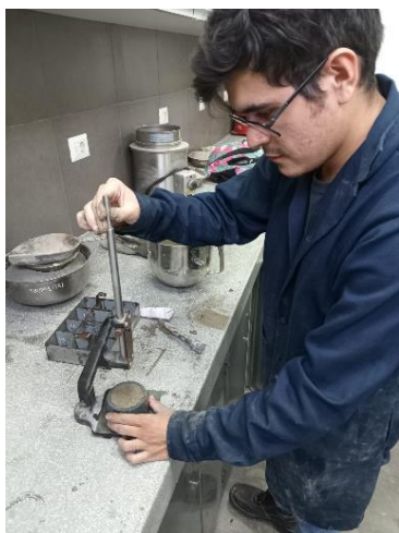
Imagen 33: Penetración de la aguja de Vicat
