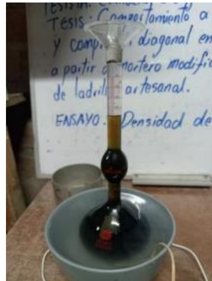
Anexo 42.4. Asentamiento de la ceniza para el cálculo de la densidad
