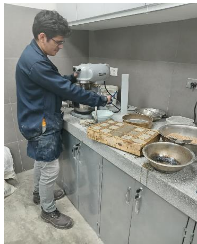
Imagen 60: Elaboración de la mezcla de mortero
