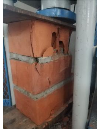
Imagen 76: Falla en la parte lateral de la pila P8- MM 1:3 (10%CLA)
