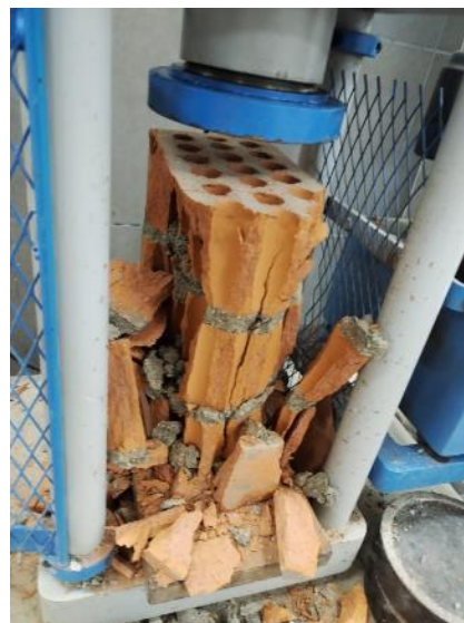
Imagen 70: Falla en la parte lateral de la pila P5- MM 1:3 (5%CLA)
