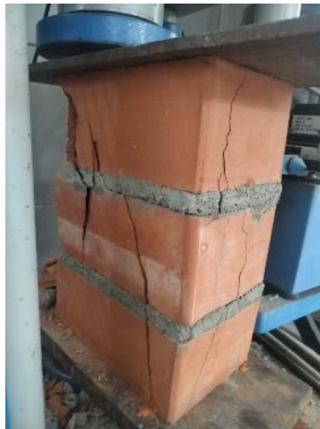
Imagen 81: Falla en la parte frontal y lateral de la pila P11- MM 1:3 (15%CLA)
