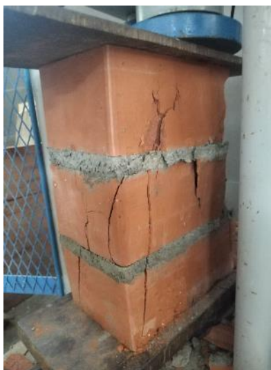
Imagen 74: Falla en la parte lateral de la pila P7- MM 1:3 (10%CLA)
