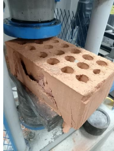
Imagen 47: Muestra de ladrillo posterior a la aplicación de la carga
