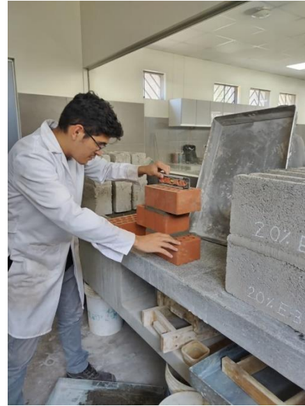
Imagen 49: Nivelación de muestra para ensayo de adherencia
