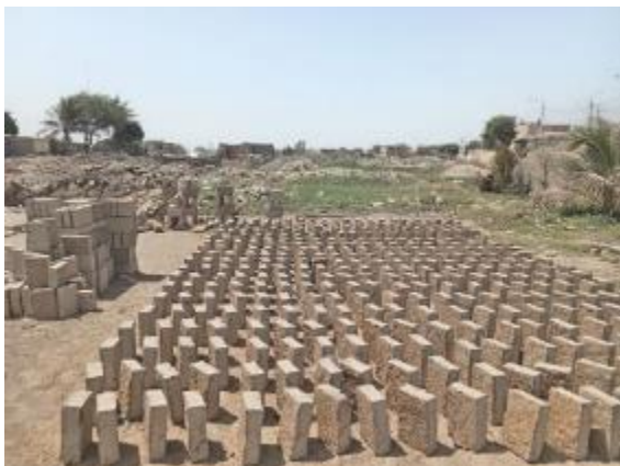
Anexo 14: Secado de ladrillos artesanales
