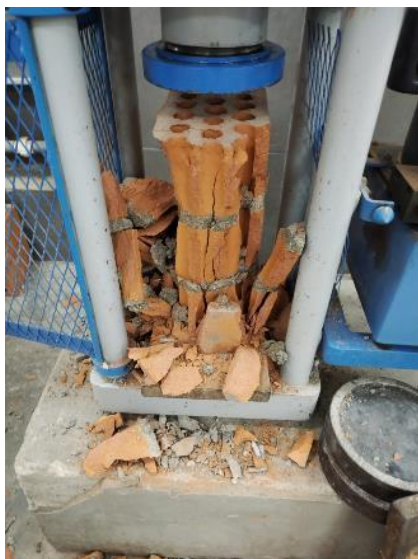
Imagen 69: Falla en la parte frontal de la pila P5- MM 1:3 (5%CLA)
