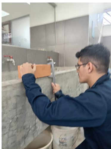
Imagen 39: Medida del alto del ladrillo
