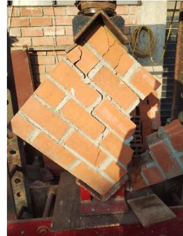
Imagen 95: Falla en murete M12-MM 1:3 (15%CLA)
