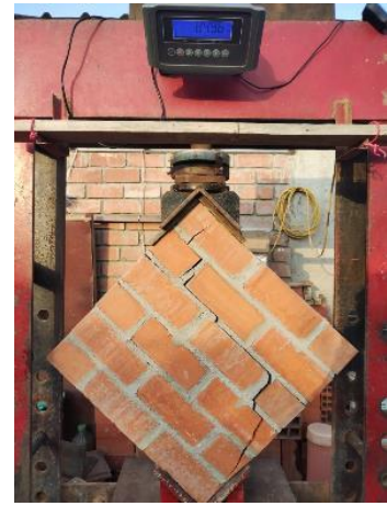
Imagen 86: Falla en murete M3-Muestra patrón 1:3
