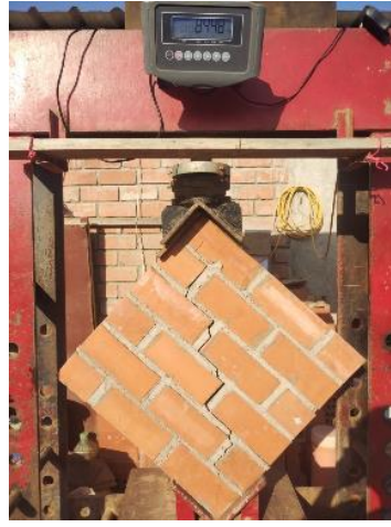
Imagen 94: Falla en murete M11-MM 1:3 (15%CLA)
