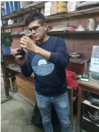
Anexo 42.3. Removiendo las partículas de ceniza dentro del frasco de Chatelier
