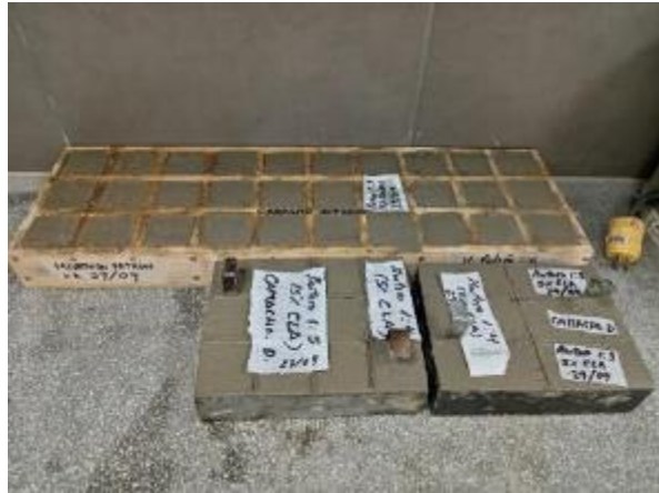
Anexo 11: Muestra cubicas de mortero listas para el secado
