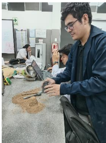
Imagen 25: Muestra superficialmente seca
