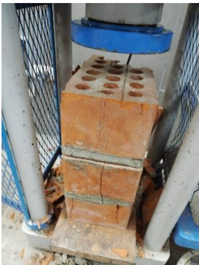
Imagen 67: Falla en la parte frontal de la pila P4- MM 1:3 (5%CLA)
