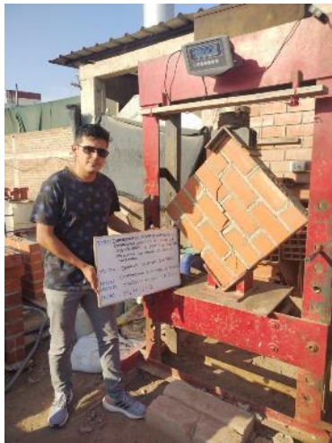
Imagen 87: Falla en murete M4-MM 1:3 (5%CLA)
