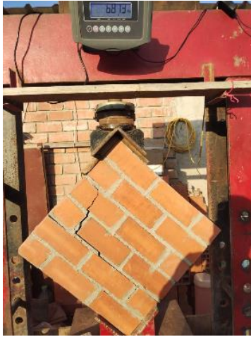
Imagen 93: Falla en murete M10-MM 1:3 (15%CLA)
