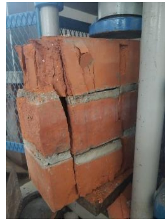
Imagen 78: Falla en la parte lateral de la pila P9- MM 1:3 (10%CLA)
