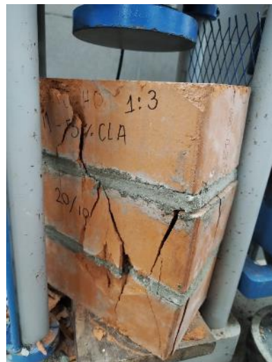
Imagen 68: Falla en la parte lateral de la pila P4- MM 1:3 (5%CLA)
