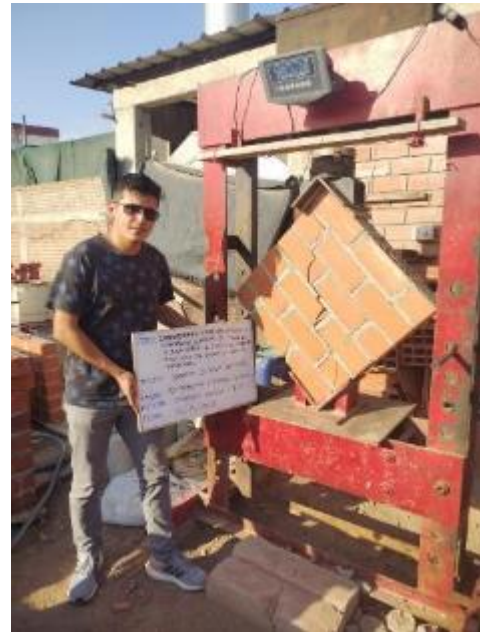
Anexo 51.2. Murete ensayado a compresión diagonal, modo de falla
