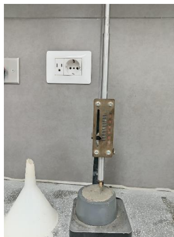
Imagen 34: Lectura de la penetración en el equipo de Vicat
