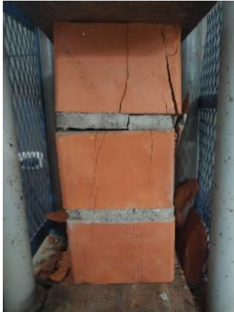
Imagen 75: Falla en la parte frontal de la pila P8- MM 1:3 (10%CLA)
