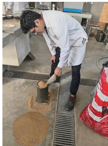
Imagen 14: Vaciado del agregado fino al ras del molde
