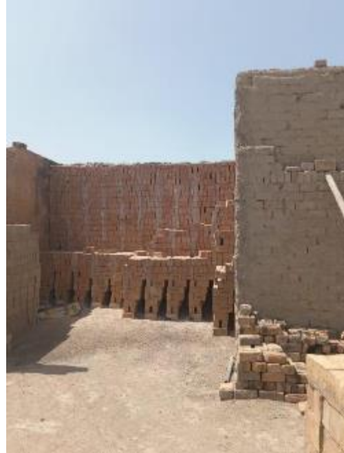
Anexo 13: Apilamiento de ladrillos artesanales en horno artesanal
