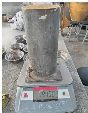
Imagen 20: Peso del molde + peso agregado compactado
