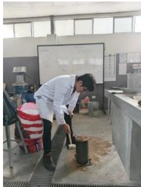
Anexo 44.4. Golpes con comba de goma para compactado de la muestra
