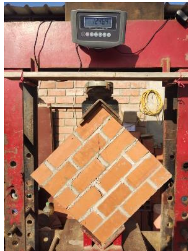
Imagen 88: Falla en murete M5-MM 1:3 (5%CLA)
