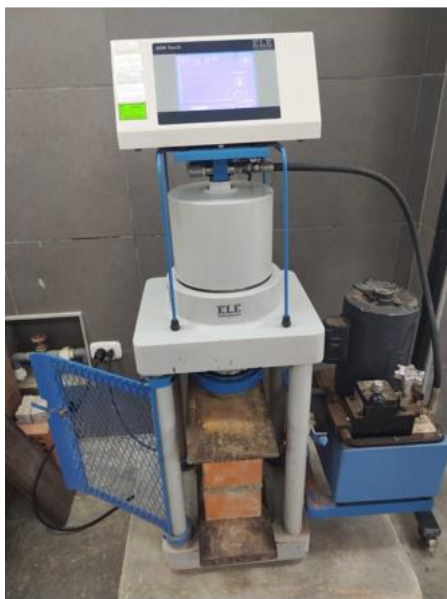
Imagen 50: Colocación de pila en la máquina de compresión
