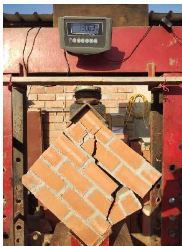
Imagen 91: Falla en murete M8-MM 1:3 (10%CLA)
