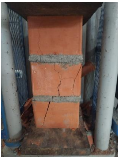
Imagen 73: Falla en la parte frontal de la pila P7- MM 1:3 (10%CLA)
