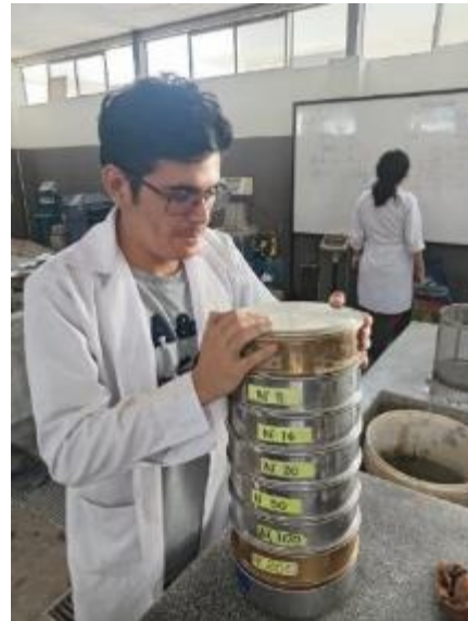
Anexo 43.2. Tamizado del agregado fino
