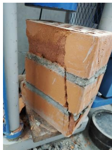
Imagen 66: Falla en la parte lateral de la pila P3- MP 1:3
