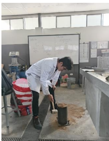
Imagen 19: Compactado mediante martillo de goma
