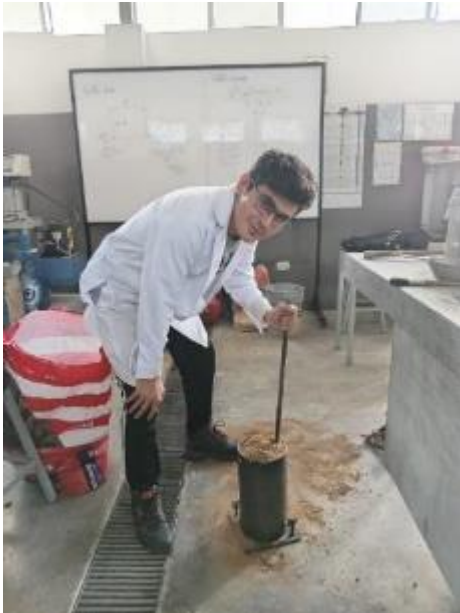
Anexo 44.3. Varillado de la muestra
