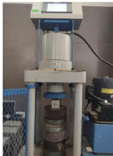
Imagen 36: Colocación del mortero en la máquina de compresión
