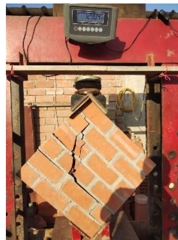
Imagen 92: Falla en murete M9-MM 1:3 (10%CLA)
