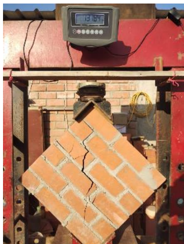
Imagen 90: Falla en murete M7-MM 1:3 (10%CLA)
