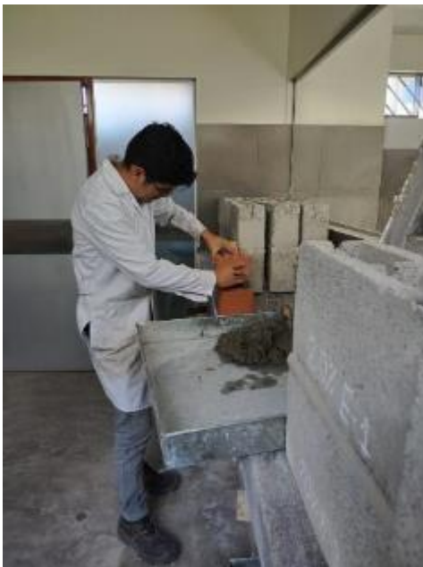
Anexo 52.1. Construcción de pilas para ensayo de adherencia
