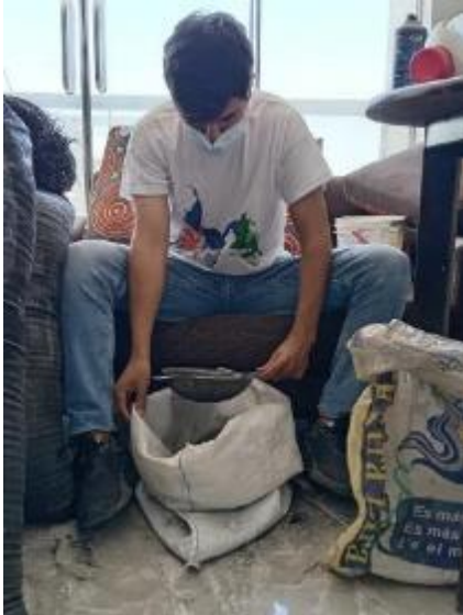
Anexo 42.1. Eliminación de impurezas a la ceniza
