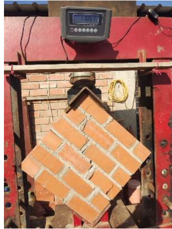
Imagen 85: Falla en murete M2-Muestra patrón 1:3
