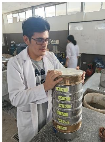
Imagen 11: Tamizado de la muestra
