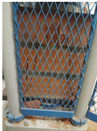
Imagen 64: Falla en la parte lateral de la pila P2- MP 1:3
