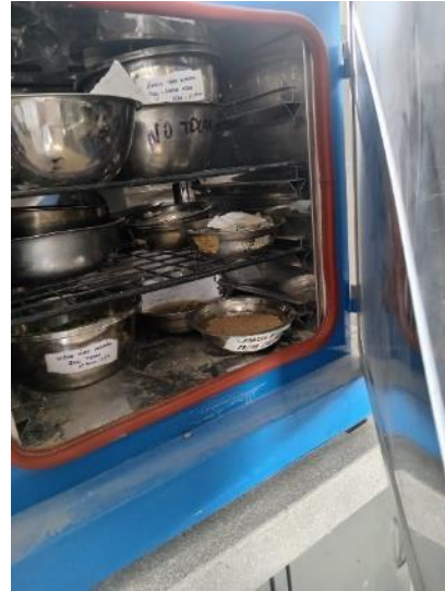
Anexo 42.2. Muestra dentro del horno de secado
