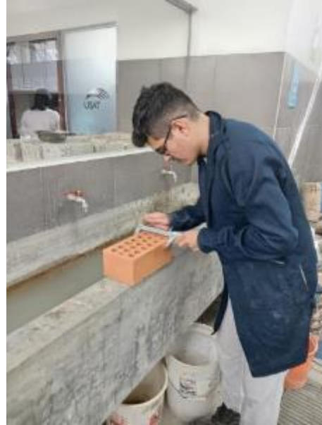
Anexo 49.6. Toma de las longitudes del ladrillo para medir su variación dimensional
