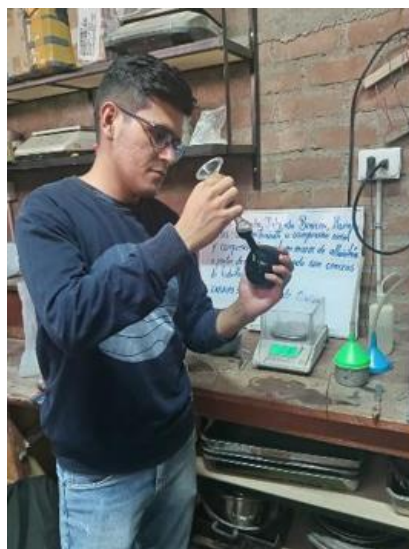
Imagen 6: Inserción de la ceniza dentro del frasco de Chatelier
