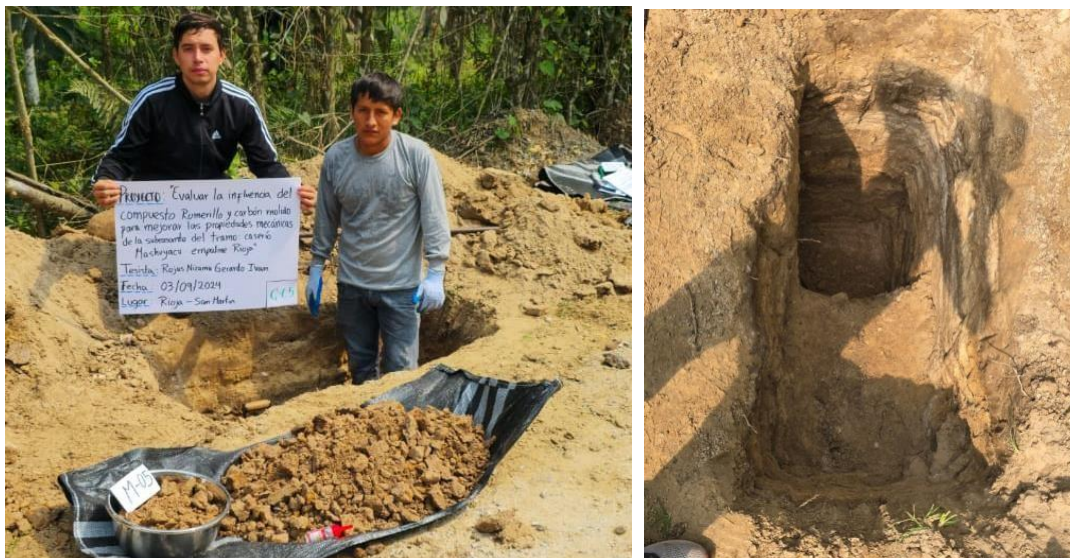
Ilustración 11: Extracción de muestra, calicata C-05
