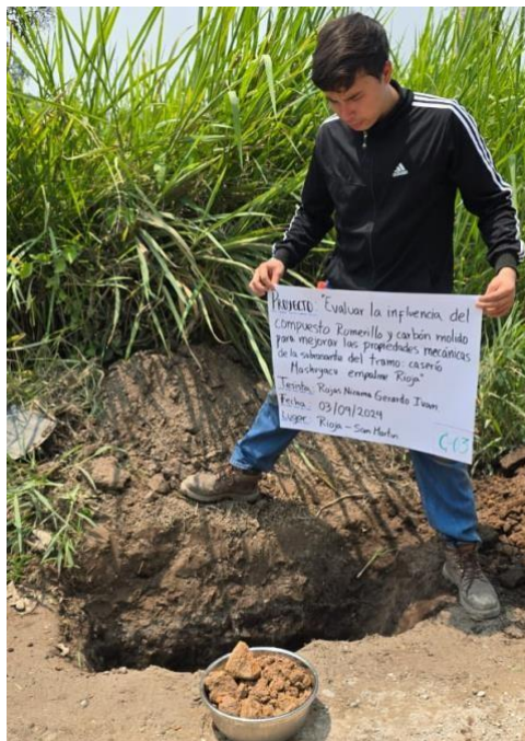
Ilustración 9: Extracción de muestra, calicata C-03
