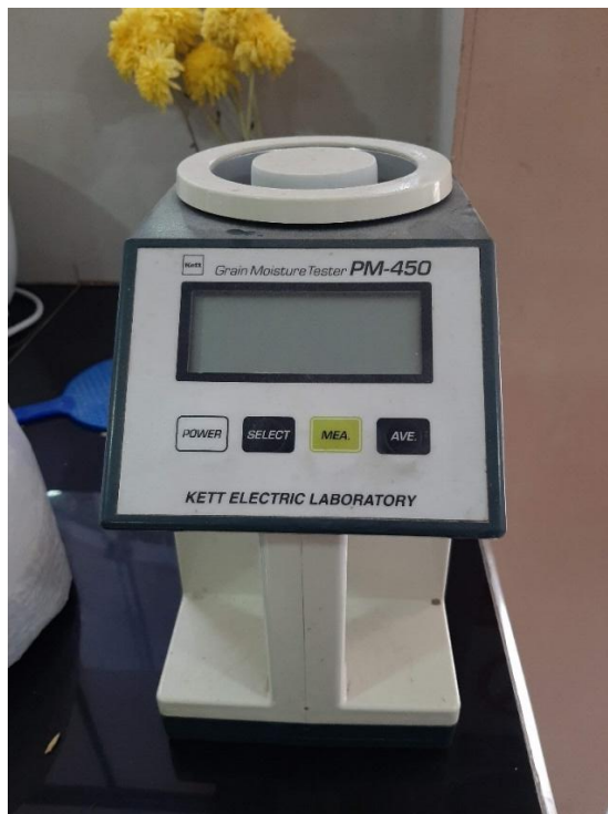
Figura 14: Detector de humedad de arroz
