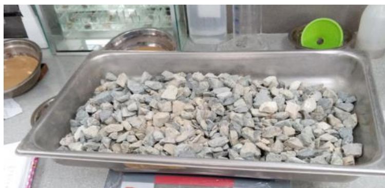
Imagen 4: Contenido de Humedad del árido Grueso
