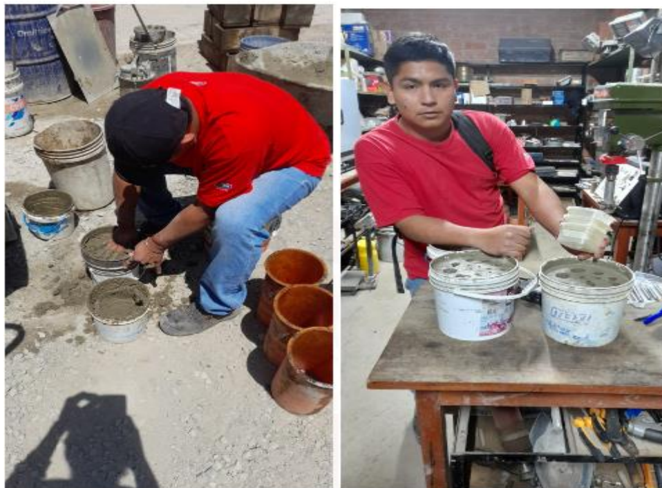
Imagen 13: Ensayo de tiempo de fraguado
