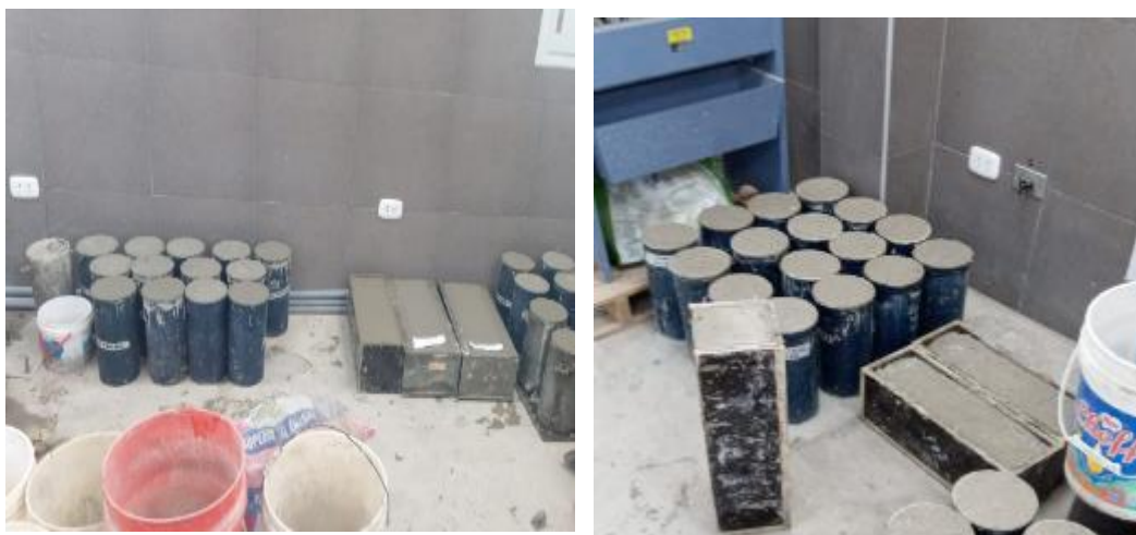
Imagen 16: Elaboración de las probetas llenadas.
