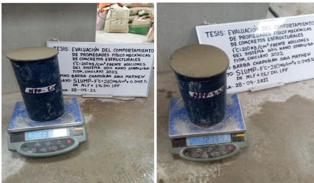
Imagen 15: Peso del concreto con los adicionantes
