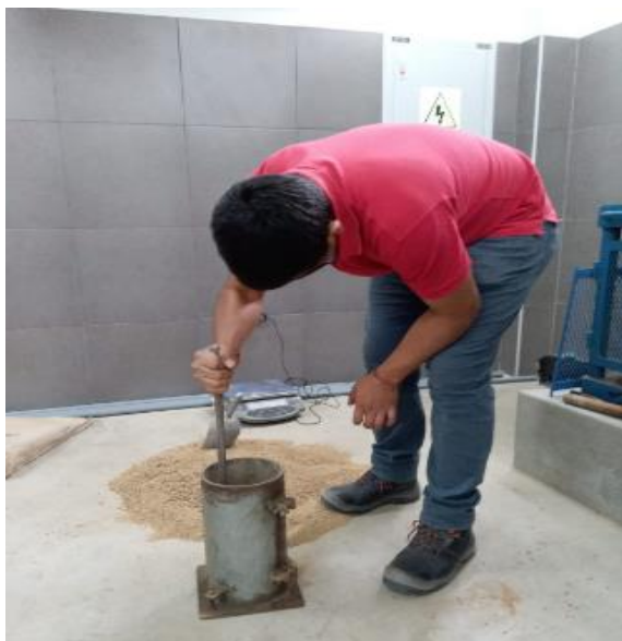
Imagen 12: Agregado fino compactado
