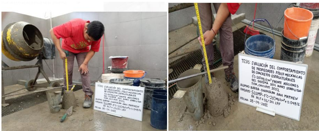
Imagen 14: Asentamiento de la mezcla patrón
