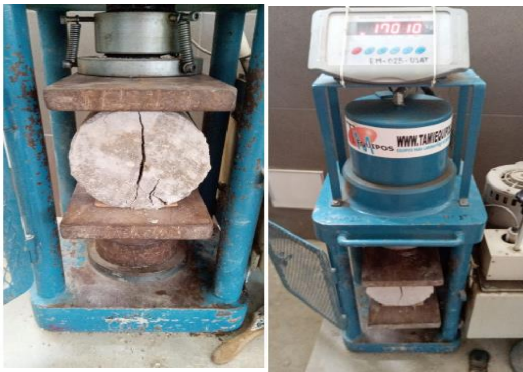
Imagen 19: Ensayando los especímenes a tracción
