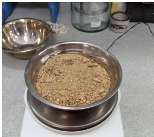
Imagen 3: Contenido de Humedad del árido Fino
