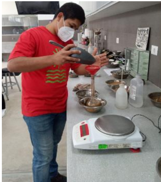
Imagen 5: P. Específico de los áridos
