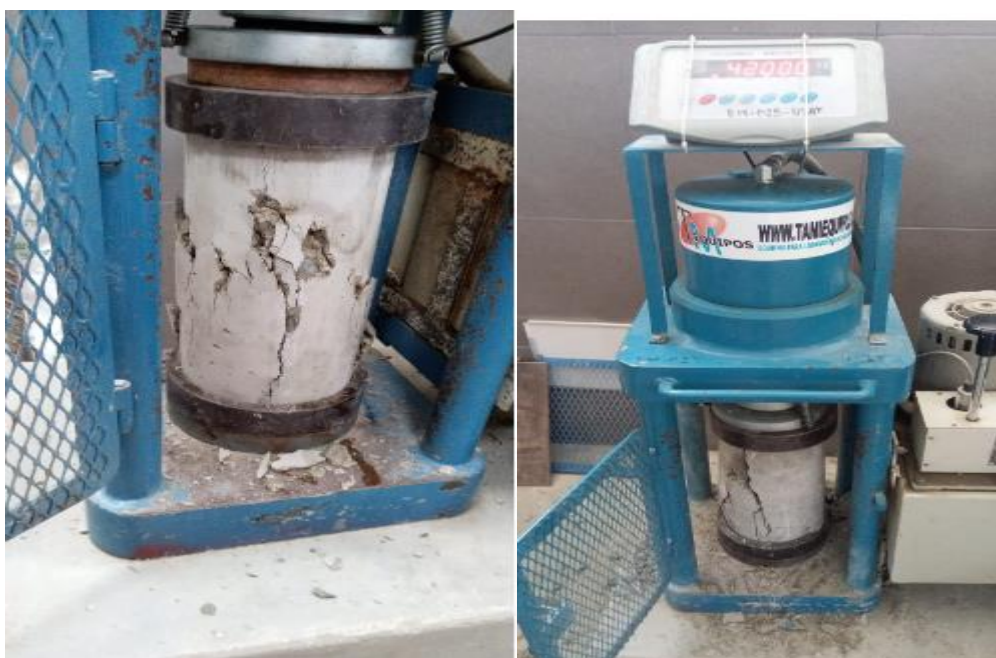
Imagen 17: Ensayo de resistencia a compresión con los adicionantes
