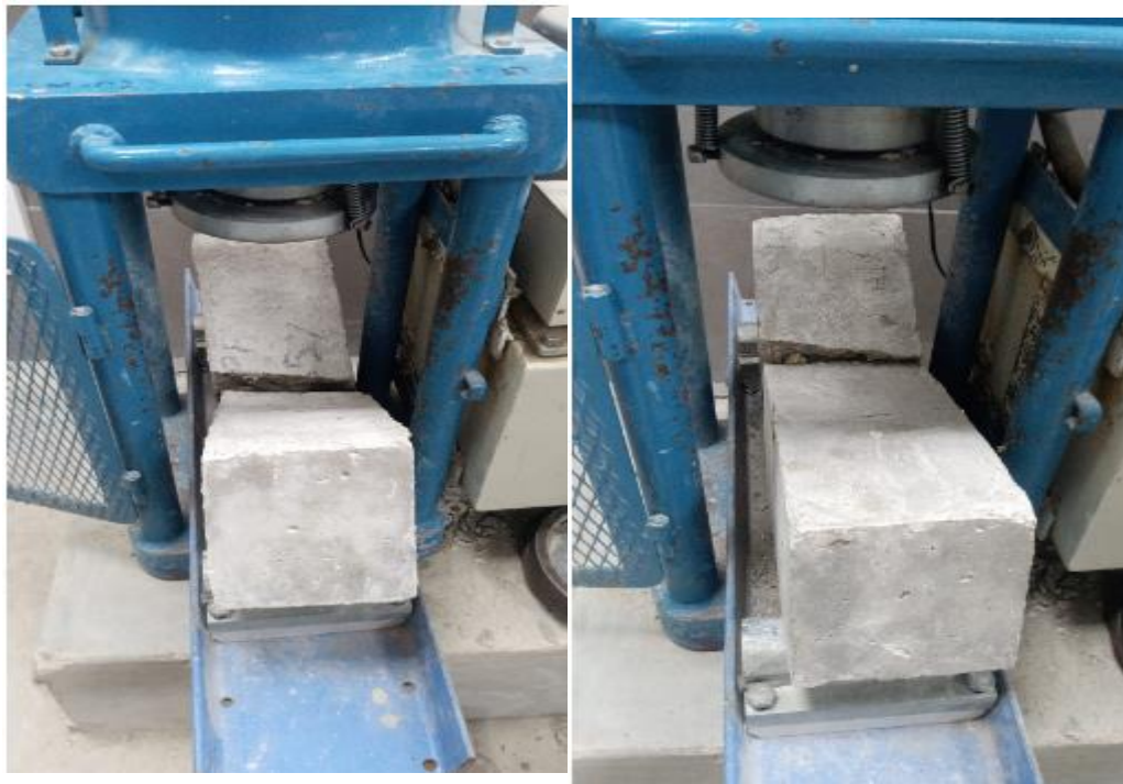
Imagen 20: Ensayo de flexión de vigas
