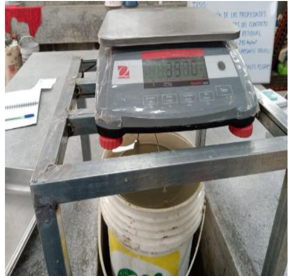
Imagen 7: Grado de Absorción del árido grueso
