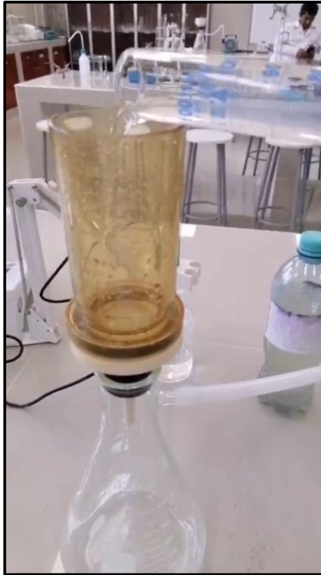
Fig. 104. Vaciado de las muestras en el Kitasato para la separación de sólidos
