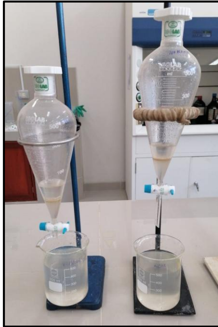
Fig. 110. Evidencia de ambas muestras y su extracción de grasas
