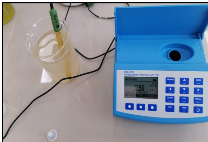
Fig. 113. Lecturas para determinar el pH (se realizó con el pHímetro)
