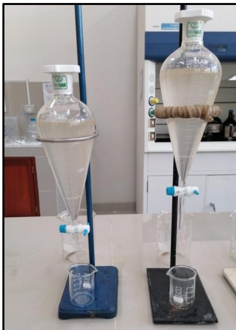
Fig. 108. Inicio de la separación de aceites y grasas de las muestras respectivas
