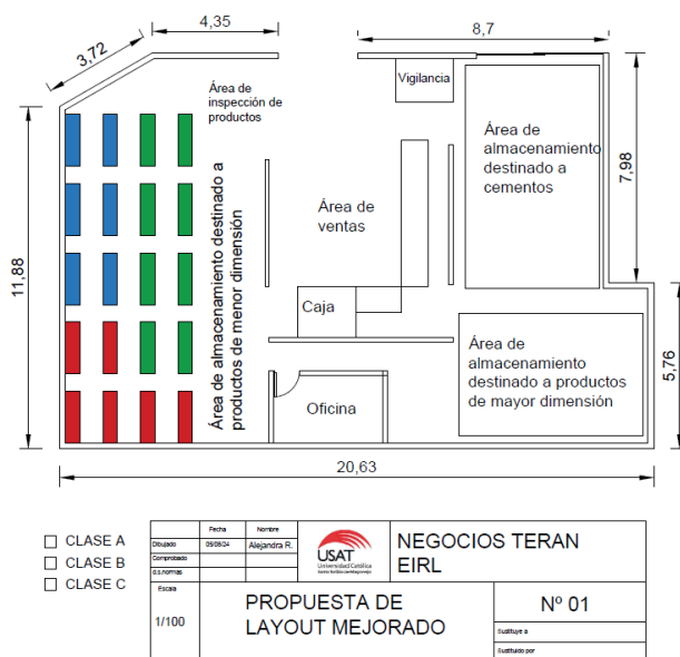
Figura 5. Distribución propuesta de layout de almacén en función a clasificación ABC
