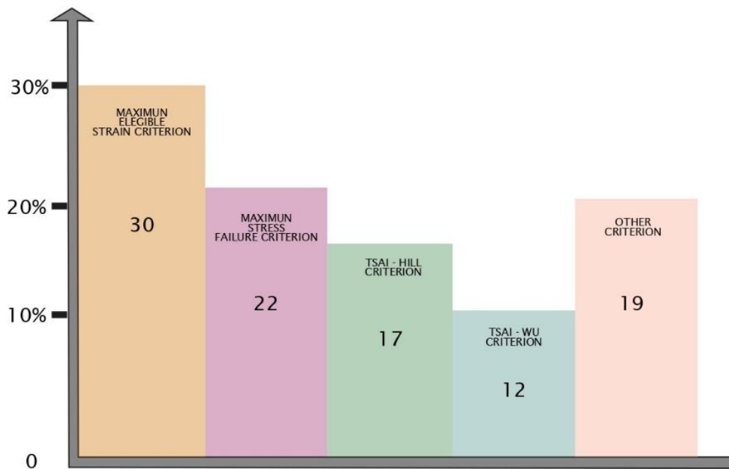
Fig. 10 uso de los criterios de fallo de los laminados en la industria aeroespacial. [28]
