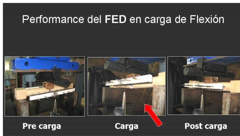
Figura 19: Performance del FED en carga de Flexión [14]
