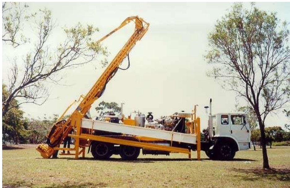
Figura 21: Equipo De Perforación Típico De 650 Mk2 Montado En Un Camión Con Compresor Montado A La Bandeja
