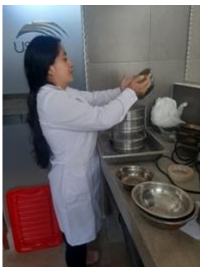
Ilustración 20: Realizando el ensayo granulométrico para el agregado fino
