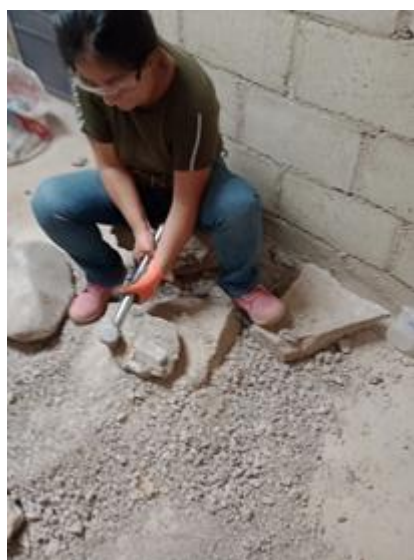
Ilustración 14: Reduciendo el tamaño de los bloques con comba
