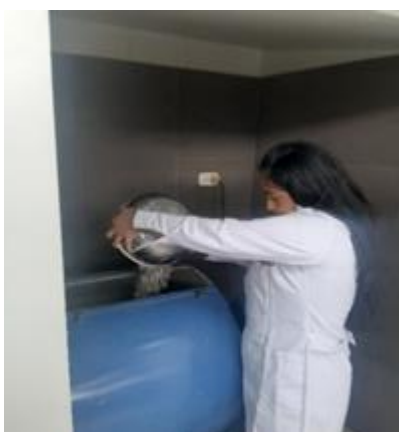
Ilustración 26: Agregando la piedra chancada a la máquina de abrasión de los ángeles
