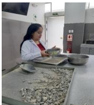
Ilustración 27: Agregado grueso después del proceso de abrasión, pasando el material por el tamiz N° 10
