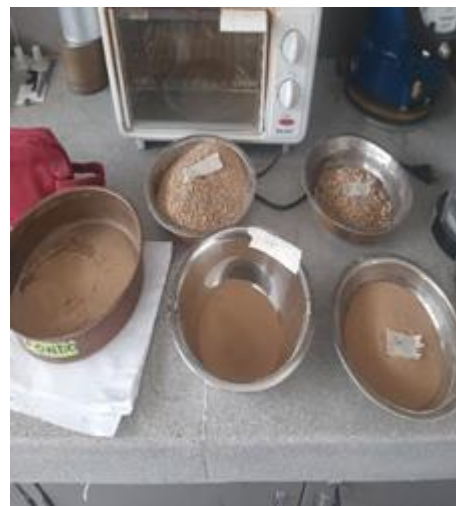
Ilustración 21: Resultado del agregado fino al pasarlo por los tamices correspondientes
