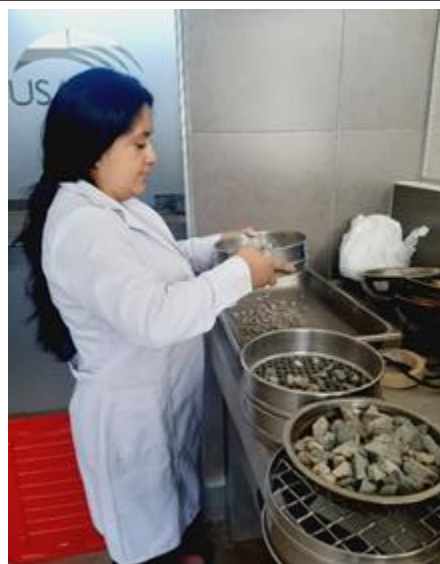
Ilustración 19: Realizando el ensayo de granulometría al agregado grueso
