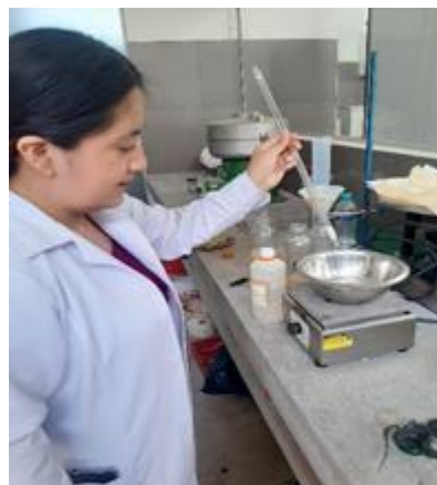
Ilustración 29: Agregando la solución química al agregado grueso
