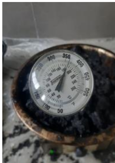
Ilustración 39: Temperatura tomada de la briqueta patrón 180°C
