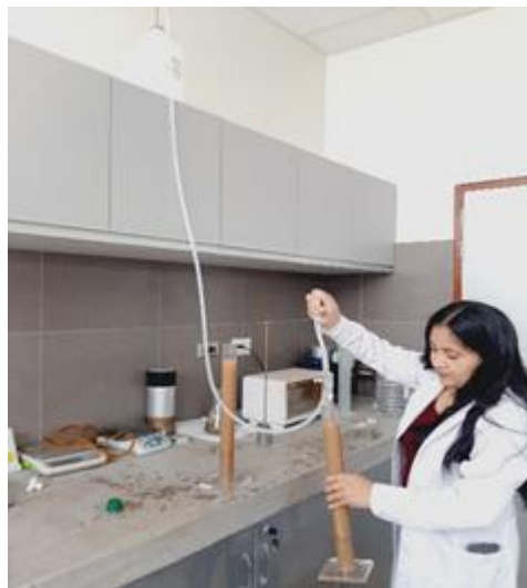
Ilustración 32: Realizando el ensayo de equivalente de arena
