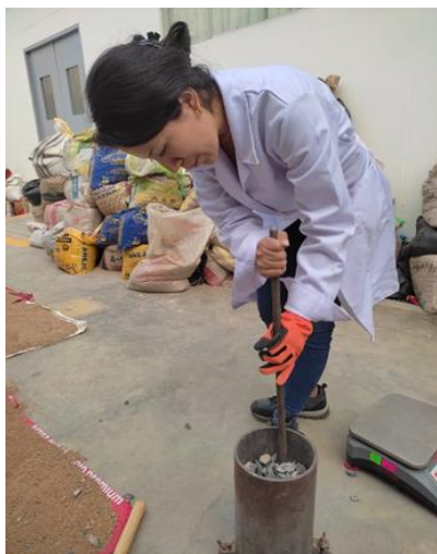
Ilustración 20: Apisonado con la varilla por 25 veces distribuidas en toda el área
