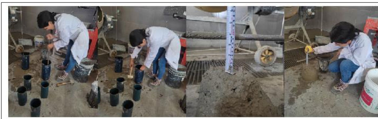
Anexo 40: Slump de diseño de muestra patrón +9% material fino
