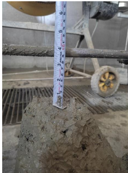
Ilustración 50: Slump de M.P +9% M. F
