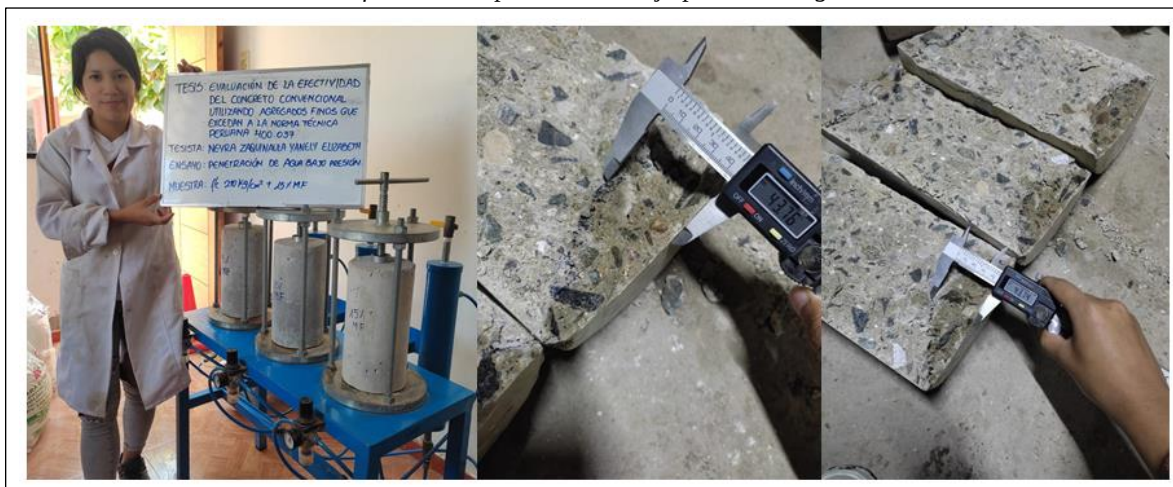
Anexo 58: Profundidad de penetración bajo presión de agua + 15% MF
