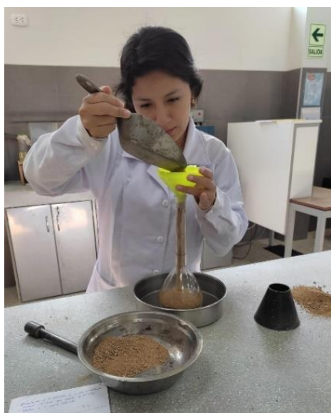
Ilustración 23: Colocación del A. F en la fiola utilizando un embudo
