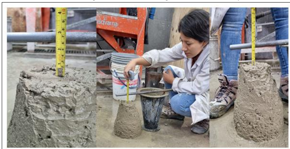
Anexo 42: Slump de diseño de muestra patrón +15% material fino
