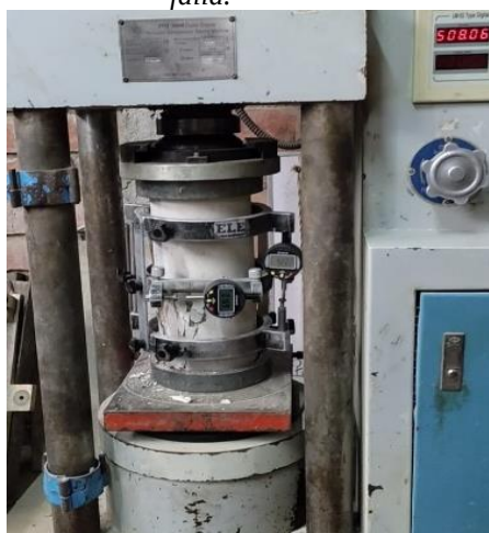
Ilustración 78: Deformaciones al momento de falla.
