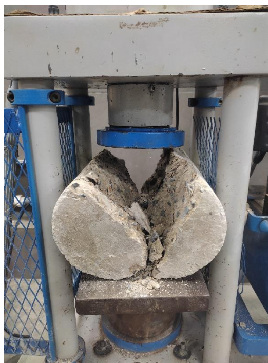
Ilustración 66: Falla del testigo en toda su longitud
