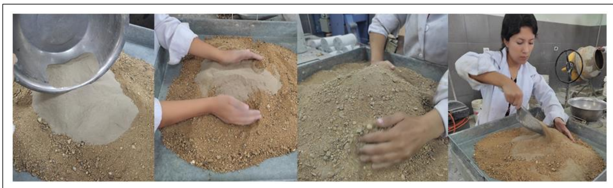
Anexo 45: Mezclado del agregado fino(arena) con el material fino
