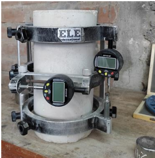
Ilustración 75: Colocación e instalación de los diales (compresometro-extensómetro).
