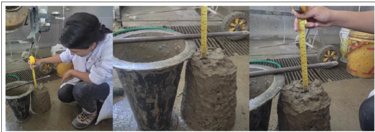
Anexo 41: Slump de diseño de muestra patrón +12% material fino
