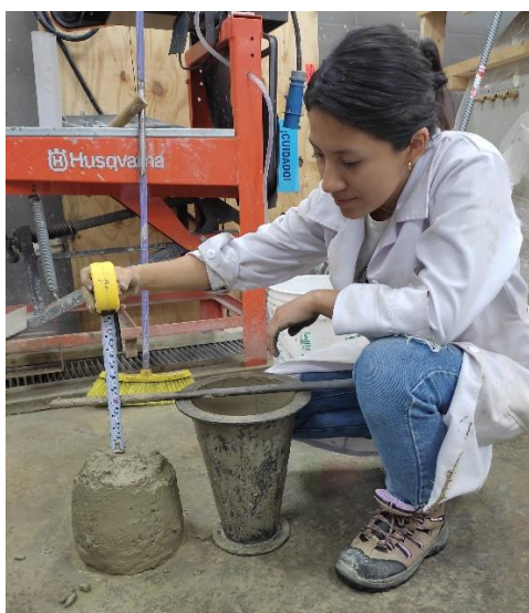
Ilustración 44: Medición del slump
