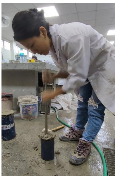
Ilustración 51: Varillado del concreto
