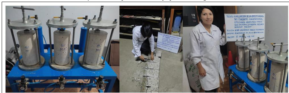
Anexo 59: Profundidad de penetración bajo presión de agua + 18% MF
