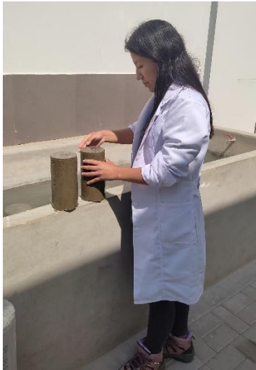
Ilustración 60: Retirado de probetas de la posa de curado
