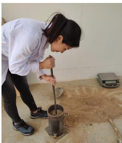
Ilustración 18: Apisonado con la varilla por 25 veces distribuida en toda el área
