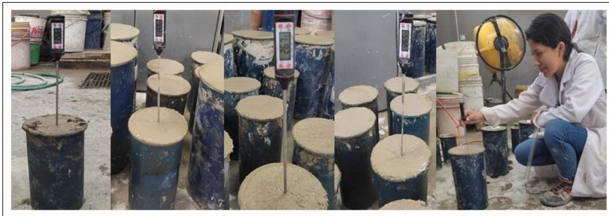
Anexo 44: Temperatura del concreto
