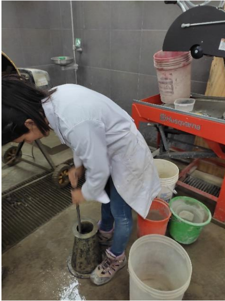
Ilustración 48: Varillado del concreto (25 veces por cada capa)
