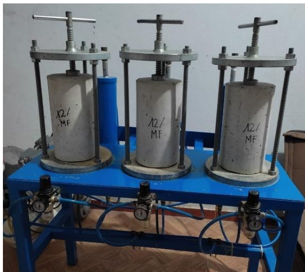
Ilustración 80: Probetas colocadas bajo presión de agua
