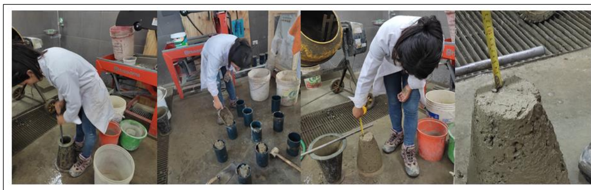
Anexo 43: Slump de diseño de muestra patrón +18% material fino
