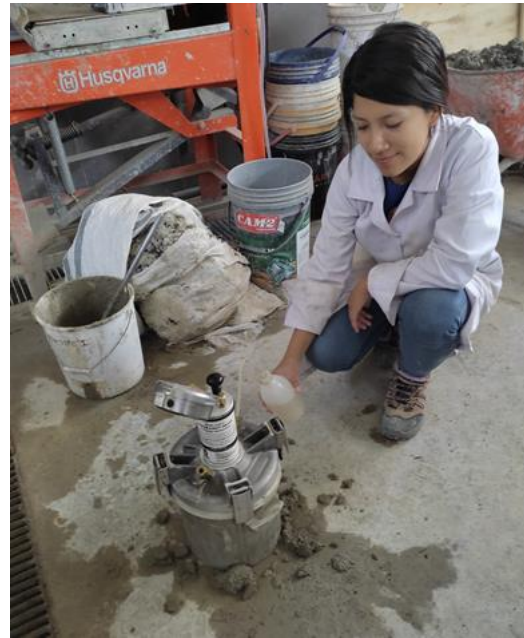
Ilustración 55: Introducción del agua por medio de una de las llaves de purga.
