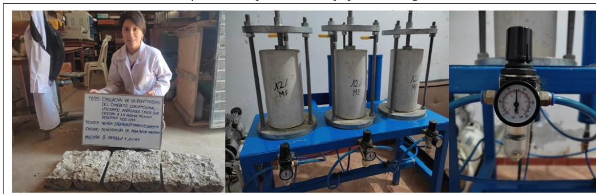
Anexo 57: Profundidad de penetración bajo presión de agua + 12% MF
