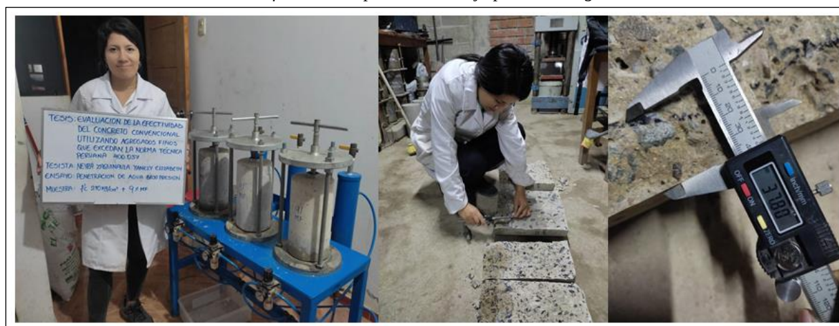
Anexo 56: Profundidad de penetración bajo presión de agua + 9% MF
