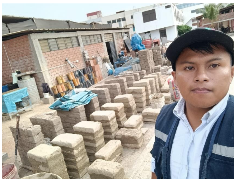
Figura 36.- Muretes para el ensayo de Compresión.
