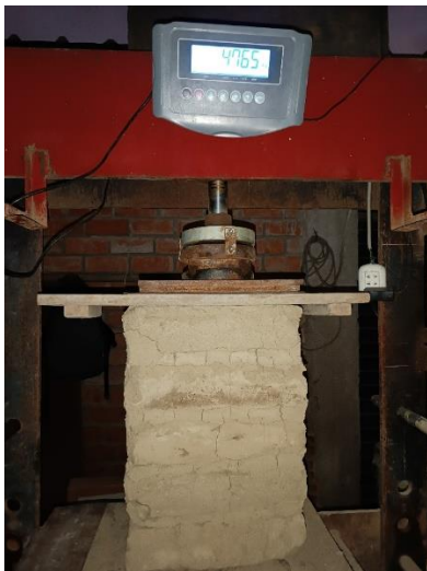
Figura 194.- Falla del murete estabilizado
