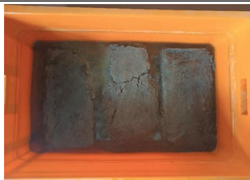
Figura 250.- Adobe mejorado sumergido en agua con T=14días
