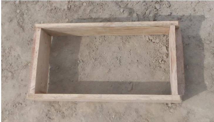
Figura 10.- Molde de los adobes
