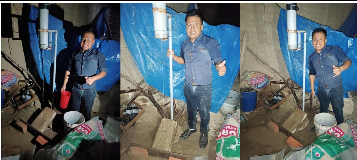
Figura 224.- Adobes mejorados durante el Ensayo a Erosión
