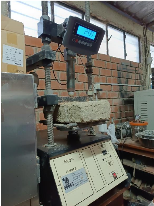
Figura 177. Parte lateral del adobe ensayado a flexión
