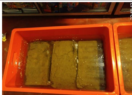
Figura 246.- Adobe mejorado sumergido en agua con T=2día+7hr
