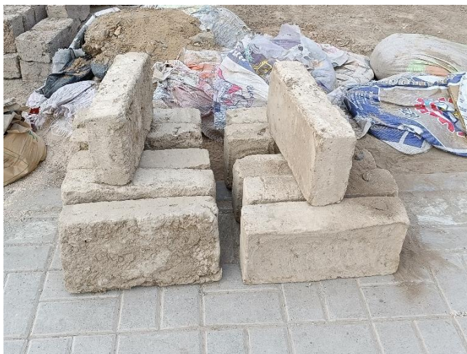
Figura 174.- Adobes antes de ser ensayados a flexión
