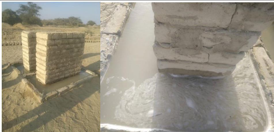
Figura 258.- Muro Tradicional luego de 30min de haber empezado el ensayo
