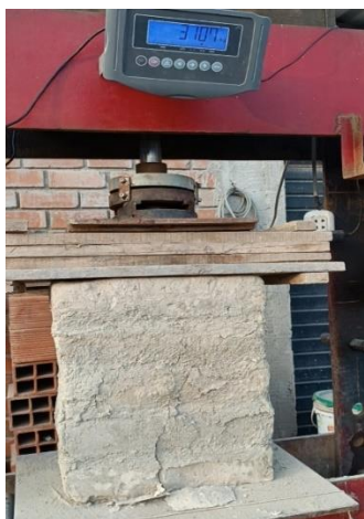
Figura 198.- Ensayo del murete Patrón a la compresión
