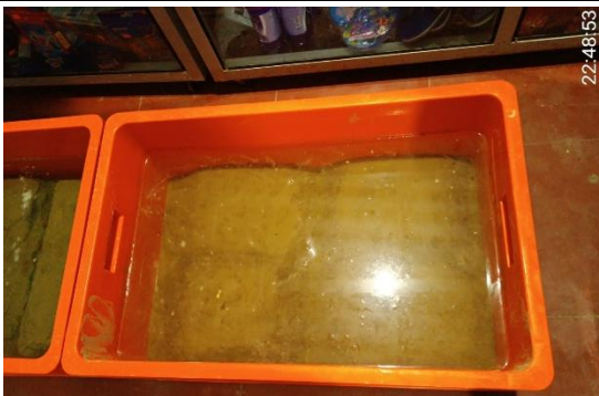
Figura 245.- Adobe tradicional sumergido en agua con T=2día+7hr
