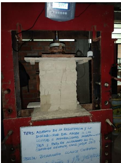
Figura 196.- Falla central del murete
