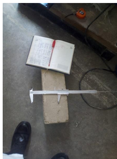
Figura 149.- Medición de vigas
