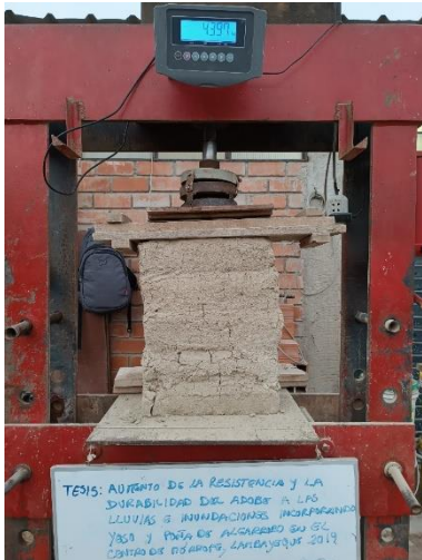
Figura 192.- Murete a compresión
