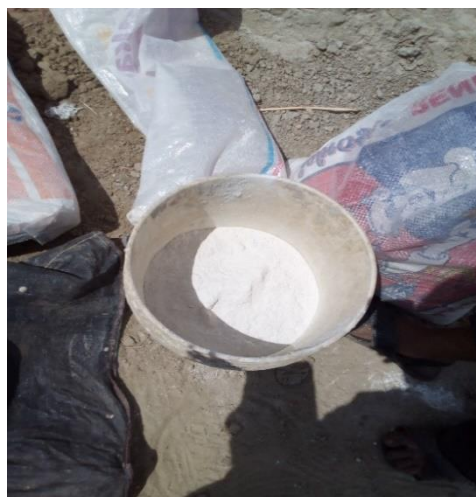
Figura 136.- Extracción de una porción de Yeso para el control de calidad
