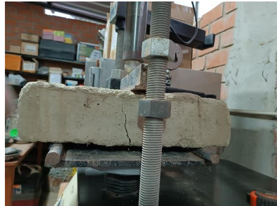
Figura 178.- Falla del adobe a flexión
