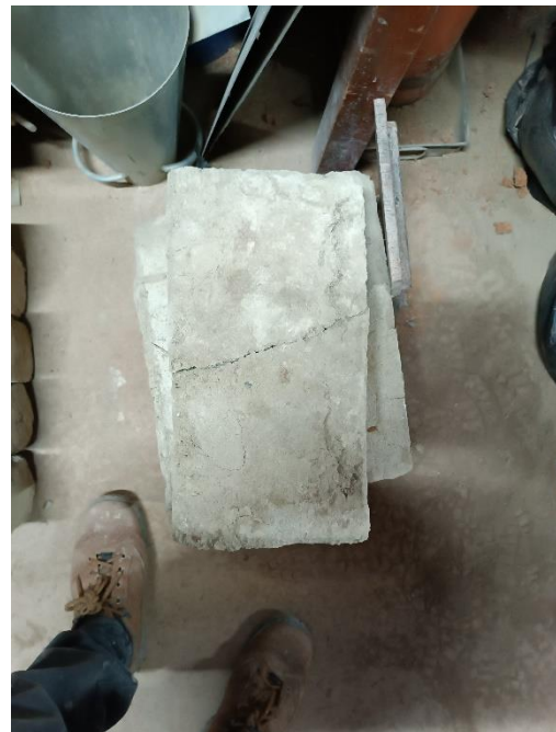
Figura 179.- Adobe post ensayo a flexión
