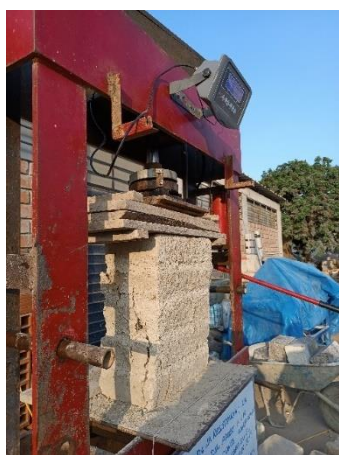
Figura 190.- Falla lateral del murete a compresión
