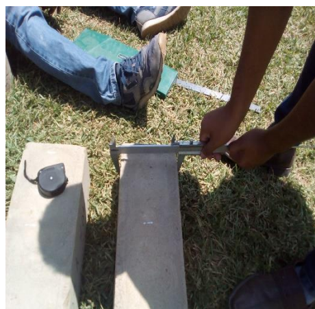
Figura 147.- Medición de Vigas
