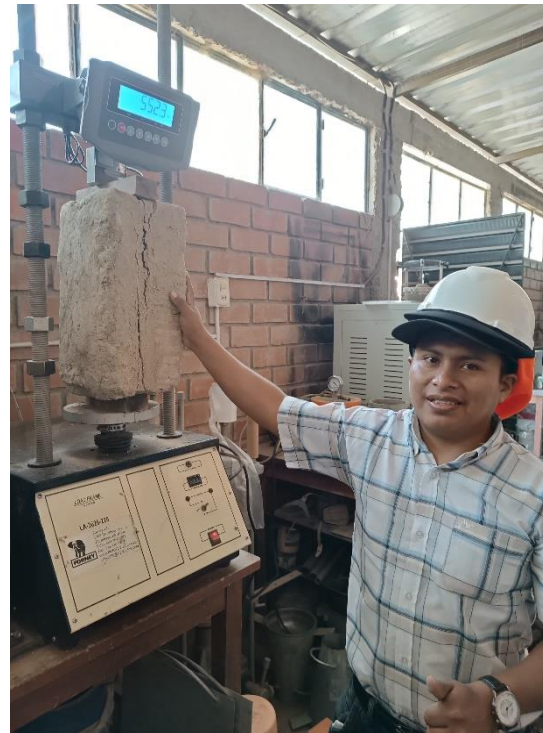
Figura 267.- Mortero durante el Ensayo
