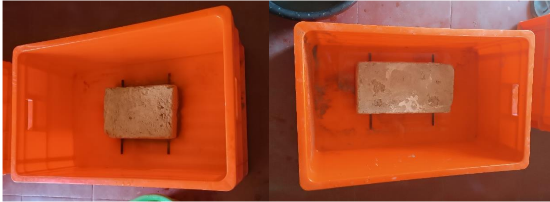
Figura 218.- Adobe sometido al agua
