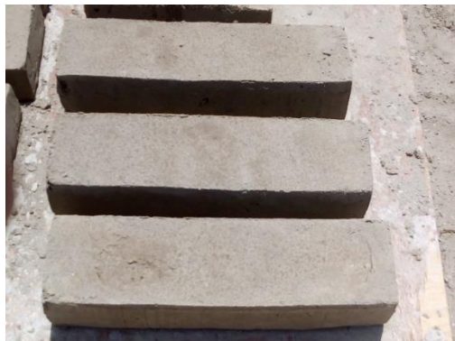
Figura 168.- Vigas en etapa de secado en la cantera
