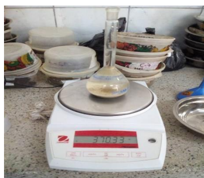
Figura 88.- Peso de fiola + agua + muestra(suelo).
