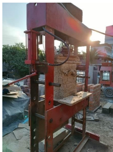
Figura 189.- Vista posterior del murete post ensayo
