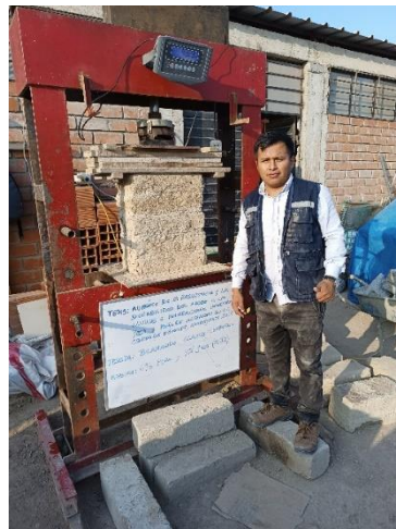
Figura 187.- Vista en perfil del murete a compresión
