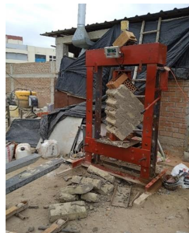
Figura 208.- Murete post ensayo
