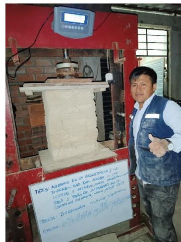
Figura 197.- Ensayo de Resistencia del Murete
