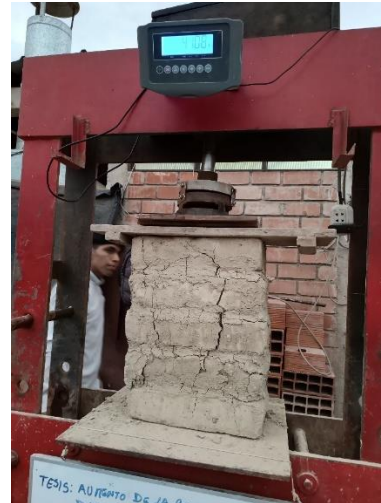
Figura 193.- Falla del murete a Compresión
