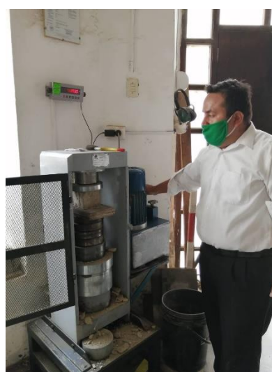
Figura 155.- Cubo de adobe ensayado
