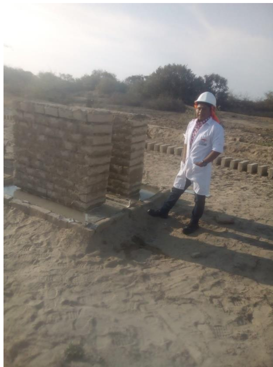
Figura 37.- Muretes para el ensayo de Inundación simulada
