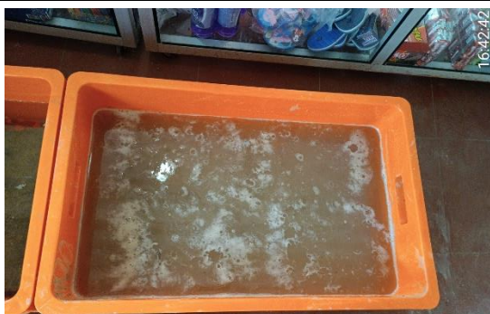
Figura 237.- Adobe tradicional sumergido en agua con T=1hora
