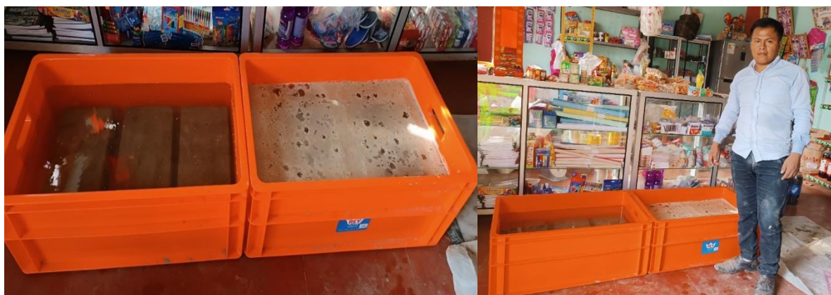
Figura 236.- Adobes durante el ensayo de Inmersión
