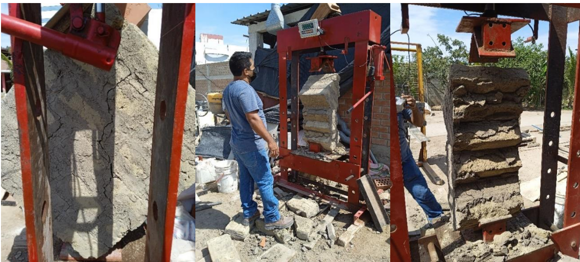
Figura 212.- Fallas del murete a tracción indirecta
