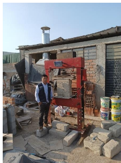
Figura 185.- Ensayo a la compresión del murete
