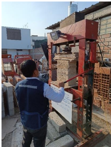
Figura 186.- Murete durante el ensayo a compresión
