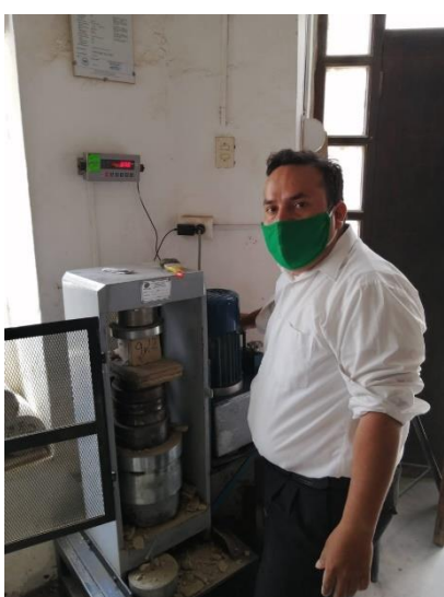
Figura 154.- Cubo de adobe durante el ensayo
