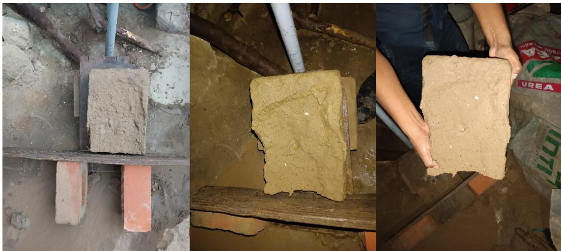
Figura 228.- Adobe tradicional post ensayo de Erosión
