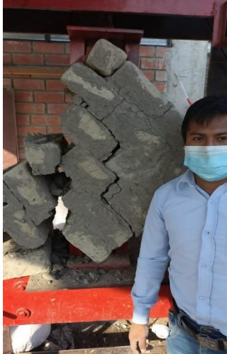
Figura 209.- Falla del murete a tracción indirecta
