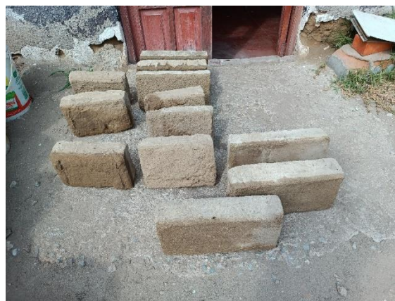
Figura 220.- Adobes post ensayo a succión
