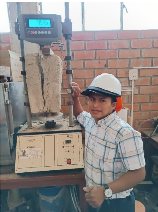
Figura 268.- Mortero Post Ensayo
