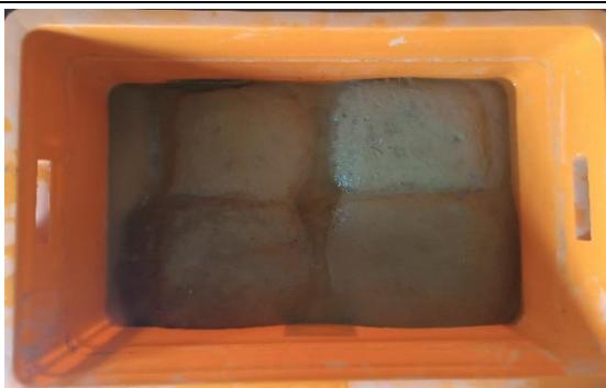
Figura 249.- Adobe tradicional sumergido en agua con T= 14días
