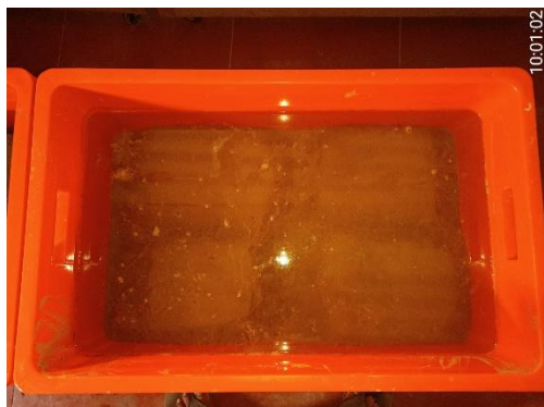
Figura 241.- Adobe tradicional sumergido en agua con T=18hora
