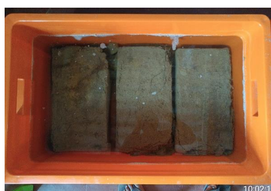
Figura 242.- Adobe mejorado sumergido en agua con T=18hora
