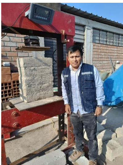
Figura 184.- Colocación del murete a la prensa
