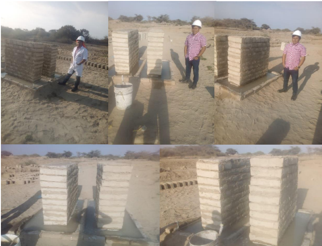
Figura 256.- Simulación a la Inundación de los Muretes
