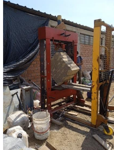
Figura 210.- Colocación del murete estabilizado a la prensa
