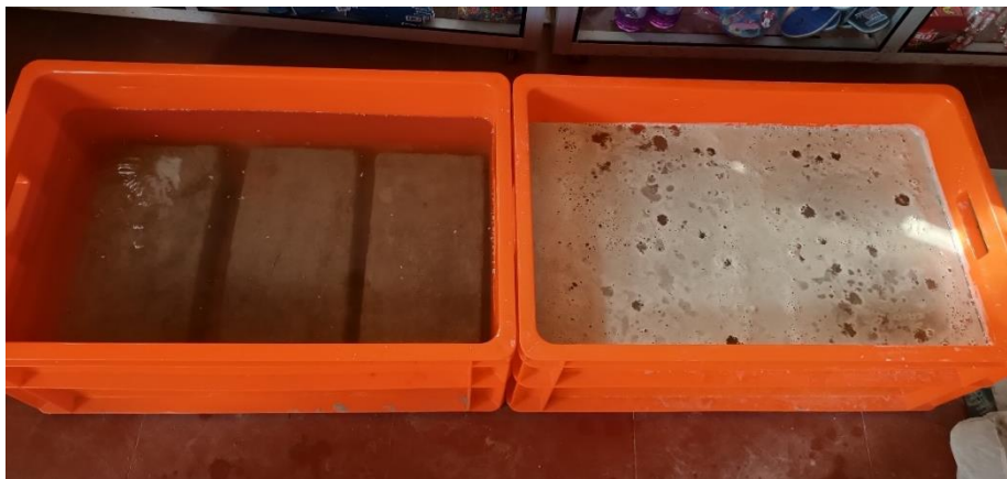
Figura 235.- Adobes sumergidos al agua T=5min
