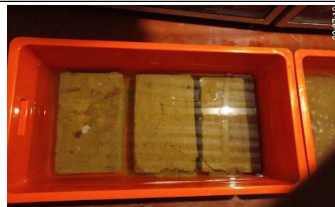
Figura 240.- Adobe mejorado sumergido en agua con T=7hora
