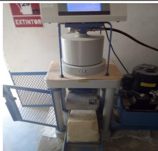
Figura 171.- Viga en vista de perfil ensayada a flexo tracción
