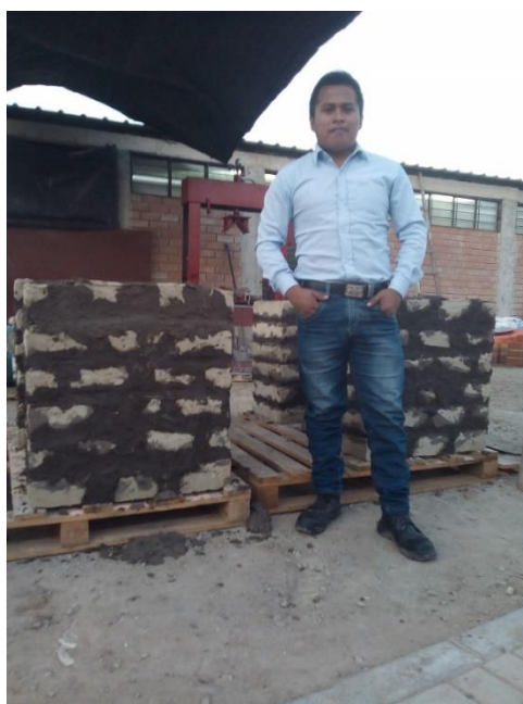
Figura 35.- Muretes para el ensayo Compresión Diagonal
