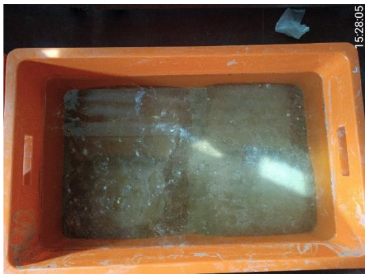
Figura 243.-Adobe tradicional sumergido en agua con T=1día
