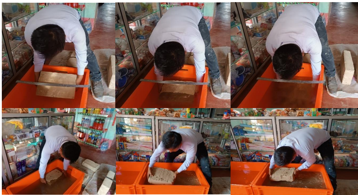
Figura 231.- Colocación de los Adobes Tradicionales a la cubeta de agua
