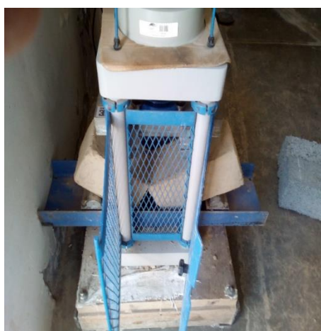
Figura 172.- Viga en vista lateral ensayada a flexo tracción.
