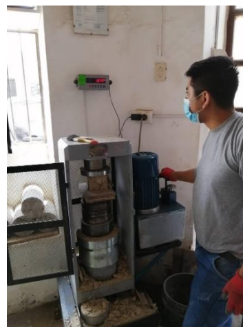
Figura 153.- Ensayo de la resistencia a la compresión
