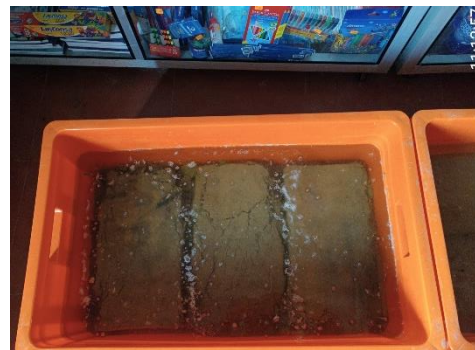
Figura 248.- Adobe mejorado sumergido en agua con T=2día+20hr
