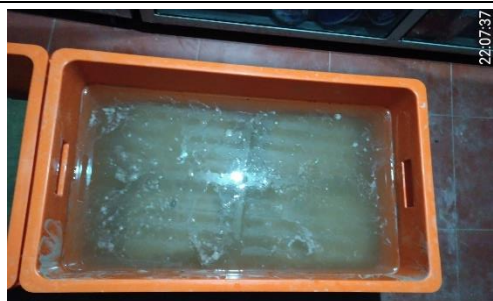
Figura 239.- Adobe tradicional sumergido en agua con T=7hora
