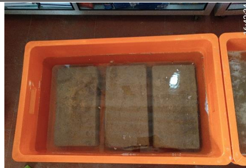
Figura 238.- Adobe mejorado sumergido en agua con T=1hora
