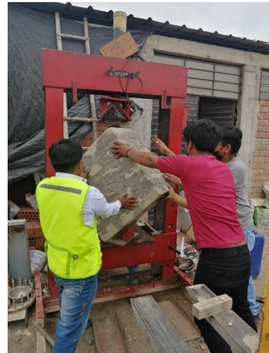
Figura 206.- Colocación del murete a la prensa
