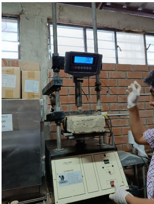
Figura 175.- Posicionamiento del adobe a la prensa del ensayo
