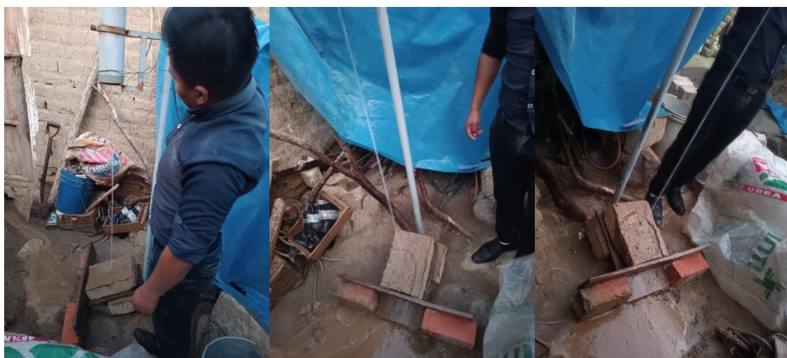
Figura 223.- Adobes tradicionales durante el Ensayo a Erosión
