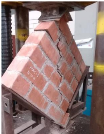
Fig. 6: Muros de Albañilería simples después de la prueba de corte
