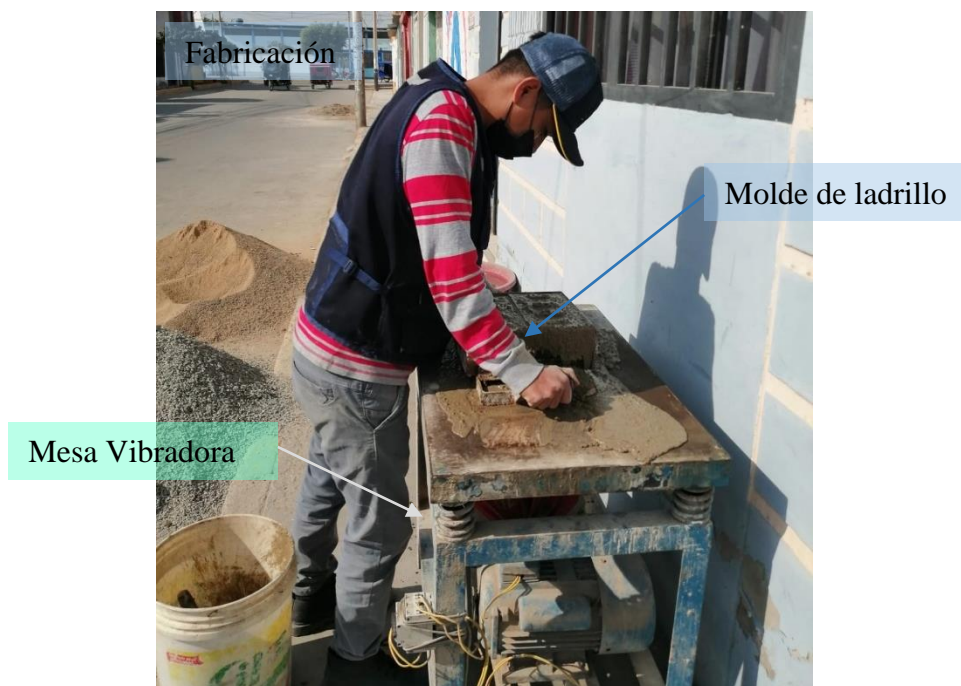
Fig. 21: Vibrado de ladrillo.
