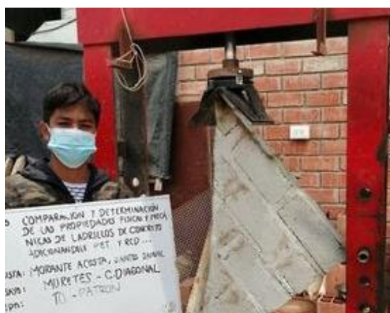
Fig. 32: Falla por Tracción diagonal en Murete.
