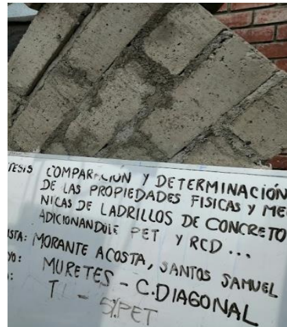
Fig. 34: Murete a Ensayar
