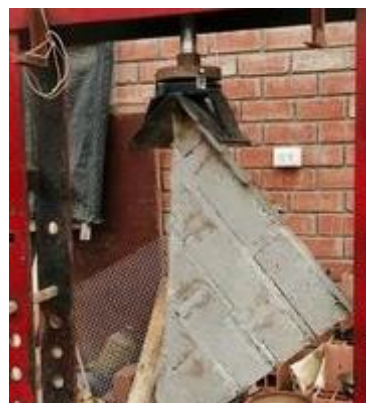
Fig. 38: Falla Tracción Diagonal
