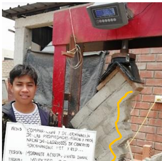
Fig. 31: Falla en Murete.
