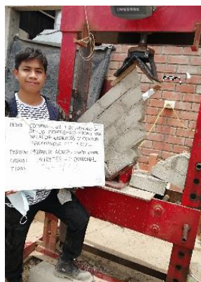
Fig. 37: Falla Tracción Diagonal
