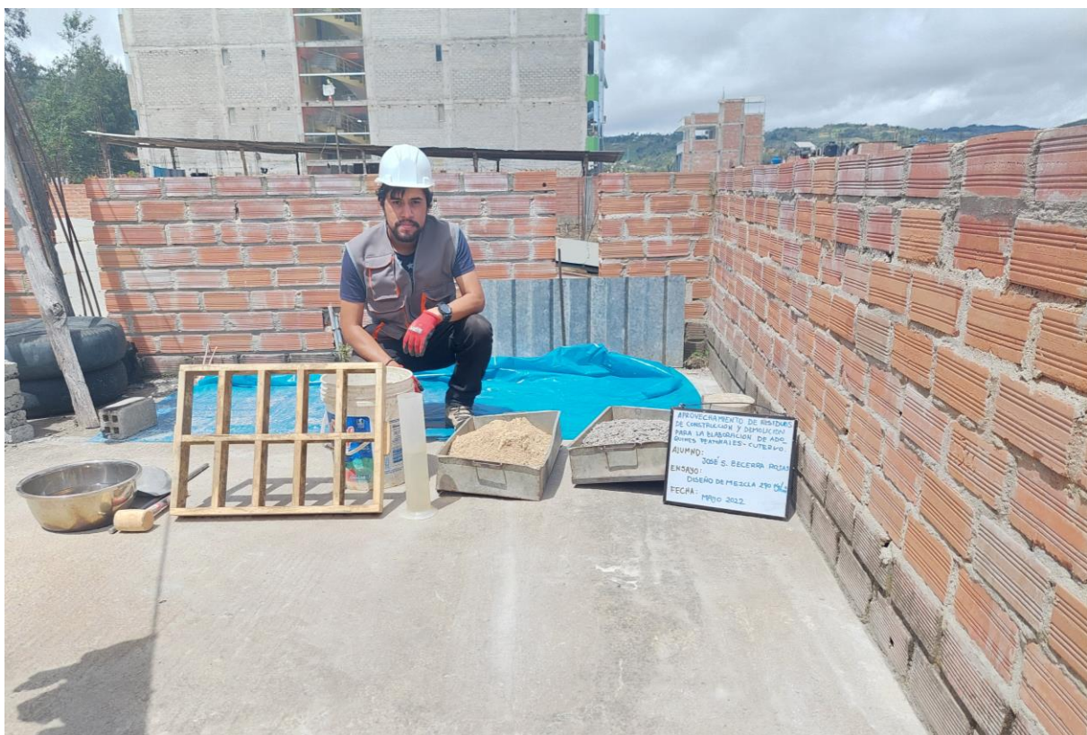
Imagen 06: Elaboración de los adoquines para los diferentes porcentajes.
