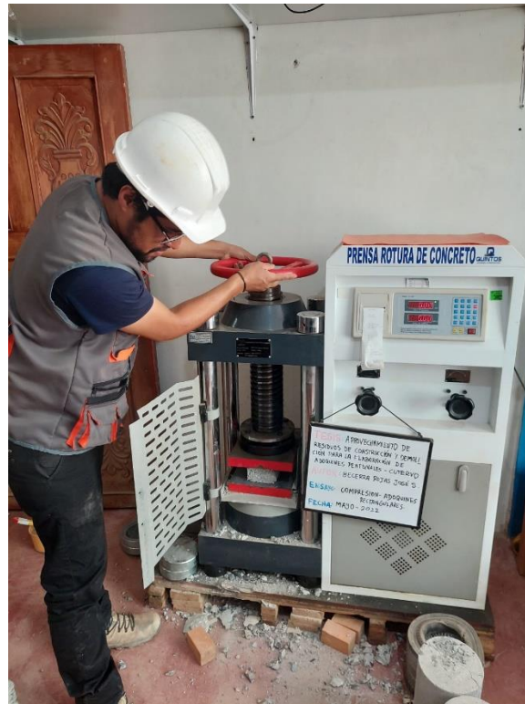
Imagen 11: Ensayo de compresión a los adoquines
