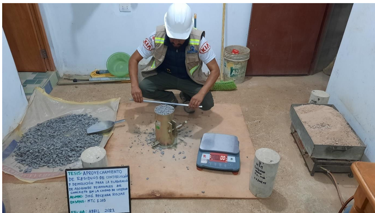
Imagen 04: Peso unitario varillado y sin varillar.
