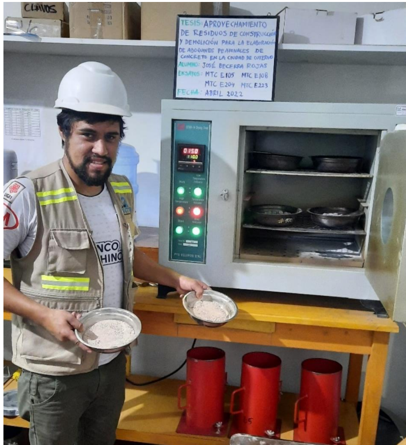
Imagen 01: Contenido de humedad agregado fino.
