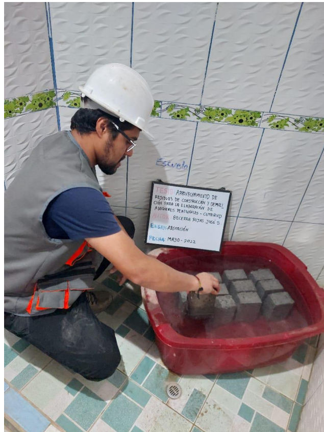
Imagen 08: Ensayo de Absorción para los diferentes adoquines.
