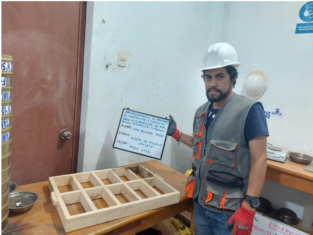
Imagen 05: Elaboración del molde para adoquines.
