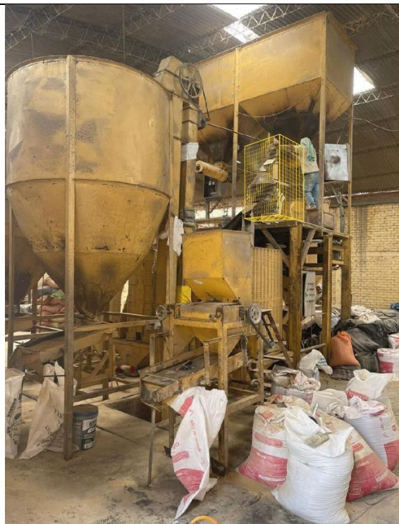
Mecanismo de transmisión por faja con guardia de seguridad
