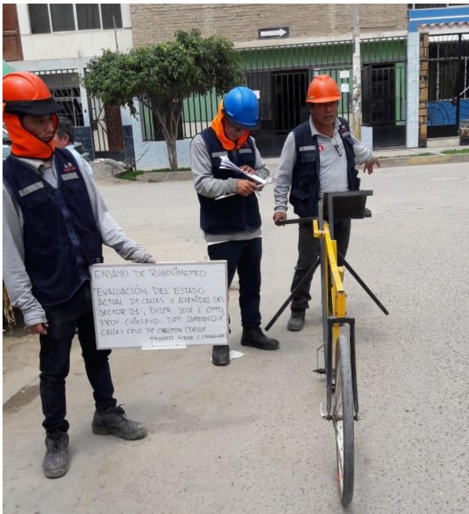
Ensayo de Rugosímetro de Merlin en Urb. Latina
