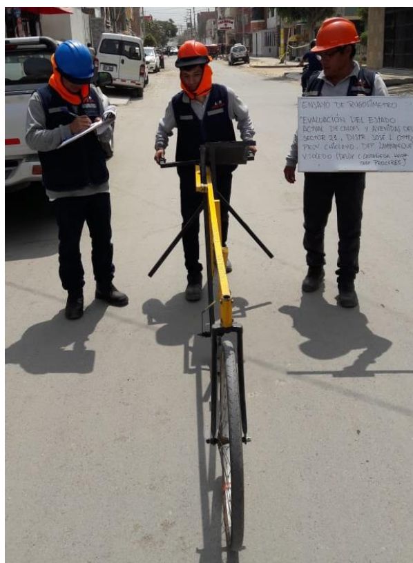
Ensayo de Rugosímetro de Merlin en Urb. Latina
