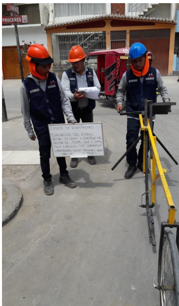
Ensayo de Rugosímetro de Merlin en Urb. Latina
