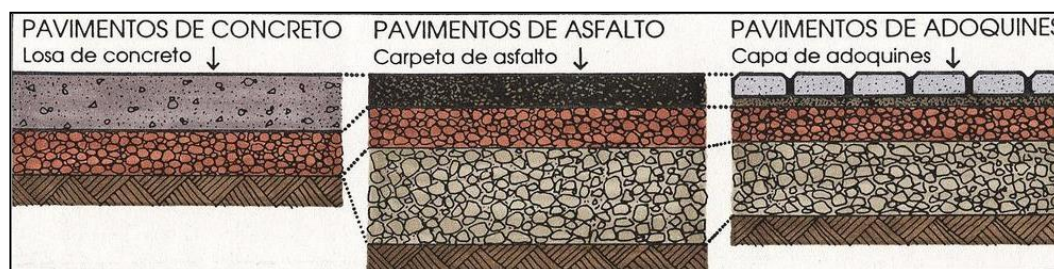
Figura N°01: Tipos de pavimentos
