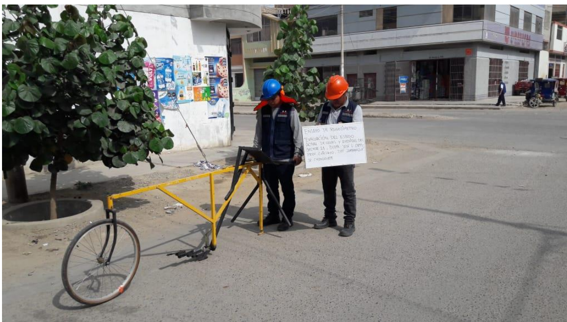
Ensayo de Rugosímetro de Merlin en Urb. Latina
