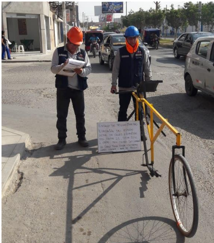
Ensayo de Rugosímetro de Merlin en Urb. Latina
