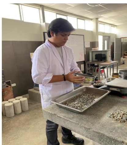
Ilustración 20 Tamizado Agr. Grueso Fuente: 26 E. Propia
