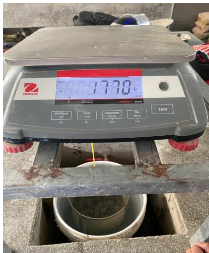
Ilustración 36: P. Muestra en Canastilla Fuente: 49 E. Propia
