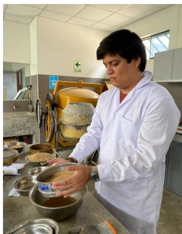
Ilustración 9: Tamizado Agr. Fino Fuente: 11 E. Propia
