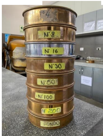
Ilustración 9: Tamizado Agr. Fino Fuente: 11 E. Propia
