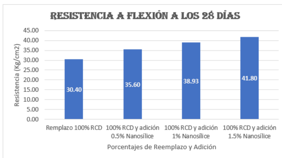
Gráfica 17: R. F. Concreto con reemplazo 100% RCD y adiciones de nanosílice
