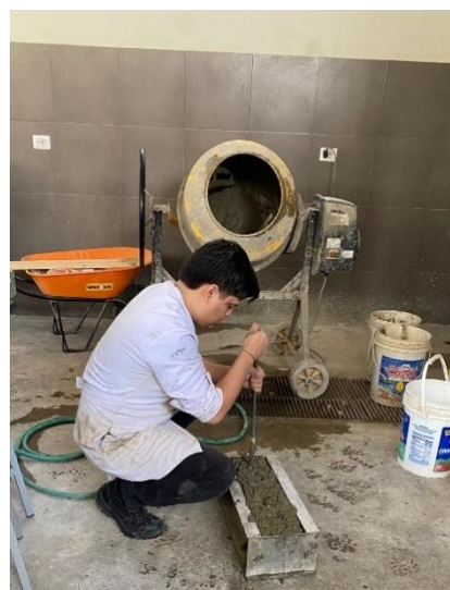
Ilustración 38: Elaboración de vigas Fuente 52: E. Propia
