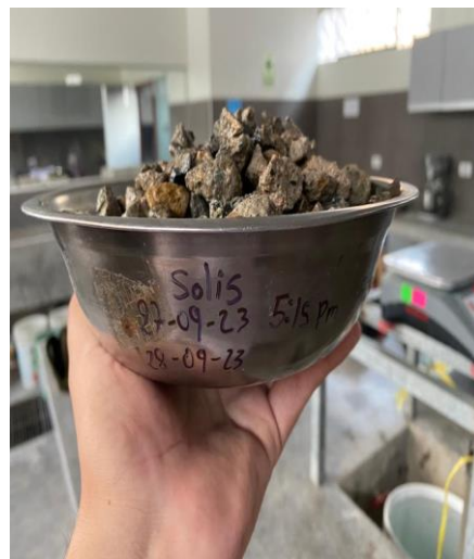
Ilustración 35: Muestra de RCD Fuente: 48 E. Propia
