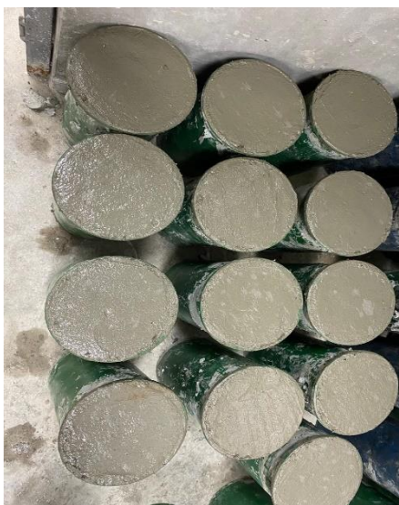
Ilustración 39: Elaboración de testigos Fuente 53: E. Propia
