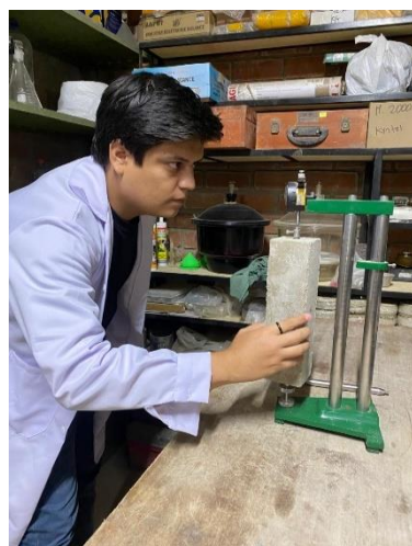
Ilustración 40: Toma de lecturas concreto expuesto a sulfatos
