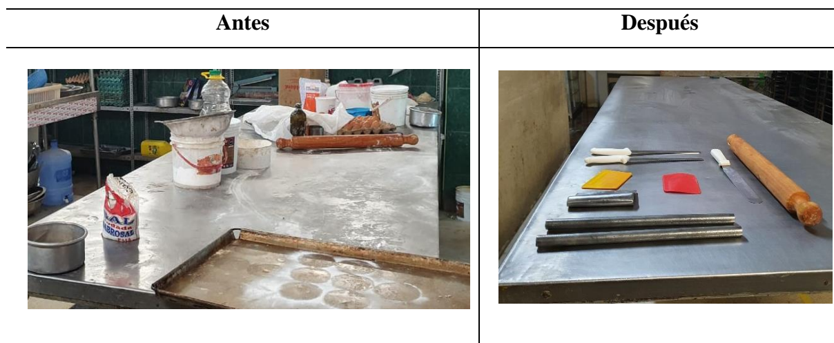
Figura 13. El antes de la mesa de trabajo y el después implementando la metodología 5s Fuente: Panadería Panottis
