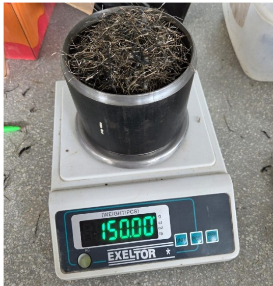
Fig.35. Masa de fibra de acero de neumático reciclado, en la briqueta.
