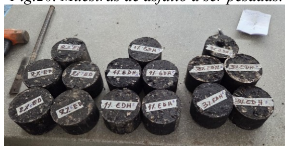
Fig.20. Muestras de asfalto a ser pesadas.
