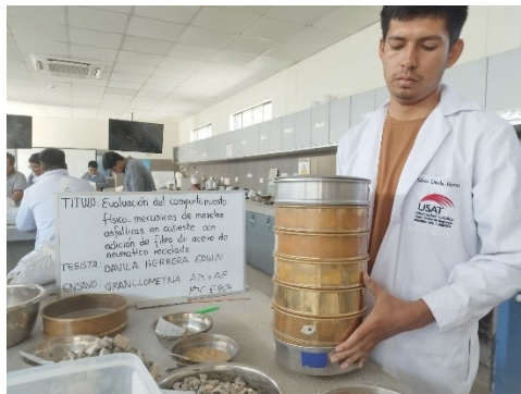
Fig.7. Ensayo de granulometría para agregados.
