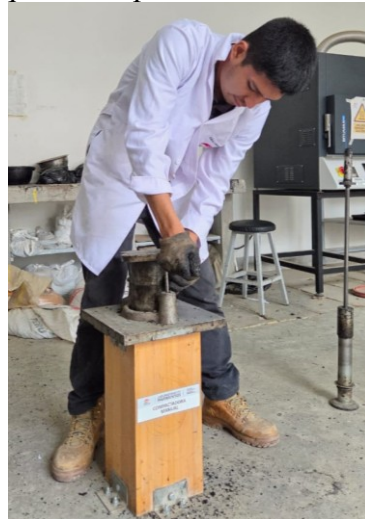
Fig.27. Retiro de briqueta compactada del martillo compactador.
