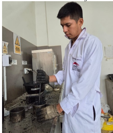
Fig.25. Chuseado de la mezcla asfáltica en briqueta.
