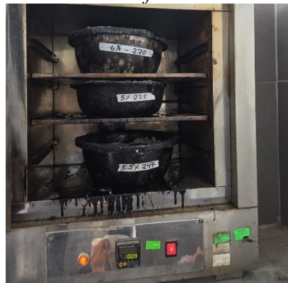
Fig.22. Cemento asfáltico en el horno.
