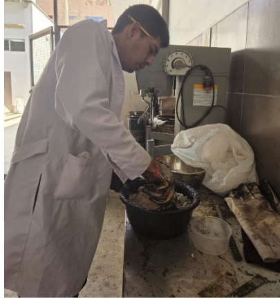
Fig.23. Mezcla de agregados y filer con cemento asfáltico.
