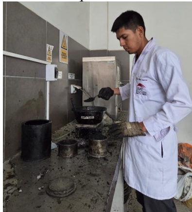
Fig.24. Llenado de la briqueta con el material mezclado.
