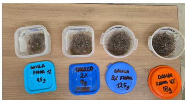
Fig. 37. Fibra de acero por porcentaje establecido.
