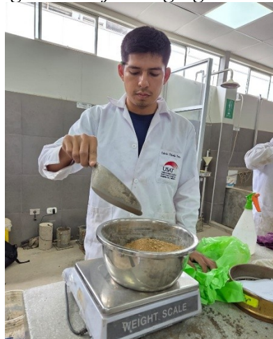
Fig.21. Pesaje de agregados.
