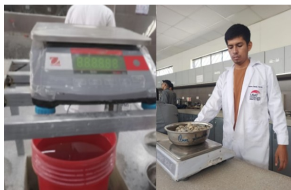
Fig.8. Peso de agregado grueso de peso específico.
