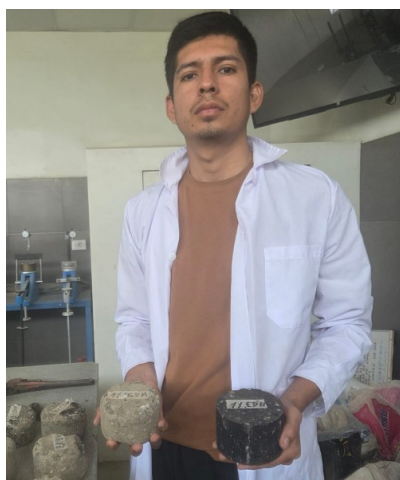
Fig.32. Cantabro, muestra ensayada y sin ensayar.
