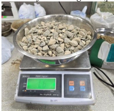
Fig.19. Ensayo de durabilidad de sulfato de magnesio (peso de material disgregado).
