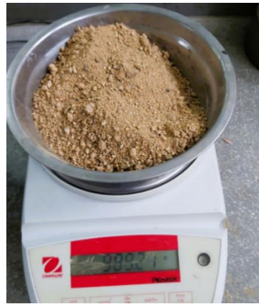
Fig. 6. Cálculo de peso de material retenido en tamices para el agregado fino
