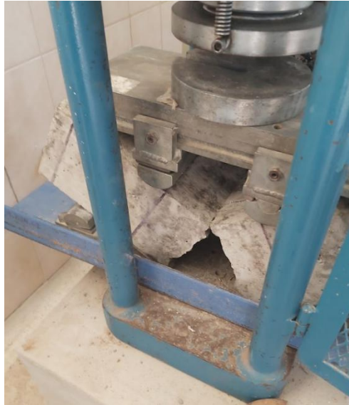
Fig. 19. Rotura de vigueta de concreto en ensayo de flexión
