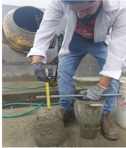
Fig. 16. Medida de asentamiento del concreto fresco
