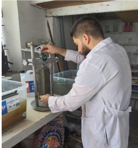
Fig. 20. Aplicación de ensayo de durabilidad por ataque de sulfatos
