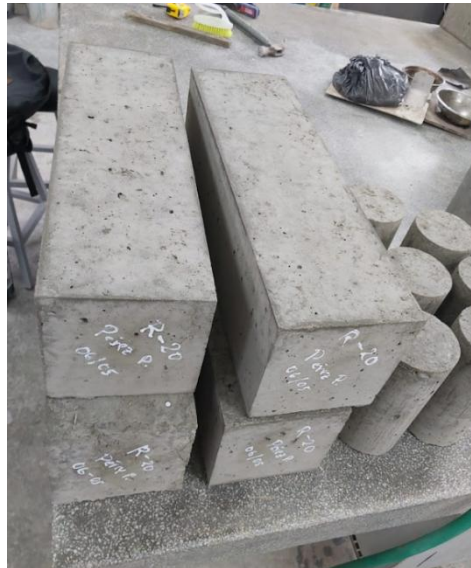
Fig. 15. Viguetas de concreto después de su proceso de curado
