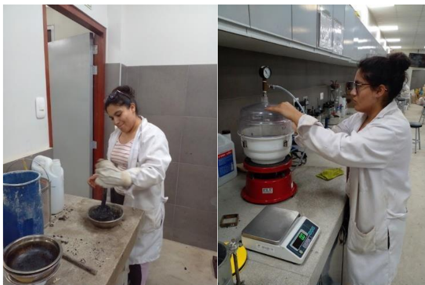
Imagen N°41: Preparación de briquetas para el peso específico máximo Raice
