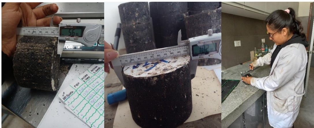
Imagen N°36: Diámetro, altura y peso de briqueta
