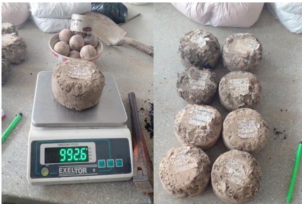
Imagen N°51: Pesaje de briqueta después de 300 vueltas
