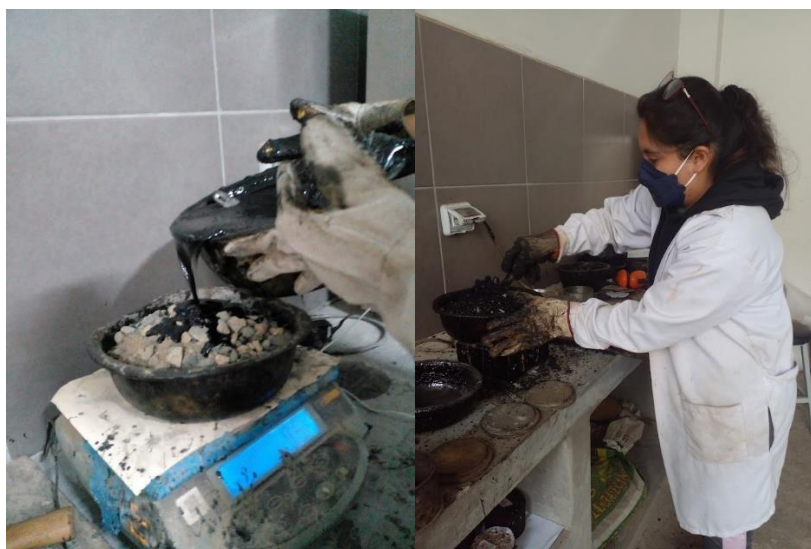
Imagen N°31: Mezcla de briqueta (Arena, piedra, CA, filler)
