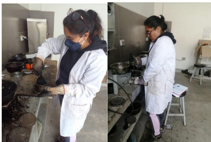
Imagen N°32: Llenado de la mezcla en los moldes
