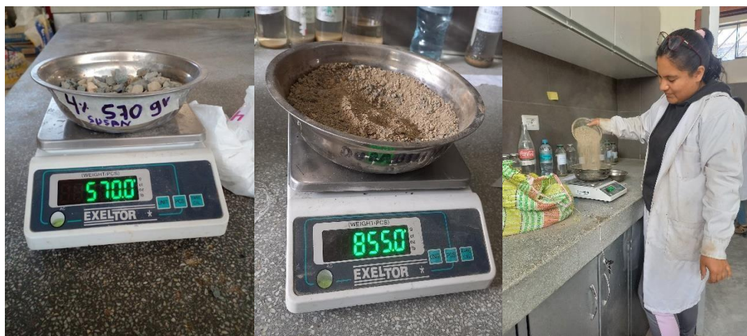
Imagen N°25: Medición del peso de los agregados
