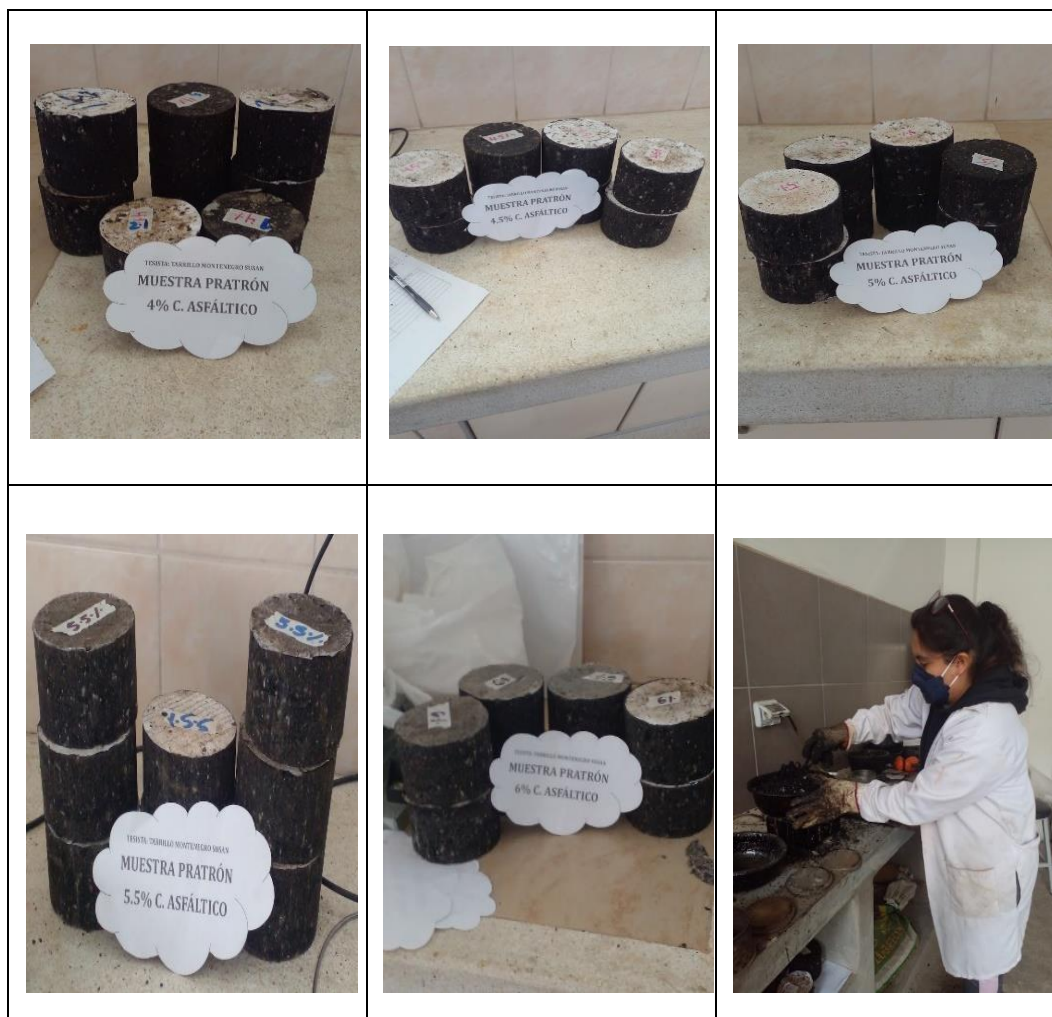
Imagen N°40: Briquetas del diseño de muestra patrón para hallar el óptimo contenido de cemento asfáltico en diferentes porcentajes
