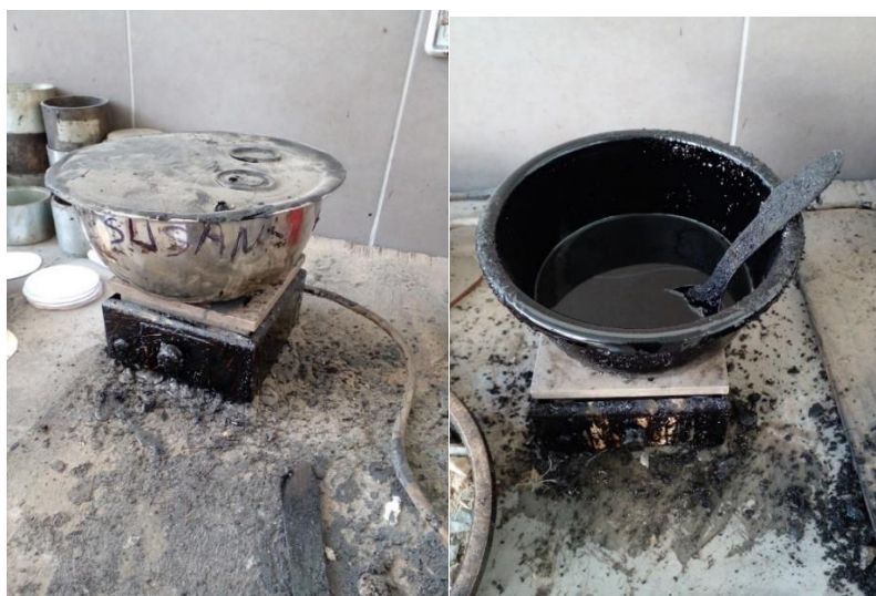
Imagen N°30: Calentado del cemento asfáltico
