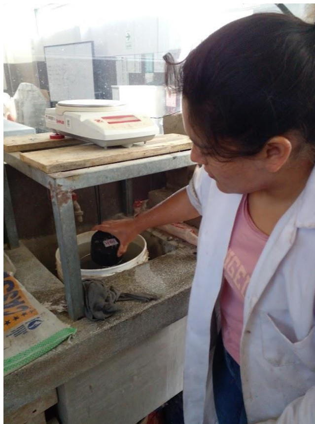
11.1.12 Peso de briqueta sumergida en agua
