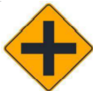
Imagen N°74: Señal cruce de vías a nivel (P-6) (Ver anexo 9.6)
